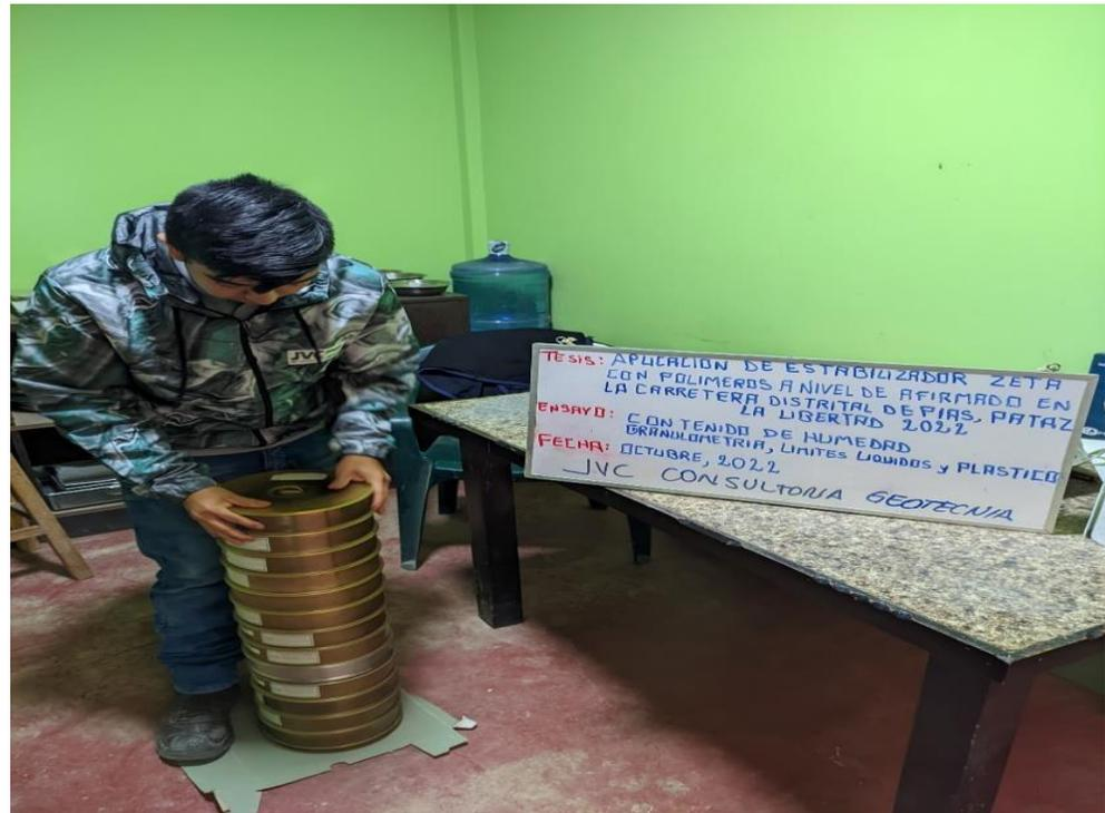
**Figura 14:** *probetas para el ensayo de proctor modificado*
