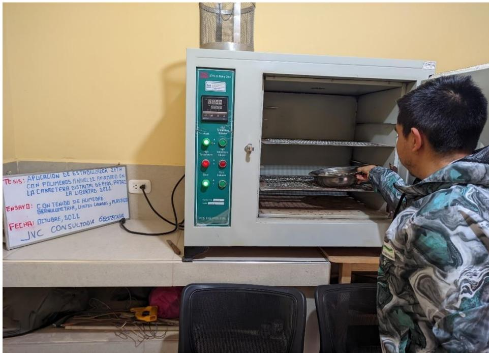
Figura 11: muestra puesta al horno para ser secado
