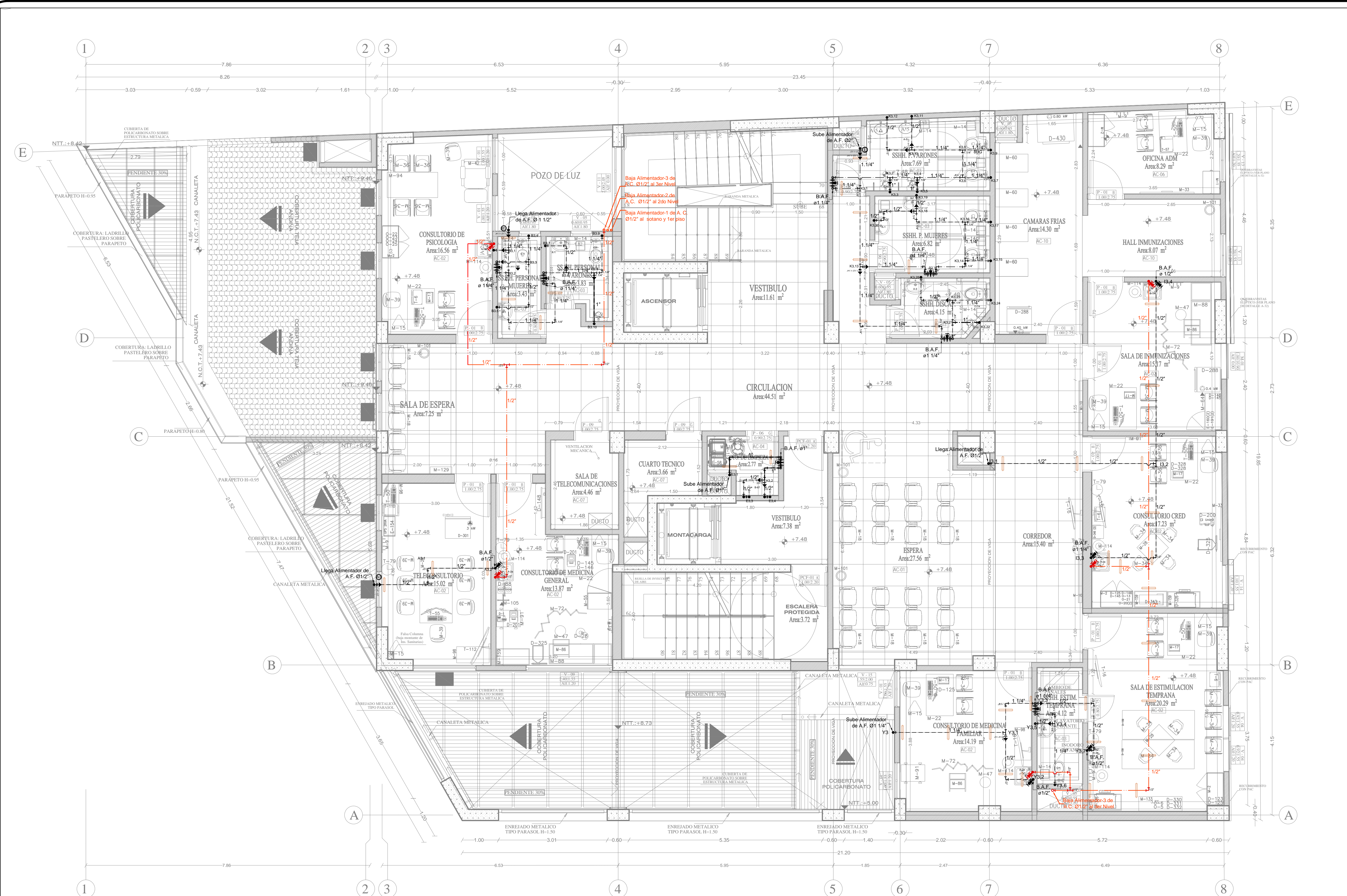
PLANO DE DISTRIBUCION TERCER NIVEL INSTALACION DE AGUA FRIA Y CALIENTE - PLANTA GENERAL 3° NIVEL ESC.: 1/50
