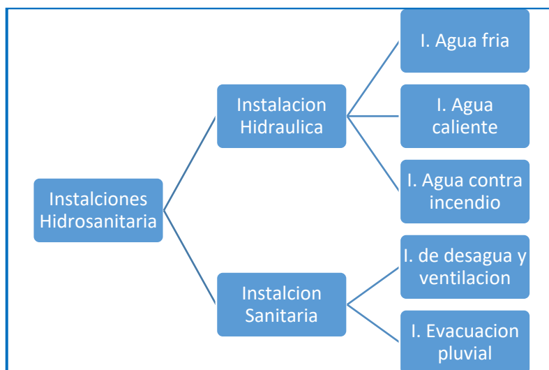
Figura 1. Flujograma instalación sanitaria
