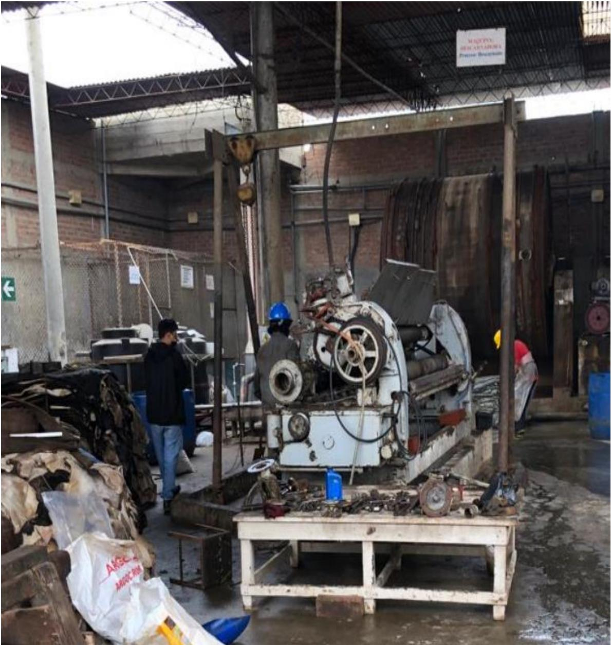
Figura 25: Desmontado de máquina descarnadora
