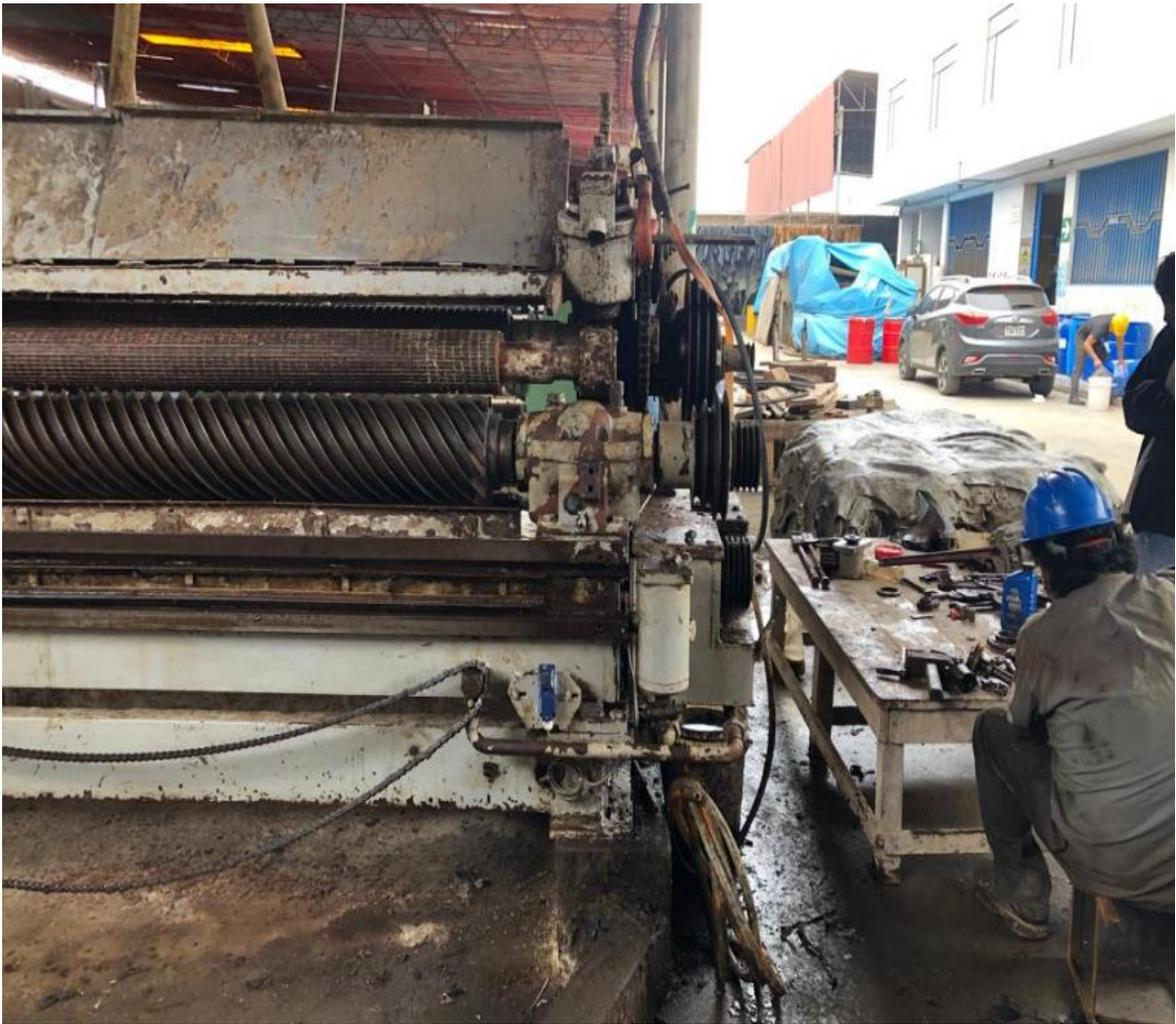
Figura 24: Desmontado de máquina descarnadora
