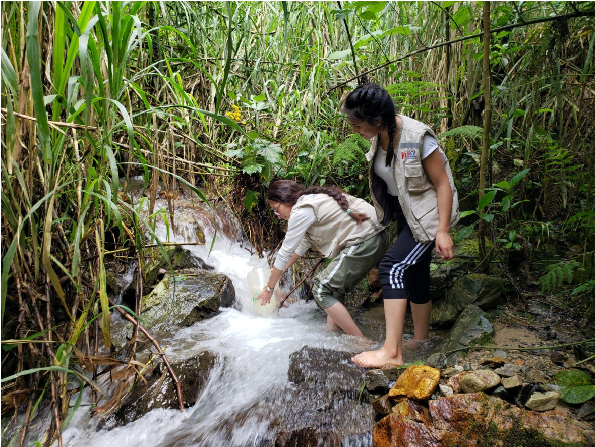
Figura 1. Aforo del agua por el método volumétrico – quebrada Huayacan.
