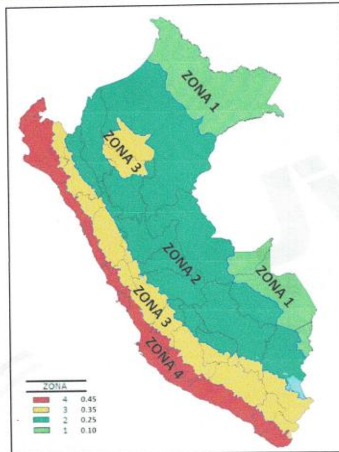
Figura 1. Mapa de Zonificación Sísmica del Perú, según el Reglamento Nacional de Edificaciones.
