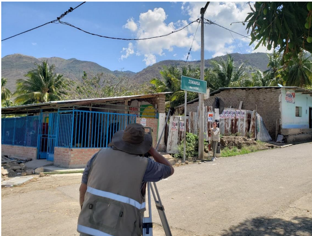
Figura 4. Toma de puntos topográficos - caserío Puente Zonanga
