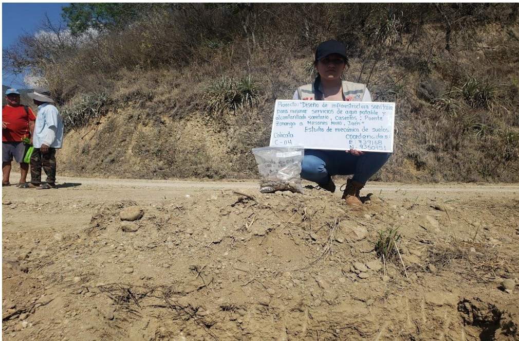
Figura 4. Calicata N°04- tramo conducción
