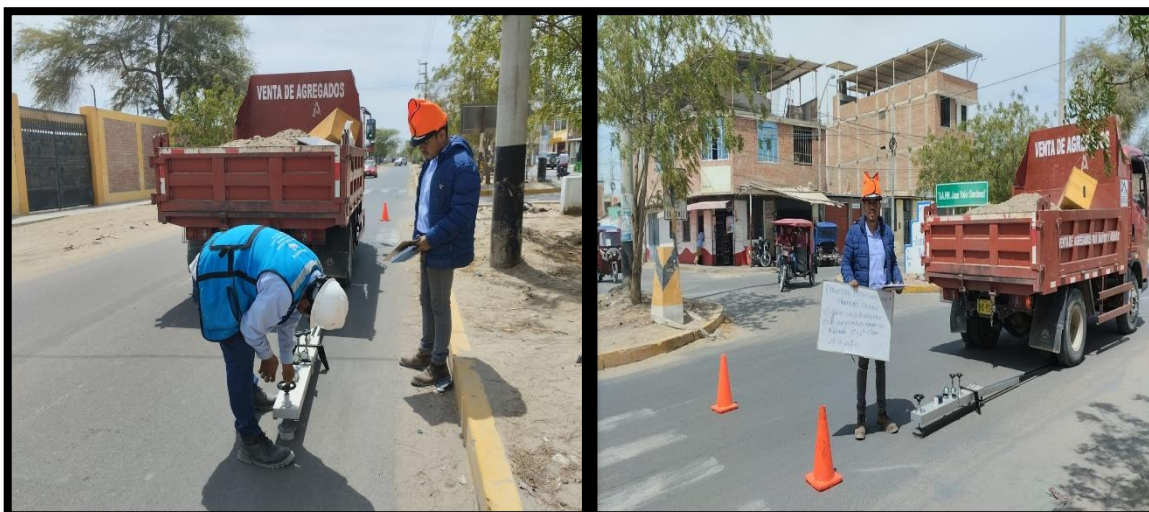
FIGURA 6. Equipo de Benkelman en proceso de evaluación de pavimento.
