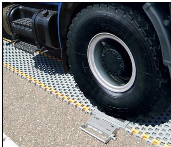
Figura 38. Pesaje de Eje Elaboración: Fuente Propia
