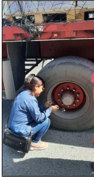
Figura 42. Presión de inflado de los neumáticos de un Eje Súper Simple
