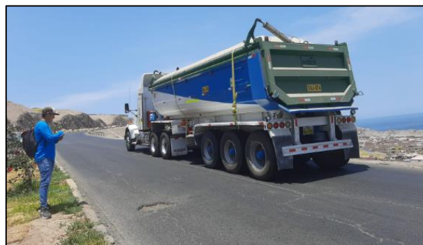
Figura 40. Vehículo T3S3 con configuración súper simple
