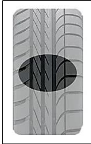
Figura 24. Radio de Contacto de Neumático
