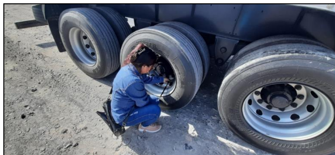
Figura 41. Presión de inflado de los neumáticos de un eje Tridem Convencional
