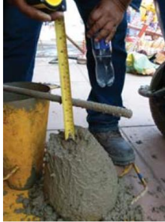
Figura 3 Medición de revenimiento
