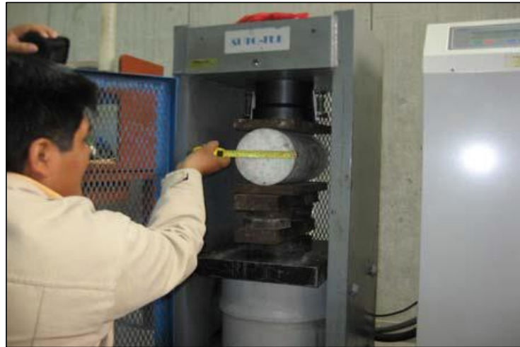
Figura 7. Ensayo a tracción indirecta
