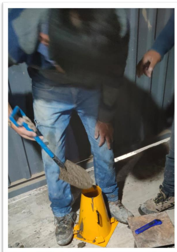
Fotografía 13: ensayo de asentamiento - slump
