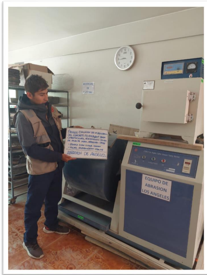
Fotografía 20: ensayo de abrasión los ángeles
