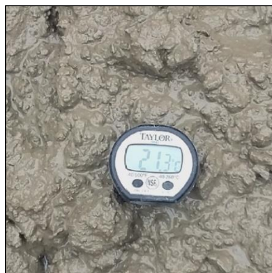
Figura 9. Medición de temperatura del concreto en estado fresco
