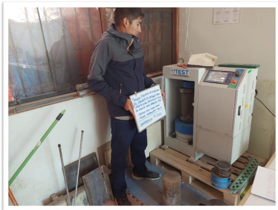
Fotografía 23: ensayo compresión 14 días
