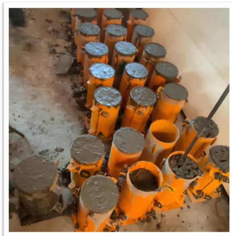
Fotografía 17: elaboración de las probetas de concreto
