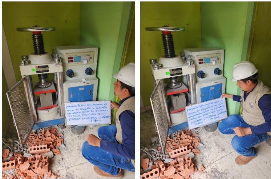
Figura 24: Ensayo de resistencia a compresión de bloquetas de concreto
