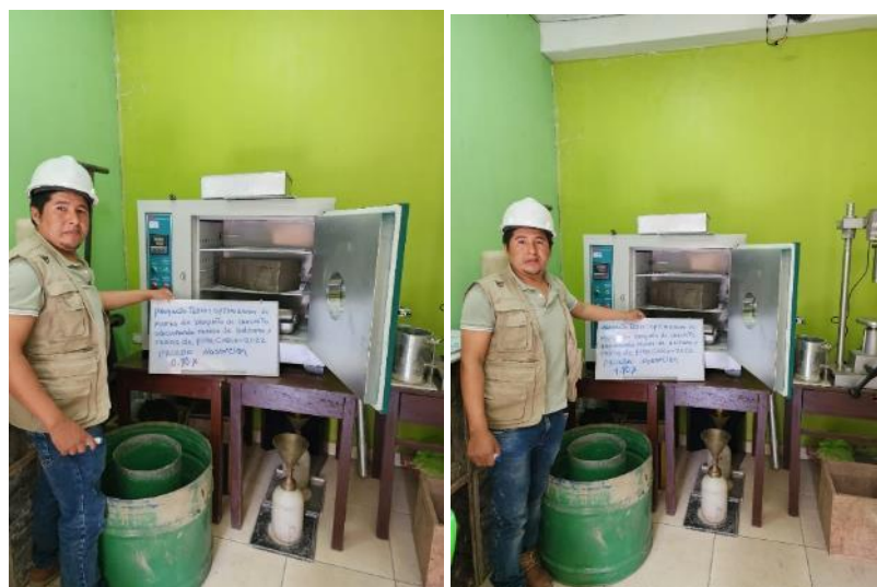
Figura 22: ensayo de absorción -bloquetas de concreto
