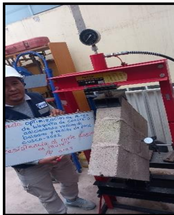
Resistencia a compresión diagonal en muretes
