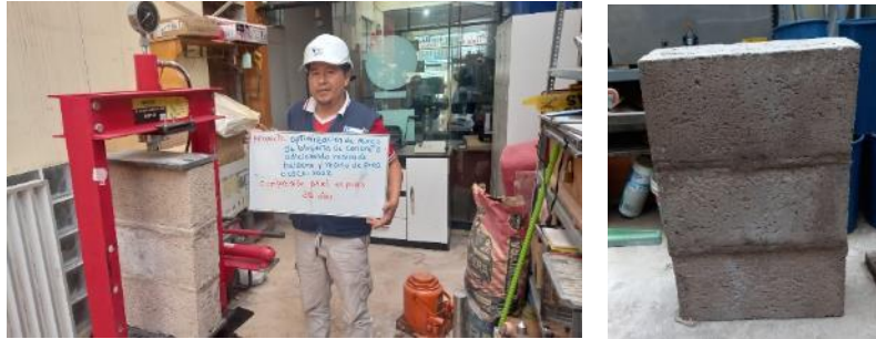
Figura 27: Ensayo de compresión axial en pilas de bloquetas de concreto.
