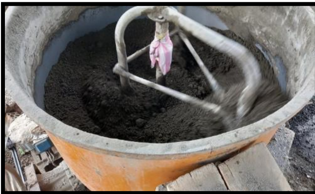
Preparación y fabricación de bloquetas de concreto adicionando resina de bálsamo y resina de pino
