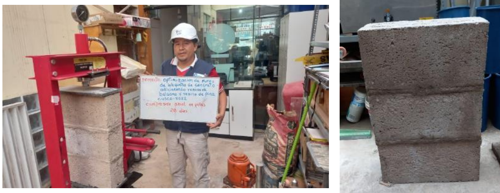
Figura 29: Ensayo de resistencia a la compresión axial en pilas
