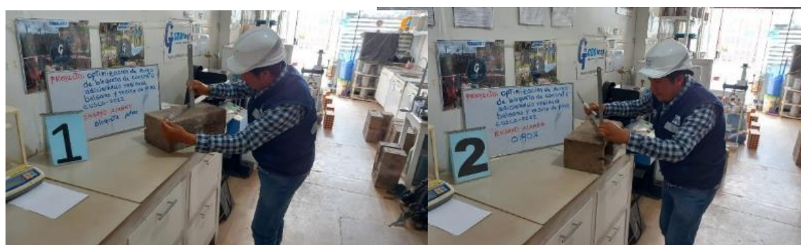
Figura 20: Ensayo de Alabeo de bloquetas de concreto
