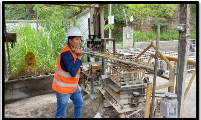
Preparación y fabricación de bloquetas de concreto adicionando resina de bálsamo y resina de pino
