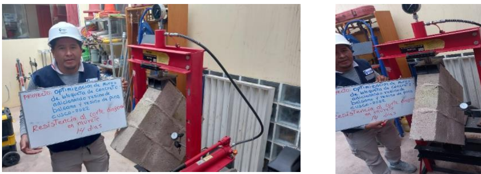
Figura 33: Resistencia a la compresión diagonal en muretes de bloquetas de concreto.
