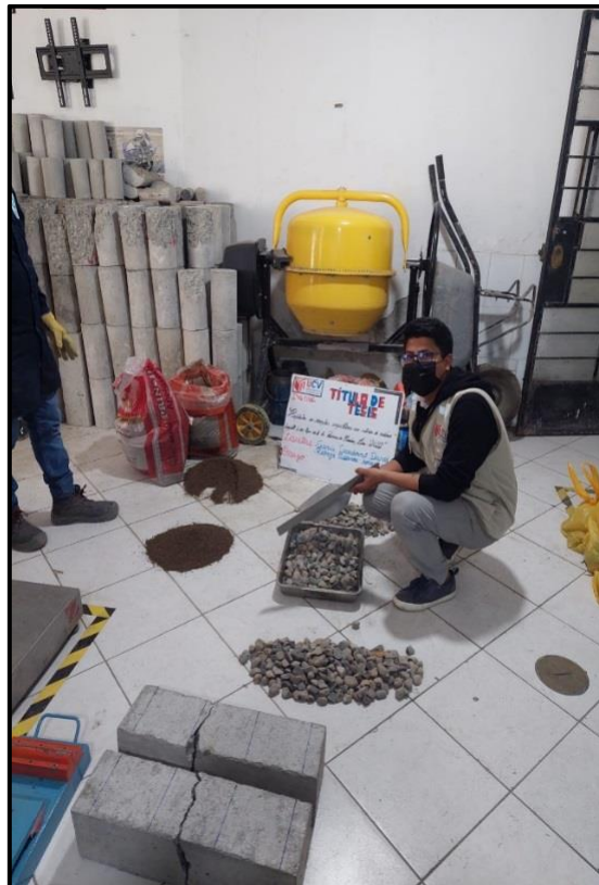
Figura 34. Agregado grueso y fino.
