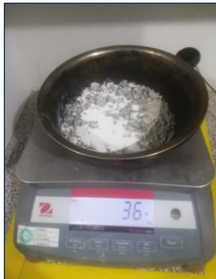
Figura 41. Pesado de agregados pétreos junto con el residuo drywall yeso gyplac RH
