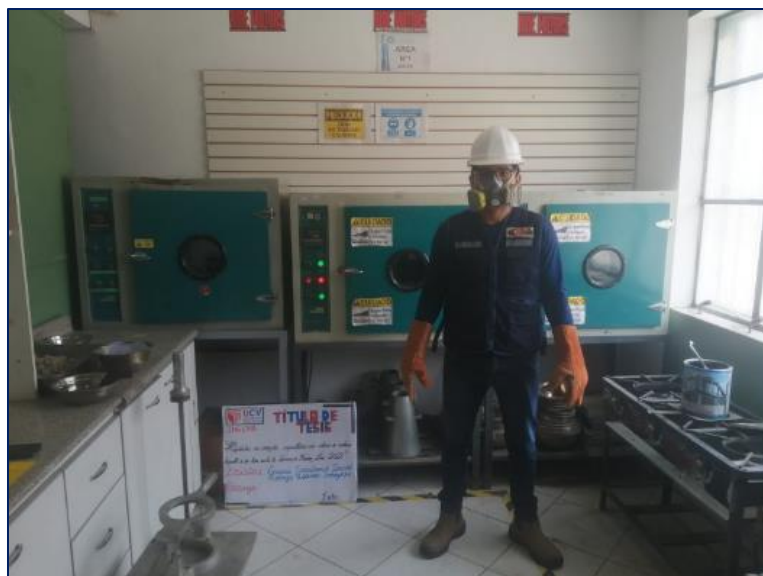
Figura 35. Ensayo de humedad evaporable de agregados por secado
