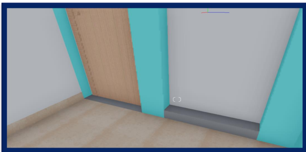
Imagen 30: Desfase de muro y sobrecimiento.
