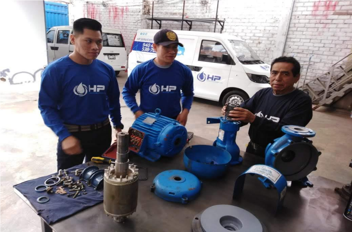
Capacitación de técnico en taller (Electrobomba inactiva – Despiece-Identificación)
