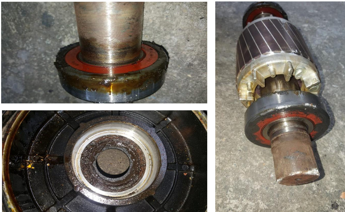
Figura 9. Rodamientos mecánicos con eje de rotor (Desgaste)
