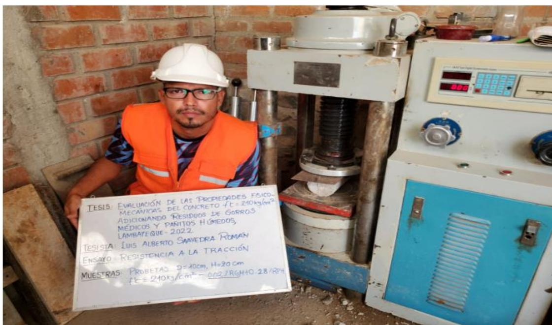
Figura 36. Ensayo de la resistencia a la tracción a 14 días
