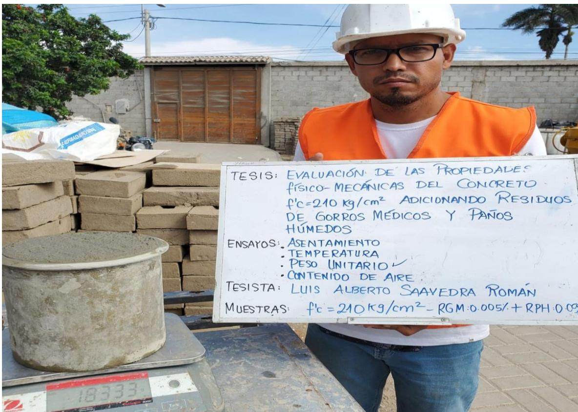
Figura 26. Ensayo de peso unitario
