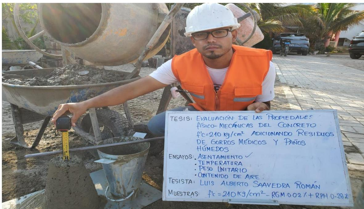
Figura 28. Medición del asentamiento
