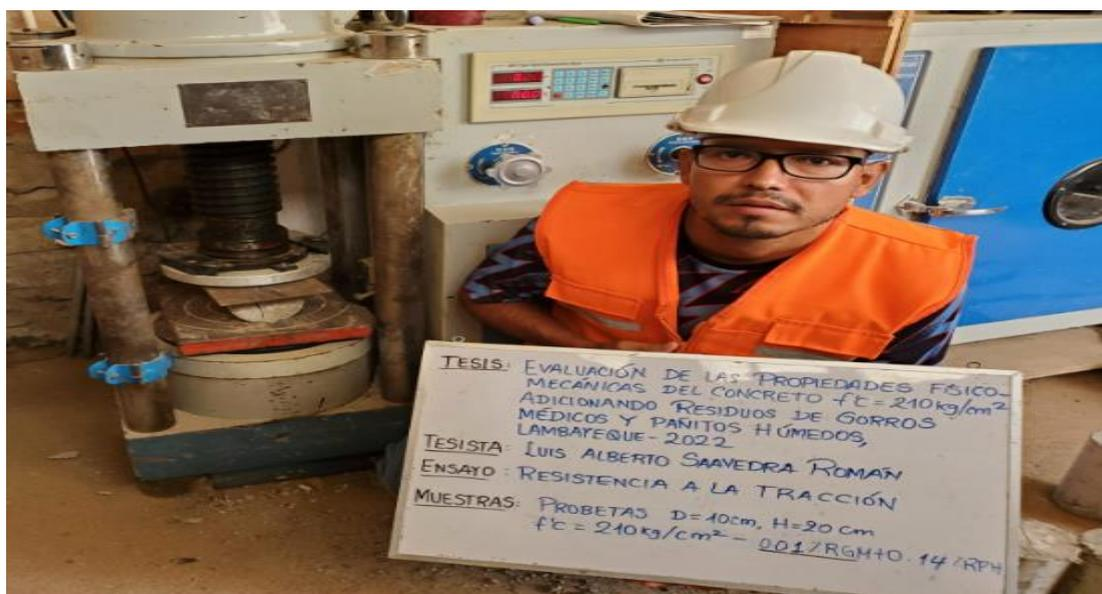
Figura 38. Ensayo de la resistencia a la tracción a 28 días
