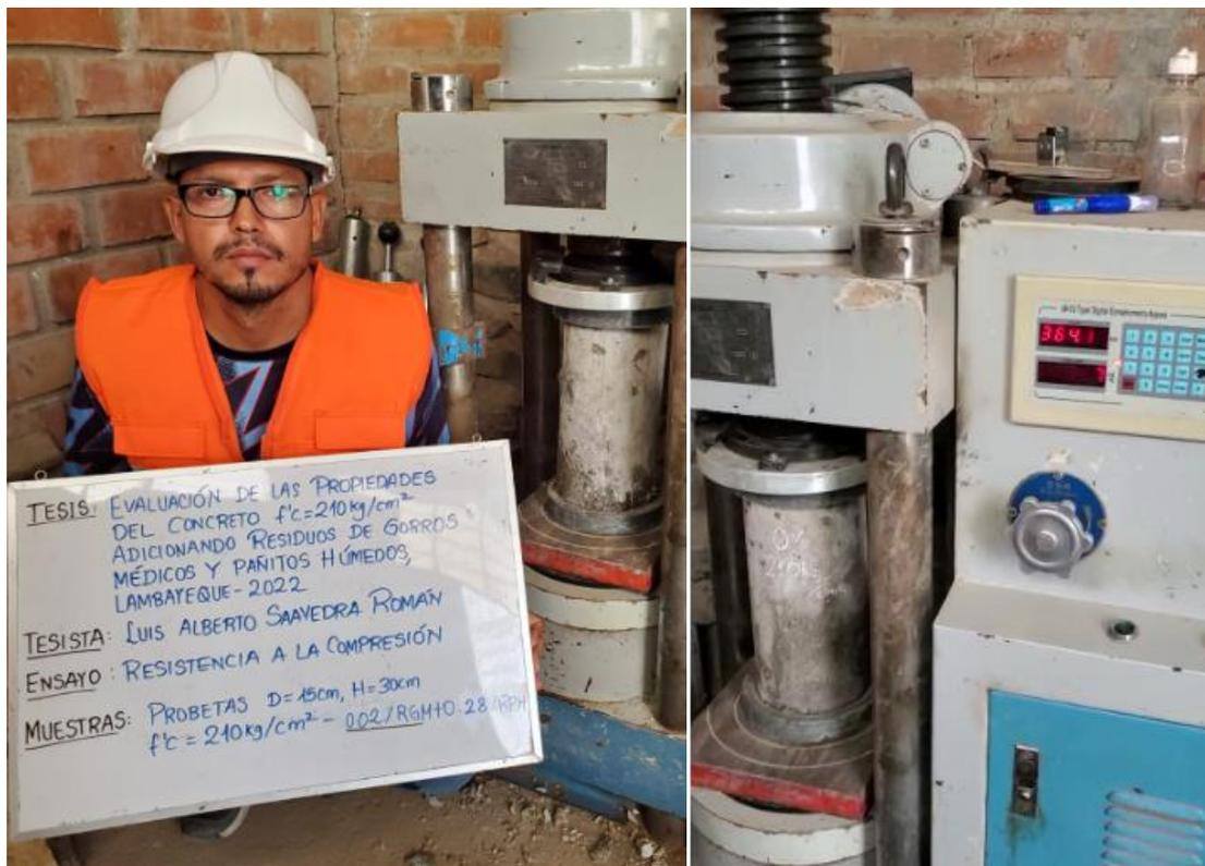
Figura 45. Ensayo de resistencia a compresión a los 28 días
