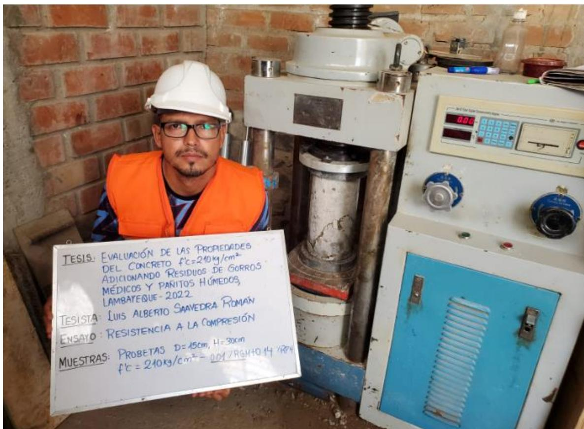
Figura 41. Ensayo de resistencia a compresión a los 7 días
