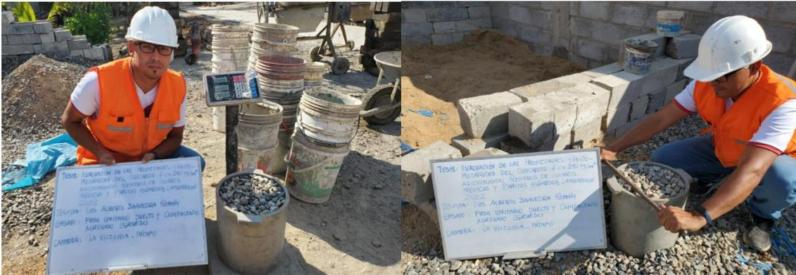
Figura 24. Peso unitario suelto y compactado
