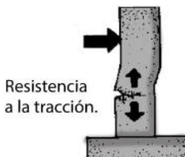
*Figura 4. Resistencia a la tracción.*
