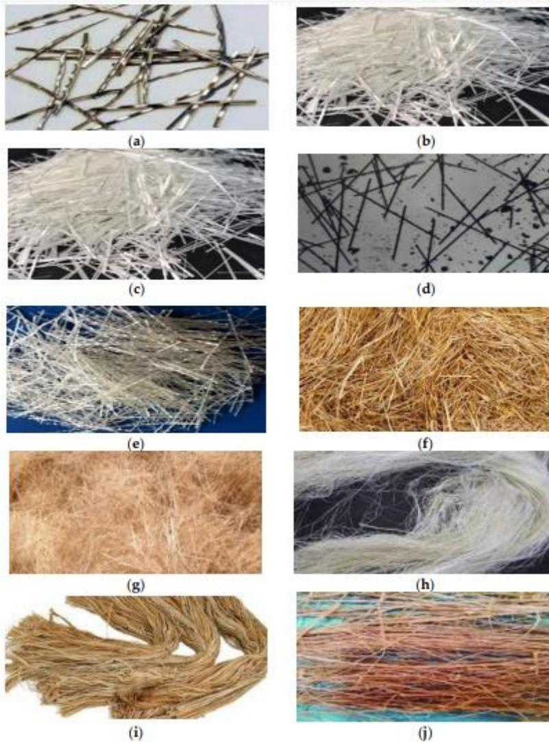
*Figura 10. Fibras utilizadas en el concreto.*
