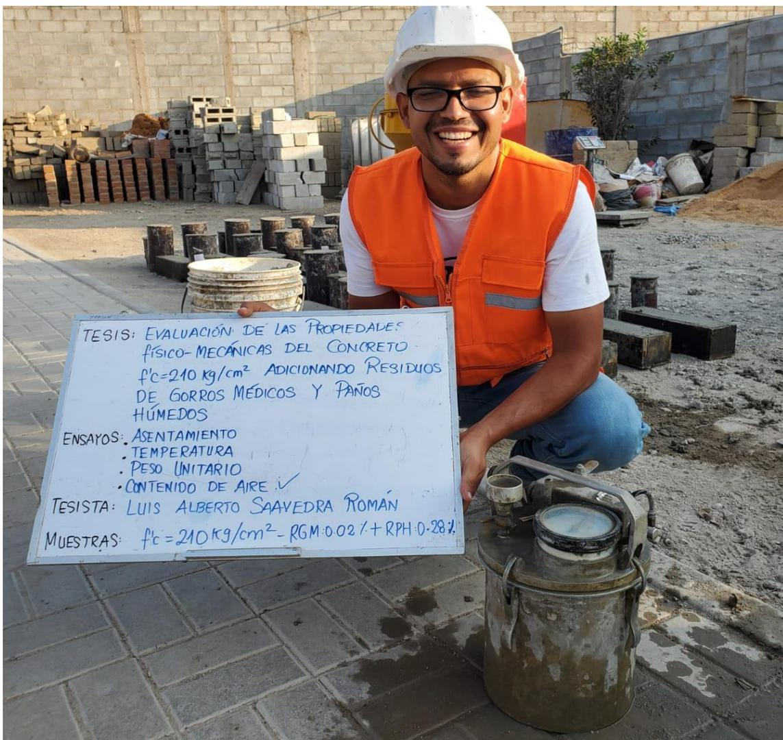
Figura 30. Ensayo del contenido de aire
