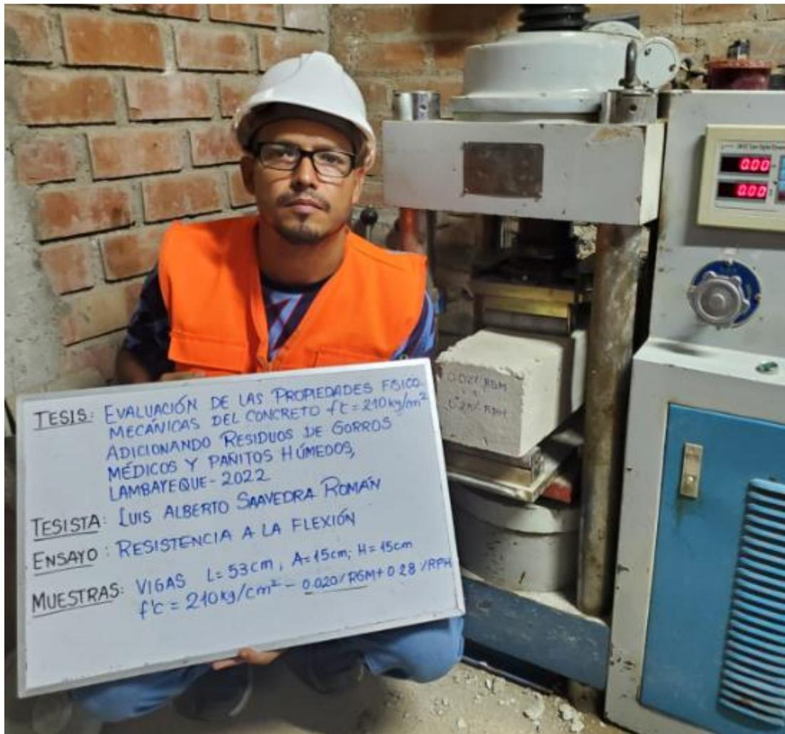
Figura 48. Ensayo de resistencia a la flexión a los 7 días
