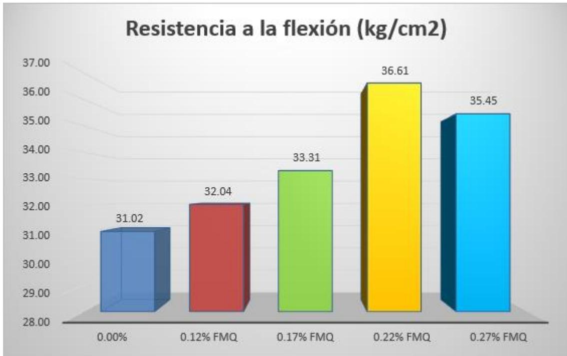
*Figura 73. Dosificaciones óptimas en la resistencia a la flexión a los 28 días (FM)- Dávila y Vigo (2021)*
