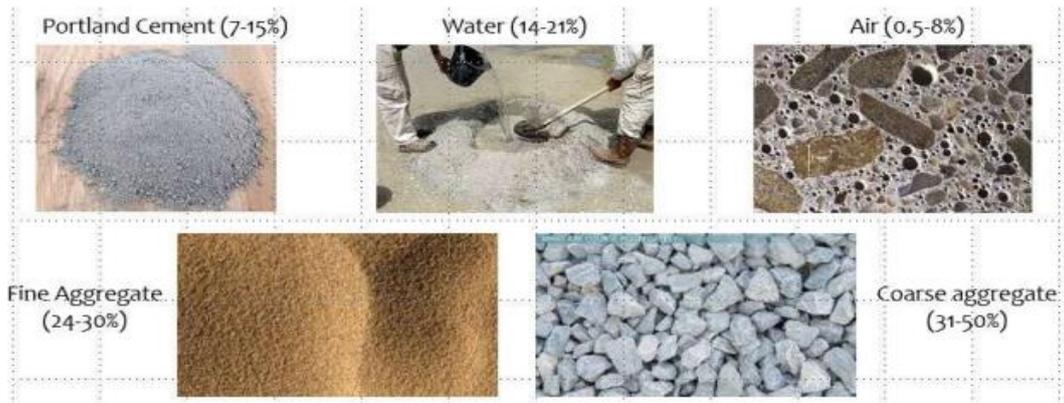
*Figura 1. Componentes del concreto.*
