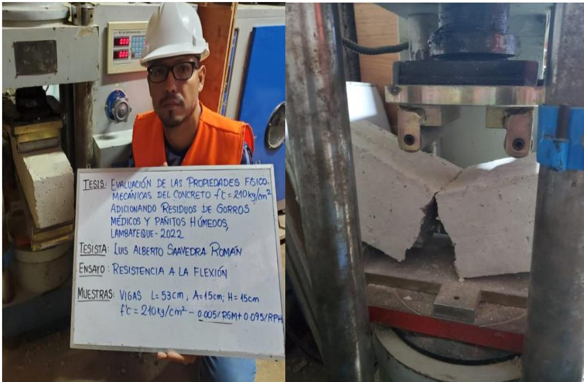
Figura 52. Ensayo de resistencia a la flexión a los 28 días
