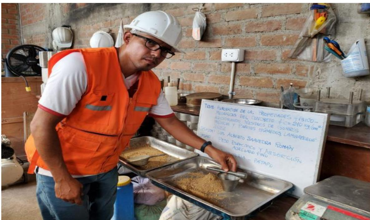
**Figura 25.** Peso específico y abs. de los áridos
