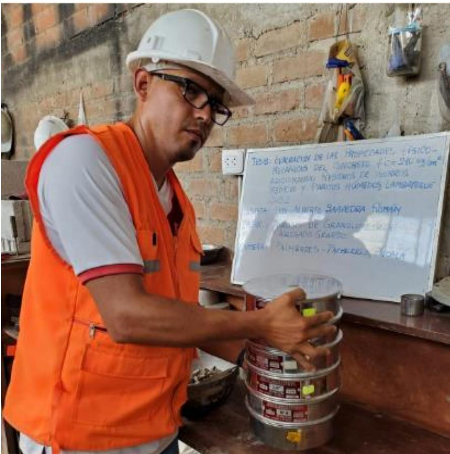
Figura 17. Análisis granulométrico
