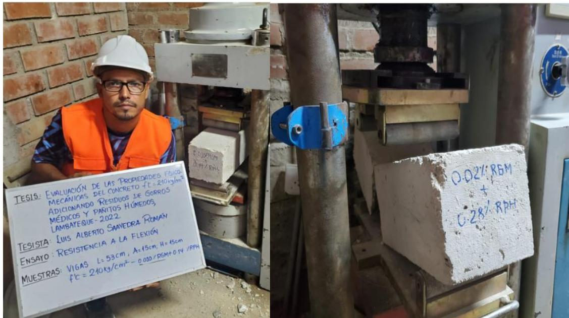
Figura 50. Ensayo de resistencia a la flexión a los 14 días
