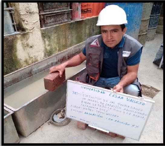
**Ensayo de Absorción Muestra Patrón y con adición 5% de Fibra de Tallo de Pino y de Agave**
