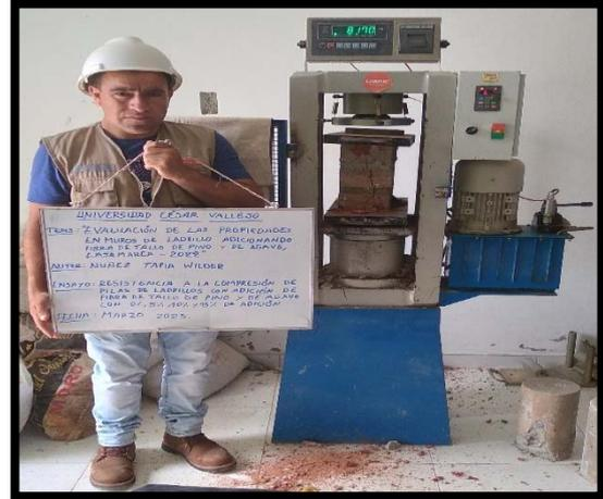
**Ensayo de Resistencia a la compresión de Pilas con adición 5% y 10% de Fibra de Tallo de Pino y de Agave**
