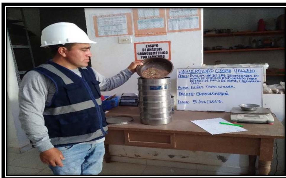
**Figura 15** Ensayo: Granulometría de suelo.
