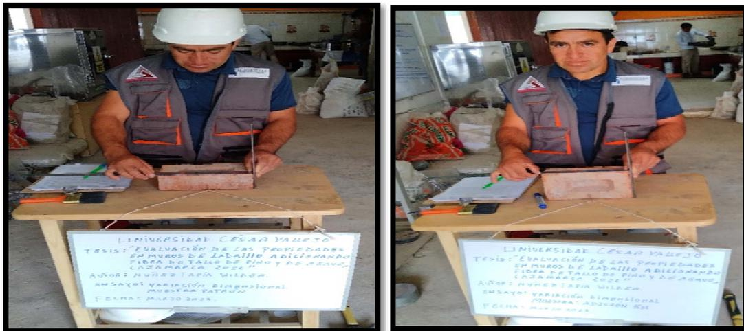
**Ensayo de Variación Dimensional muestra patrón y con adición 5% de Fibra de Tallo de Pino y de Agave**
