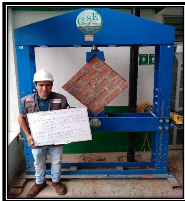
**Figura 29:** Resistencia al corte diagonal
