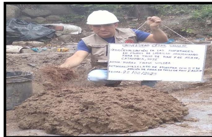
**Mezclado de muestra con 5% de adición de fibra de tallo de pino y de agave**
