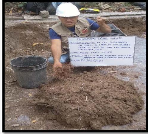
**Mezclado de muestra con 10 Y 15% de adición de fibra de tallo de pino y de agave**
