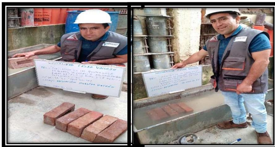
**Figura 23:** Ensayo Absorción en ladrillos de la muestra patrón y adición con 5.00%, 10.00% y 15.00% de FTP y FDA.
