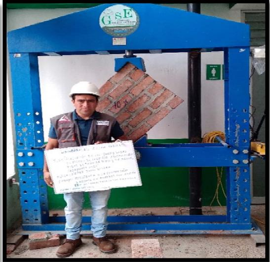
**Ensayo Resistencia a la Compresión Diagonal en Muretes con adición 5% y 10% de Fibra de Tallo de Pino y de Agave**
