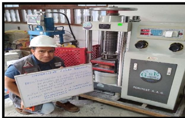
**Ensayo de Resistencia a la compresión con adición 15% de Fibra de Tallo de Pino y de Agave**
