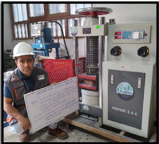
**Ensayo de Resistencia a la compresión Muestra Patrón y con adición 5% de Fibra de Tallo de Pino y de Agave**
