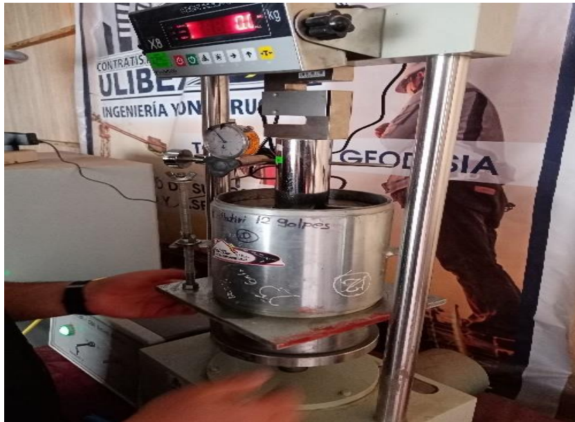
Figura. 21. Aparato aplicador de carga, aplicación de carga progresiva según guía Fuente: Elaboración personal
