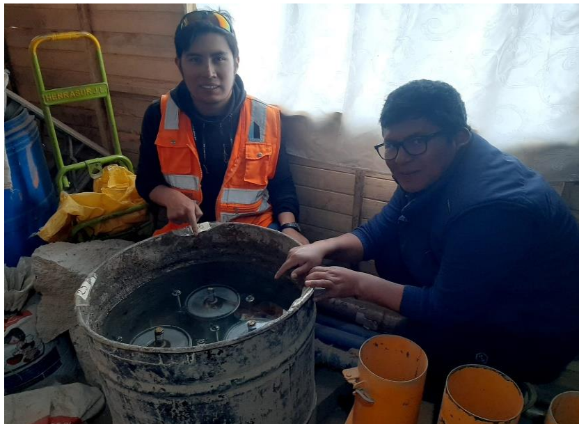
Figura. 20. Saturación de muestras para CBR. Fuente: Elaboración personal
