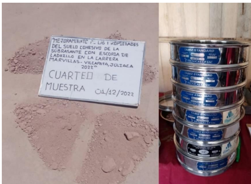
Figura. 16. Cuarteo de muestra y granulometría realizados en laboratorio. Fuente: Elaboración personal.
