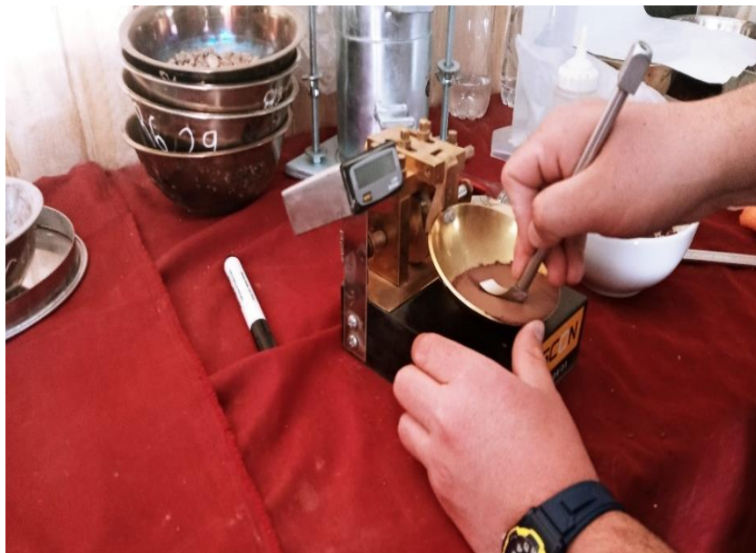
Figura. 17. Desarrollo del ensayo de limite liquido Fuente: Elaboración personal
