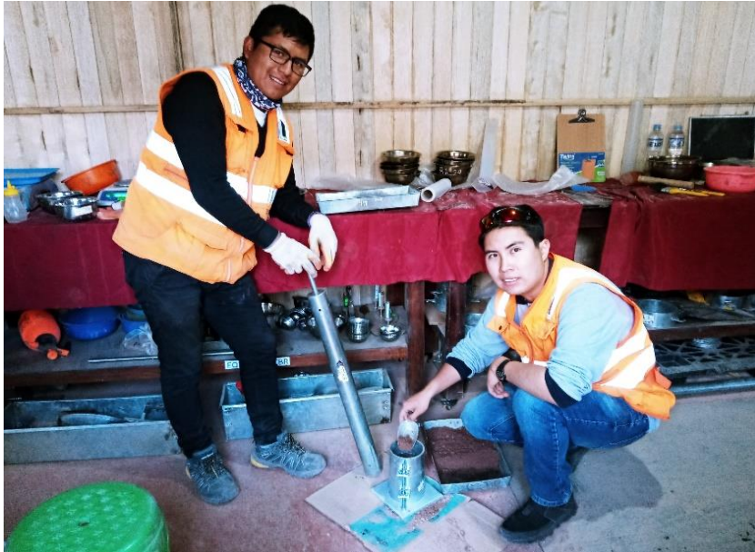
Figura. 19. Molde de Proctor modificado y aplicación de energía de compactación. Fuente: Elaboración personal
