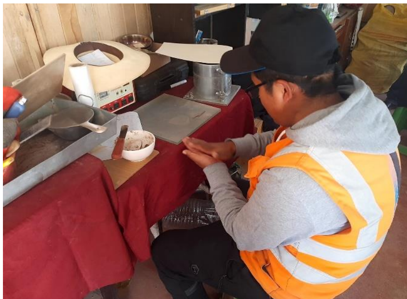
Figura. 18. Desarrollo del ensayo de límites plástico. Fuente: Elaboración personal
