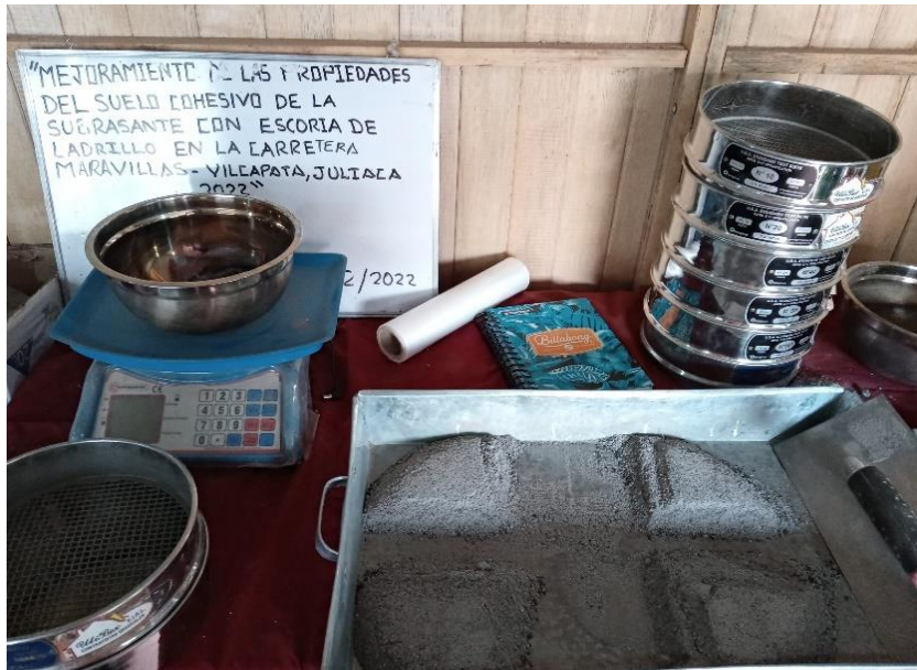
Figura. 22. Ensayo de granulometría aplicado a la Escoria de hornos artesanales. Fuente: Elaboración personal
