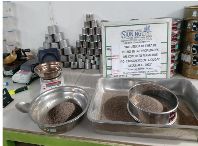
Figura 2. Análisis granulométrico de agregado fino.
