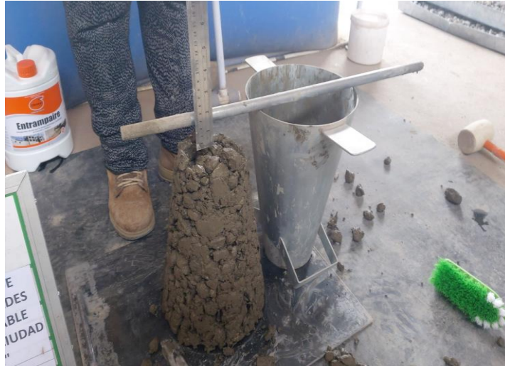
Figura 5. Ensayo de asentamiento
