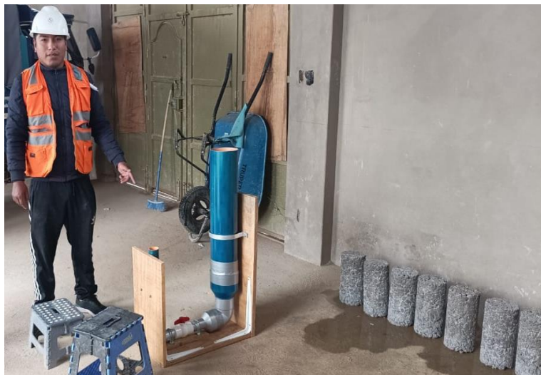
Figura 8. Ensayo de permeabilidad
