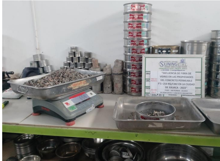
Figura 1. Análisis granulométrico de agregado grueso.
