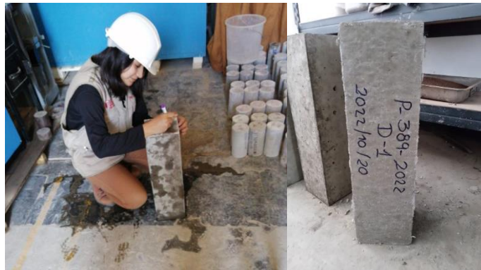
Figura 40. Rotulado de las vigas
