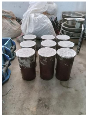
Figura 34. Secado del concreto en las probetas cilíndricas
