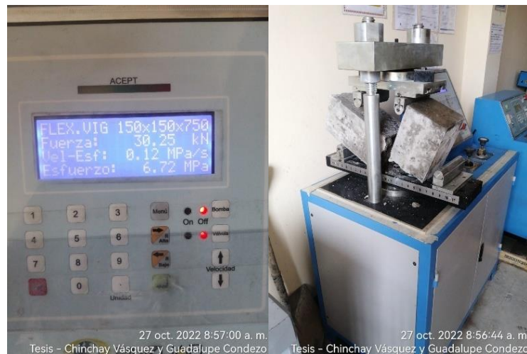
Figura 41. Ensayo de resistencia a flexión a los 7 días
