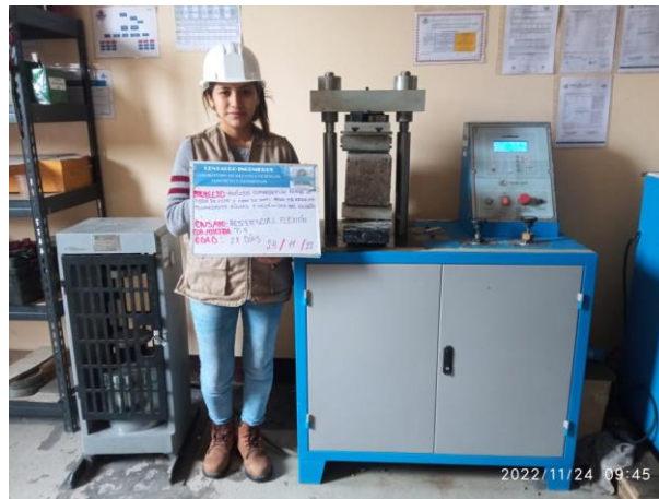
Figura 43. Ensayo de resistencia a flexión a los 28 días
