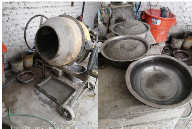
Figura 29. Elaboración de mezcla de concreto
