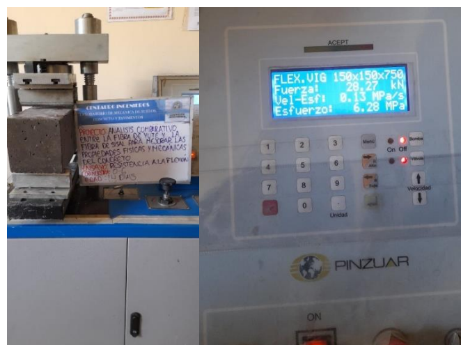
Figura 42. Ensayo de resistencia a flexión a los 14 días
