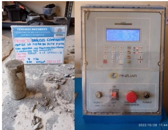
Figura 37. Ensayo de resistencia a compresión a los 7 días
