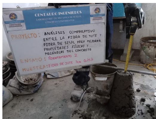
Figura 32. Slump de la mezcla de concreto con 0.25% de yute 3 cm
