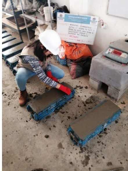
Figura 35. Enrasado de la muestra de concreto en vigas
