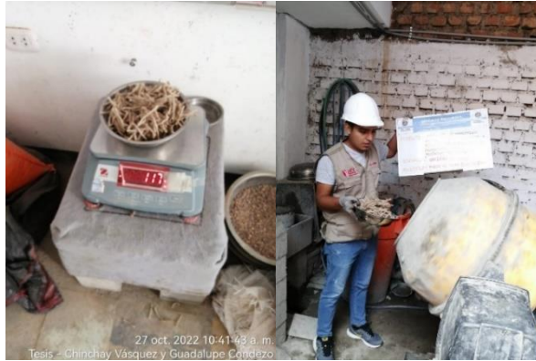
Figura 30. Elaboración de mezcla de concreto con adición de yute
