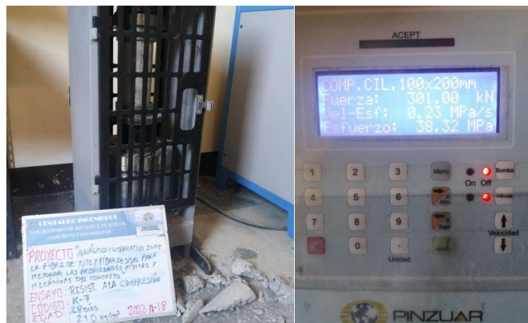
Figura 39. Ensayo de resistencia a compresión a los 28 días
