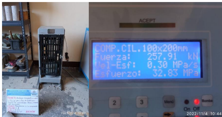
Figura 38. Ensayo de resistencia a compresión a los 14 días
