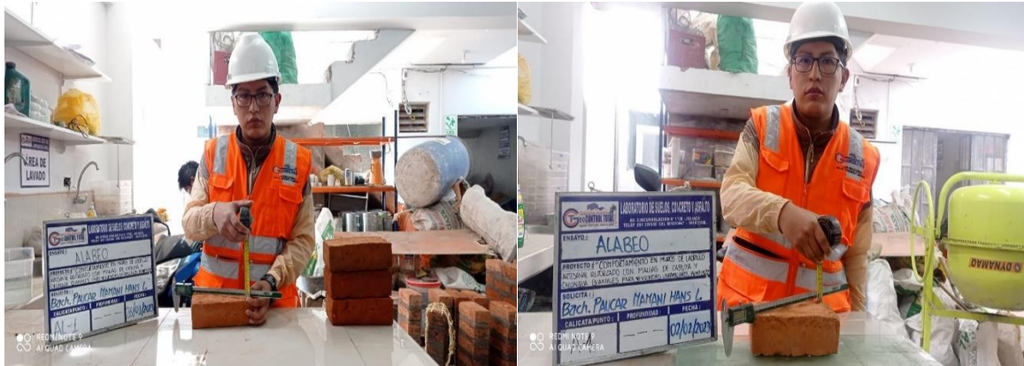
Figura 30: ensayo de alabeo
