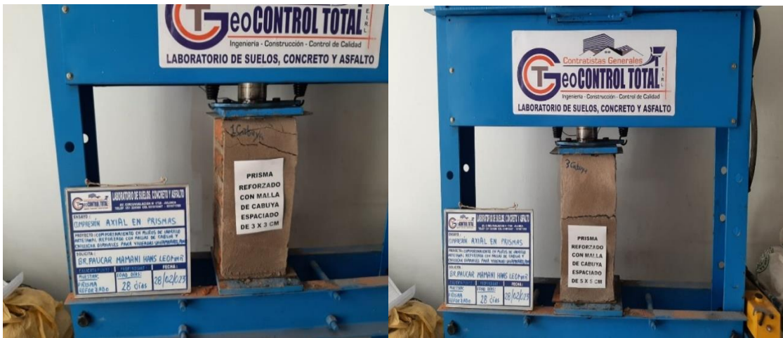
Ensayo a compresión axial en pilas cabuya 3cm y 5cm Fuente: Elaboración propia
