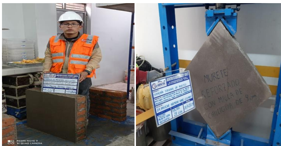
Figura 41: ensayo a compresión diagonal en muretes Fuente: elaboracion propia
