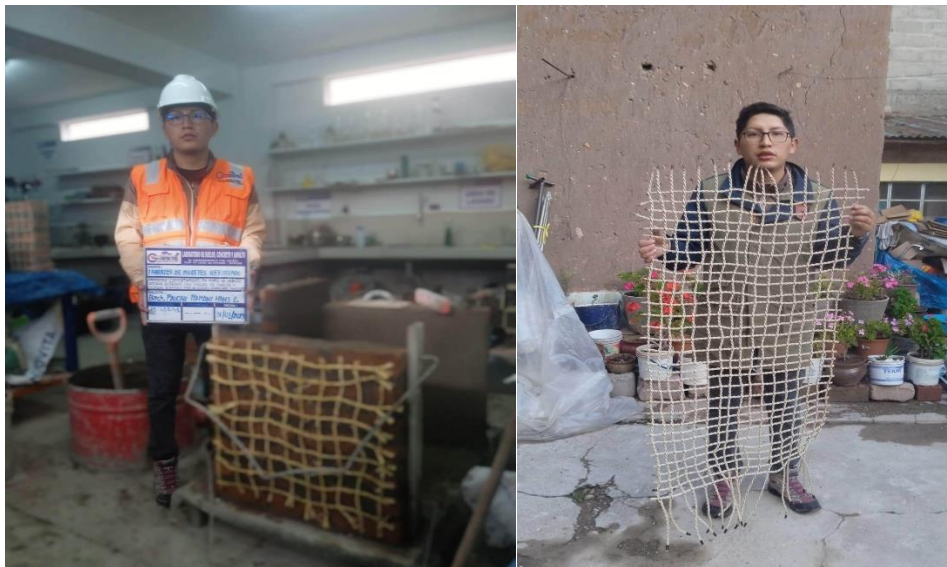
Figura 47: ensayo a compresion diagonal Cabuya-Chilligua Fuente: elaboracion propia
