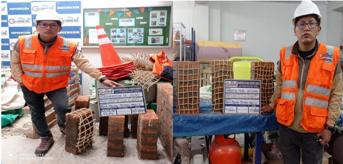
Ensayo a compresión axial en pilas cabuya y chilligua Fuente: Elaboración propia
