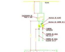
DETALLE N°1 TÍPICO DE CALENTADOR DE PASO A GAS-5.5 L
