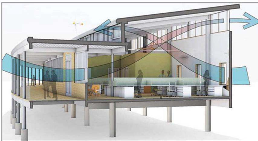
Figura 17: Ventilación natural Fuente: SIBER ventilación inteligente
