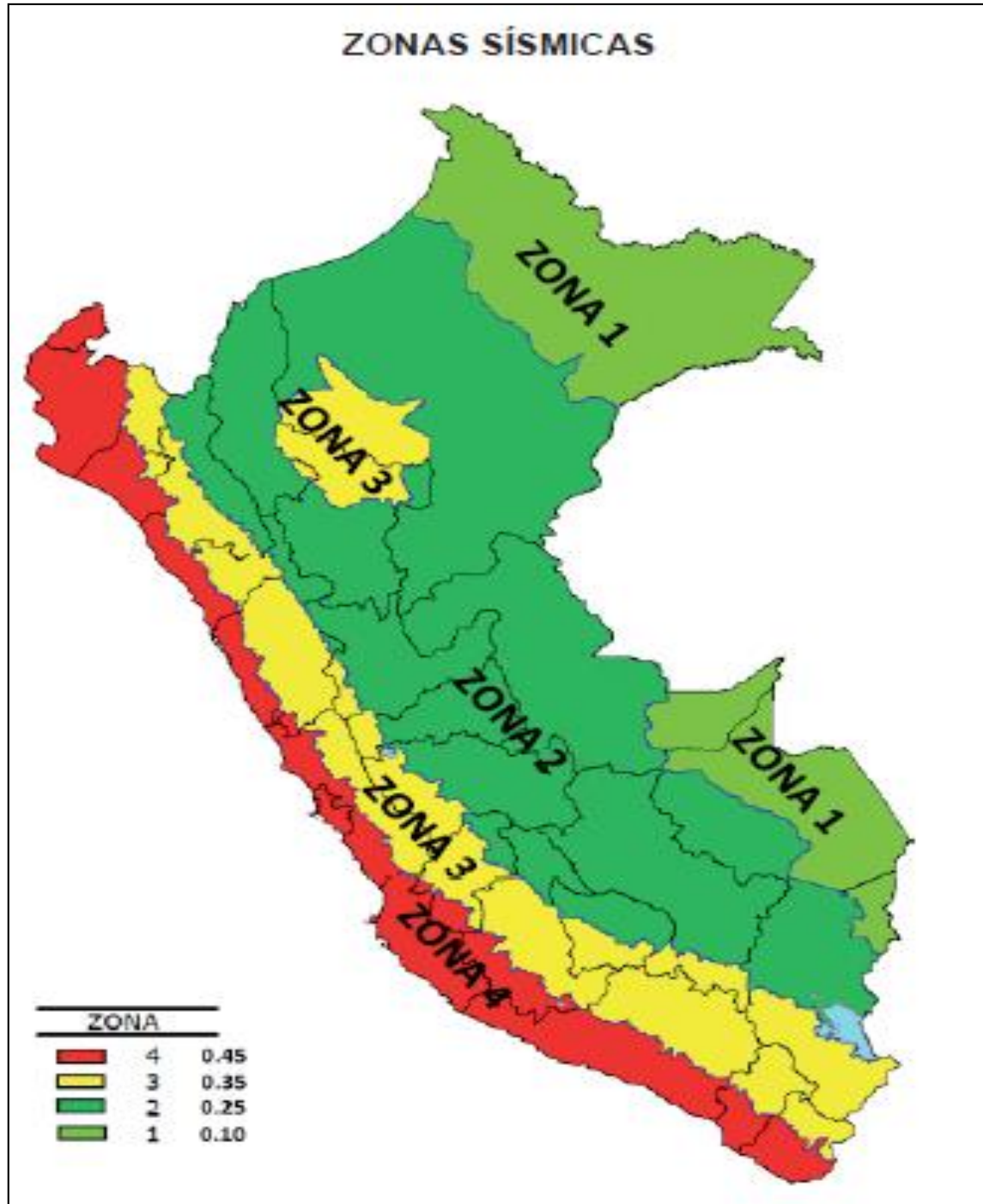
Figura 28. Zona sísmica concreto Fuente: Norma E.030
