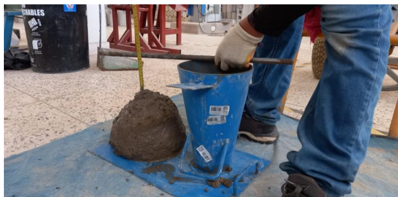
Figura 40. Ensayo de slump
