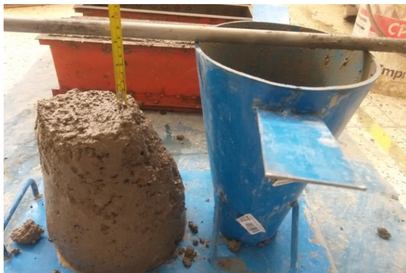
Figura 47. Ensayo de asentamiento
