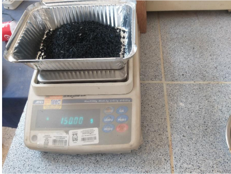
Figura 11. Pesado de 150 g. de caucho.
