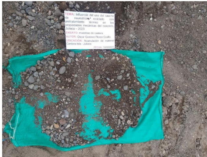
Figura 19. Cuarteo de muestra
