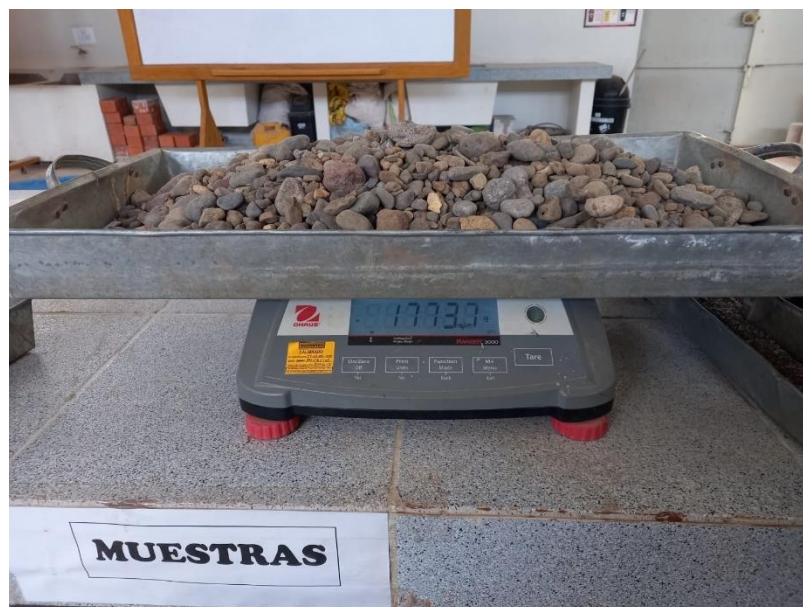
Figura 30. Pesado de agregado grueso
