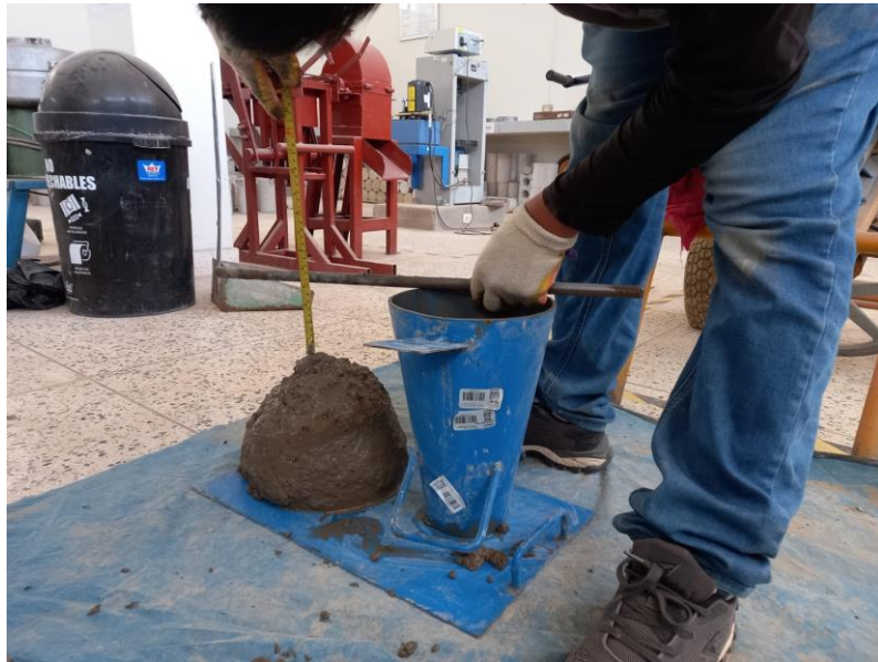
Foto 22. Ensayo de slump
