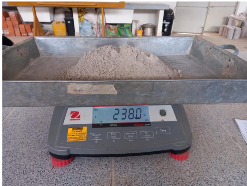
Figura 29. Pesado de cemento
