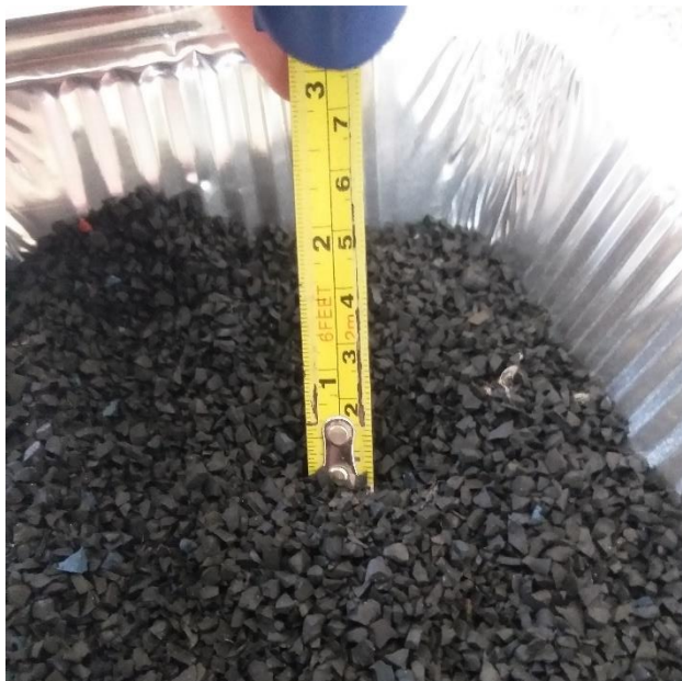
Figura 10. Llenado de caucho en espesor de 10 mm.
