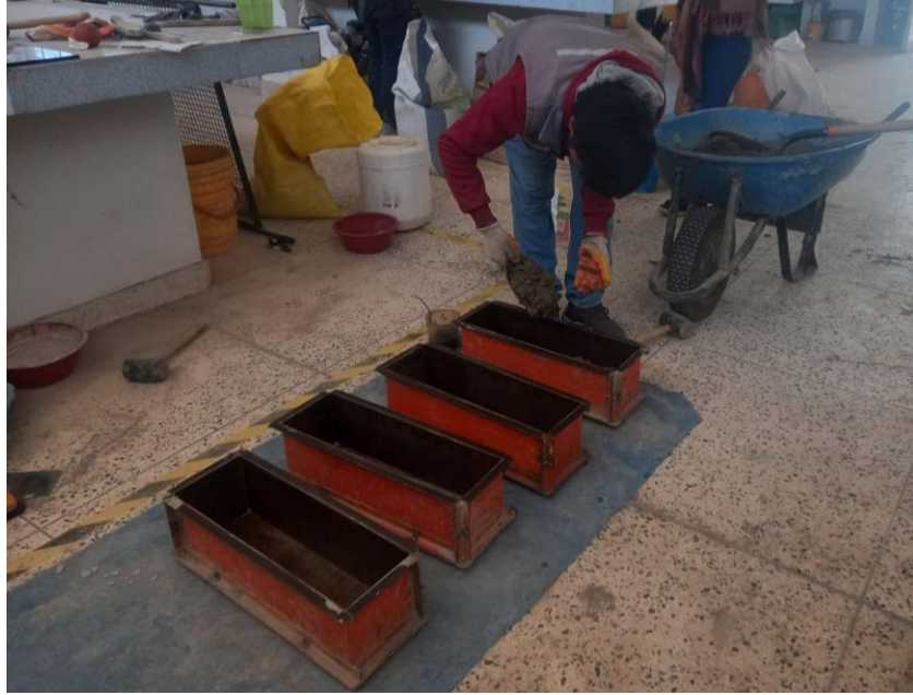
Foto 26. Elaboración de muestras para flexión
