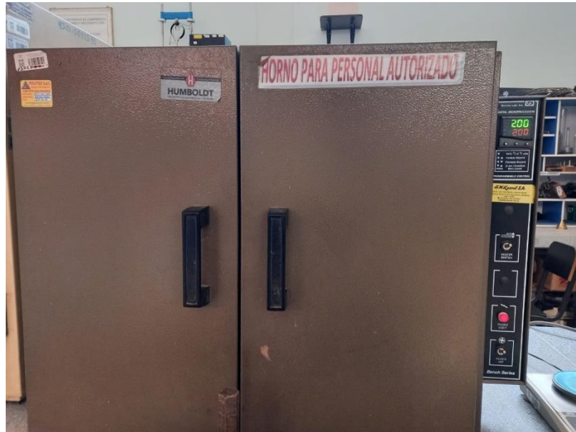
Figura 13. Tratamiento de caucho a temperatura de 200 °C.
