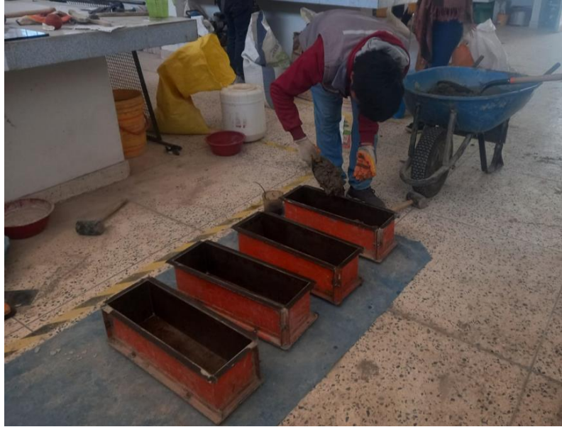
Figura 48. Elaboración de muestras para flexión
