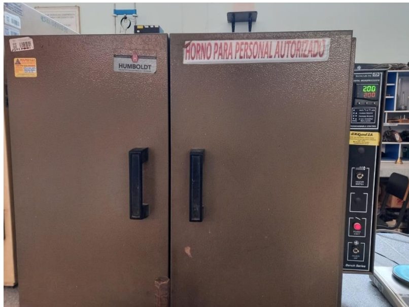
Foto 6. Tratamiento de caucho a temperatura de 200 °C.
