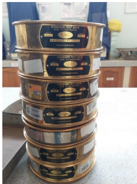
Figura 23. Tamices para agregado grueso Fuente: Elaboración propio
