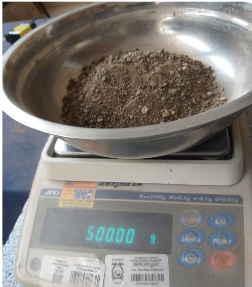
Figura 21. Pesado del agregado fino.
