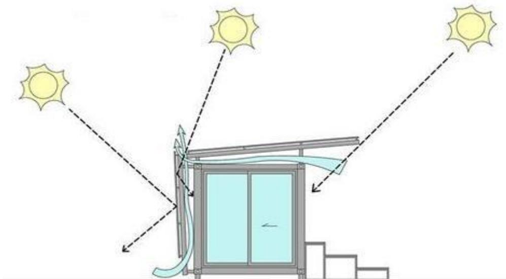
Nota: el recubrimiento que se le dará el contenedor debe generar ventilación y a su vez cubrir de la incidencia solar
