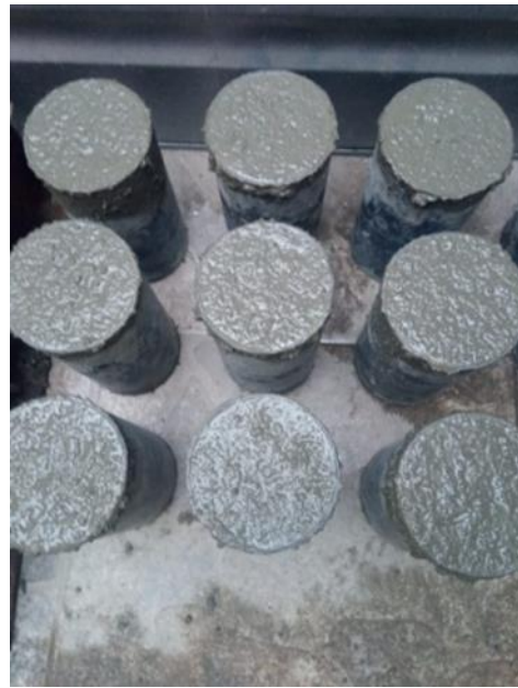
Fraguado de las probetas de concreto
