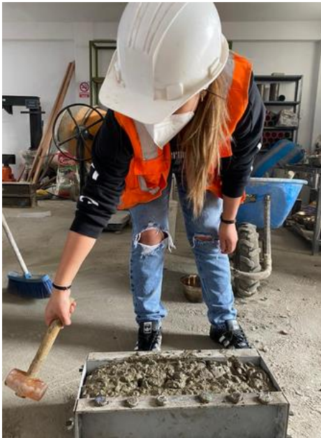
Elaboración de vigas de concreto
