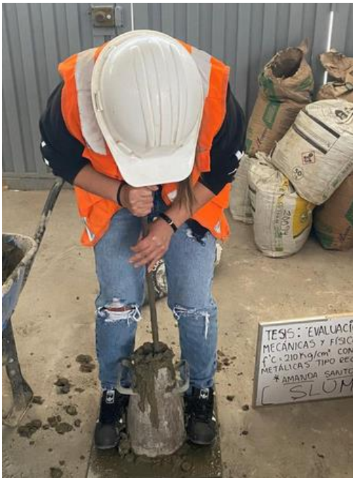
Ensayo de consistencia del concreto – Slump
