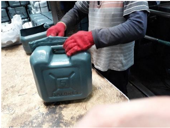
Figura 13. Rebaba y colocación de tapas
