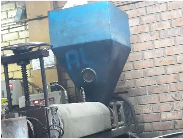
Figura 11. Tolva de la máquina inyectora-sopladora
