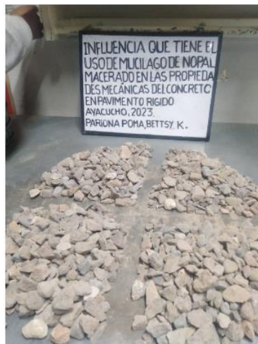
Imagen 18: vista del cuarteo de piedra chancada.
