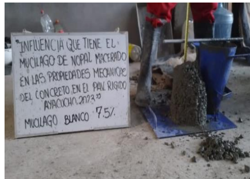
Imagen 76: Slump de concreto patrón+mucilago
