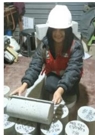
Imagen 44: medición de testigo.
