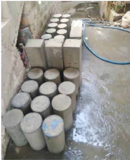
Imagen 40: vista de las muestras para la rotura a compresión, flexión y tracción.
