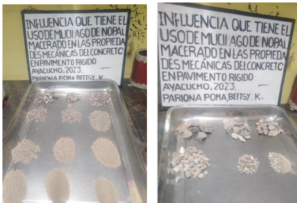
Figura 20. Resultado del tamizado.
