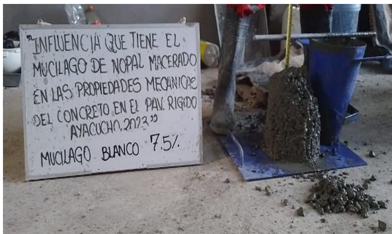
Figura 4. Método de cono de Abrams- Asentamiento del concreto.
