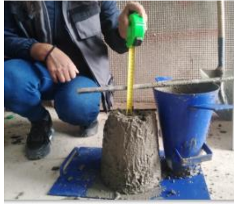
Imagen 35: slump del concreto patrón.
