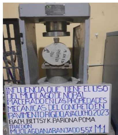
Imagen 50: rotura a tracción.
