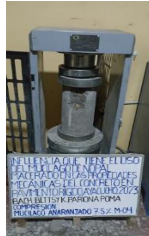
Imagen 46: rotura a compresión del testigo.
