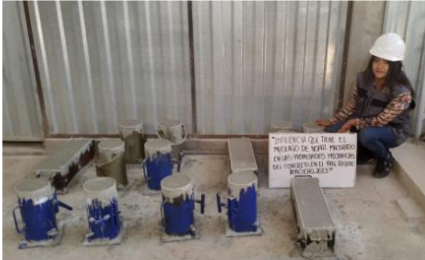
Imagen 40: vista de las muestras para la rotura a compresión, flexión y tracción.
