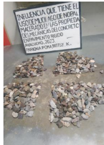
Imagen 23: cuarteo de piedra chancada lavada Y seca.
