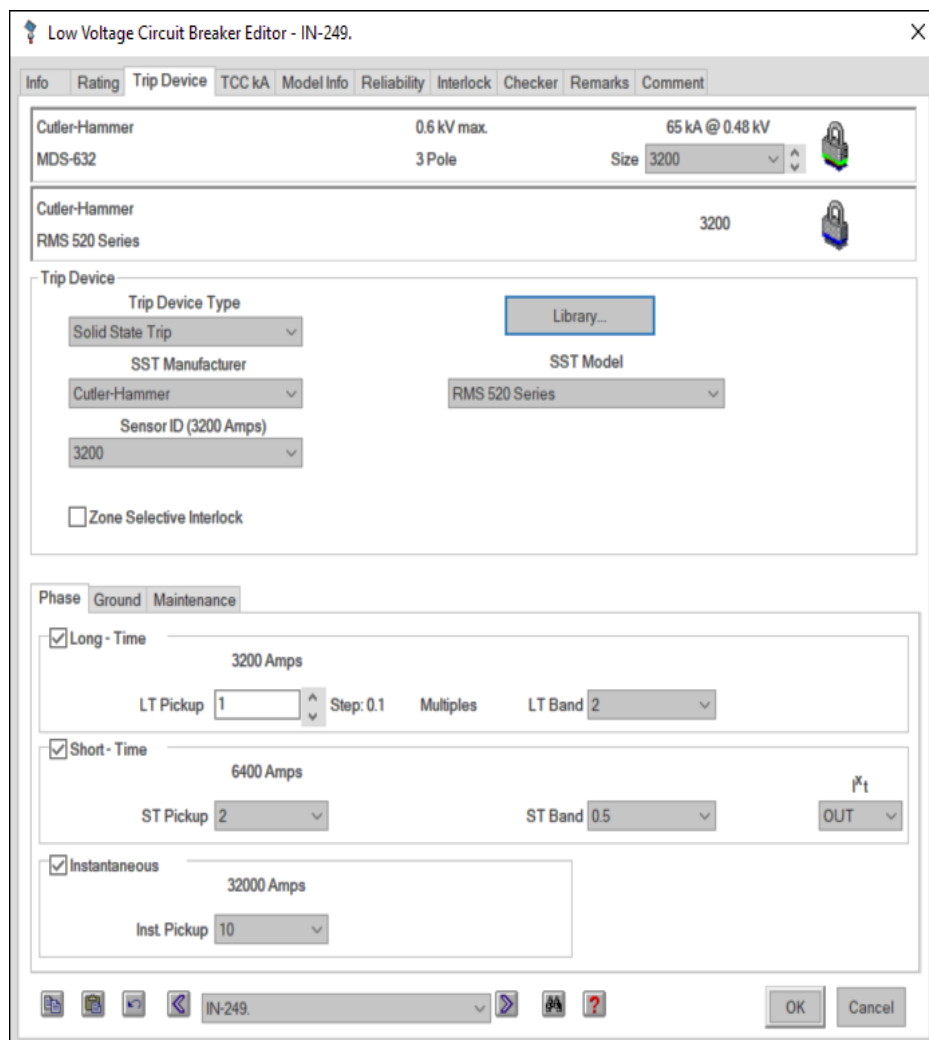
Figura 4.3.1: Configuración de parámetros de corriente del IN-249 de la sub estación de 22.9/0.48 Kv. Fuente: ETAP 20.00.
