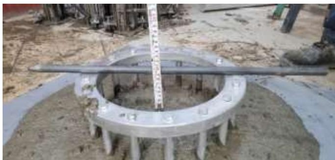
Figura 9. Ensayo en estado fresco del CAC
