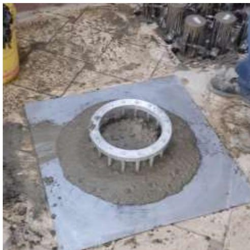
Foto 35. Ensayo de anillo J con D2
