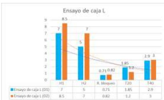
Figura 18. Ensayo de caja L con D1 vs D2
