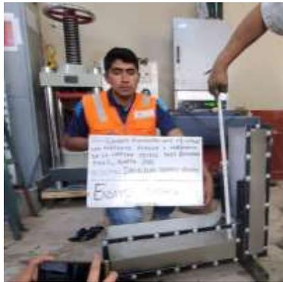
Foto 39. Ensayo de la caja L con D2
