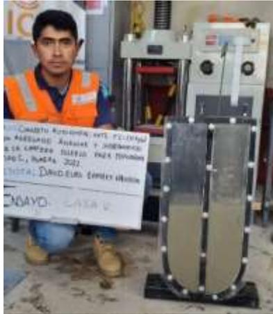
Figura 17. Ensayo de la caja U con agregado D2
