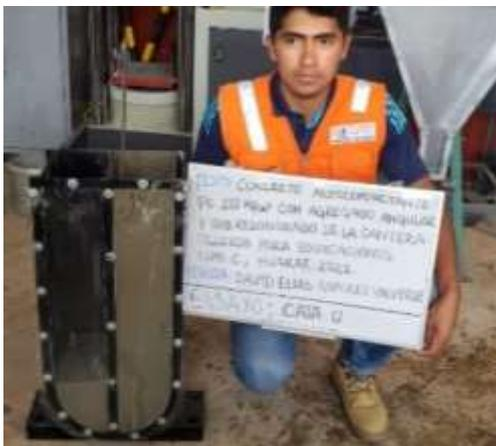
Foto 23. Ensayo de la caja U con D1
