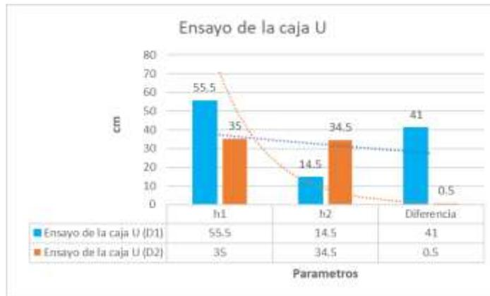
Figura 20. Ensayo de la caja U con D1 vs D2
