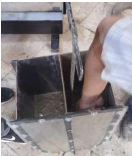
Foto 41. Ensayo de caja U con D2
