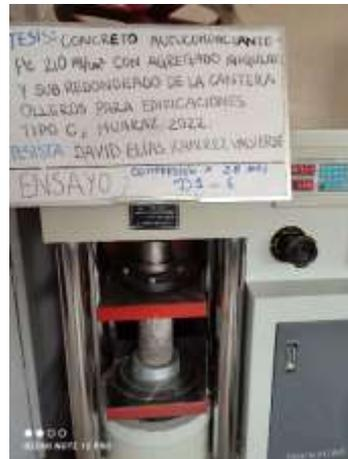
Figura 28. Ensayo de rotura a los 28 días de edad con D1
