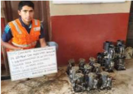
Foto 27. Probetas de 8" x 4" con D1
