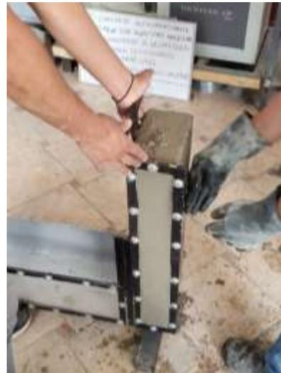
Foto 18. Ensayo de la caja L con D1
