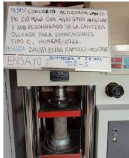
Foto 48. Ensayo de compresión con D2
