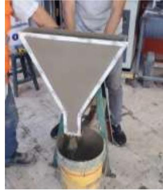
Foto 42. Ensayo de embudo en V con D2
