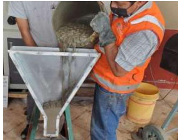
Foto 24. Ensayo del embudo V con D1
