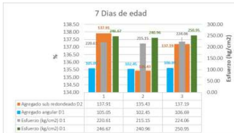
**Figura 30.** Resistencia a la compresión a los 7 días de edad del CAC con D1 vs D2.
