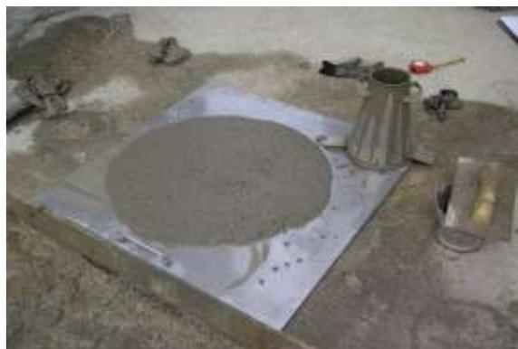
*Figura 4. Ensayo de expansión de flujo*
