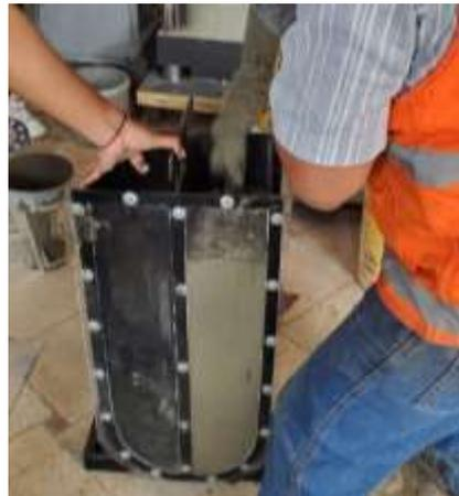
Foto 22. Ensayo de la caja U con D1
