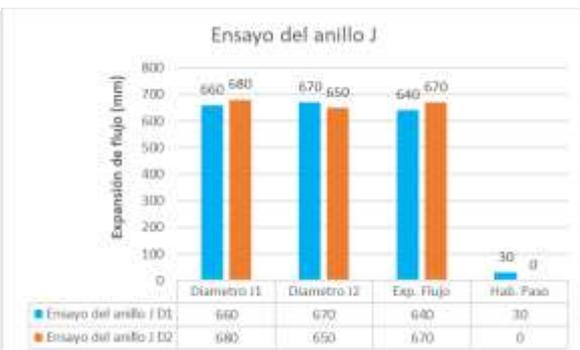
Figura 26. Ensayo del anillo J con D1 vs D2
