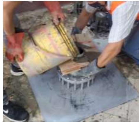
Foto 34. Ensayo de anillo J con D2
