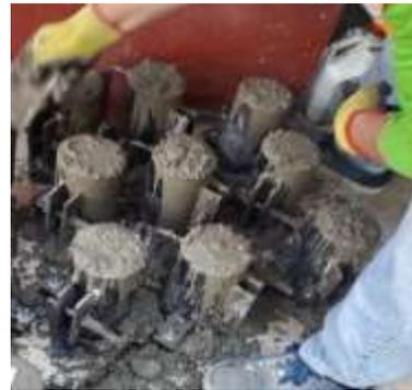
Foto 46. Probetas de CAC con D2
