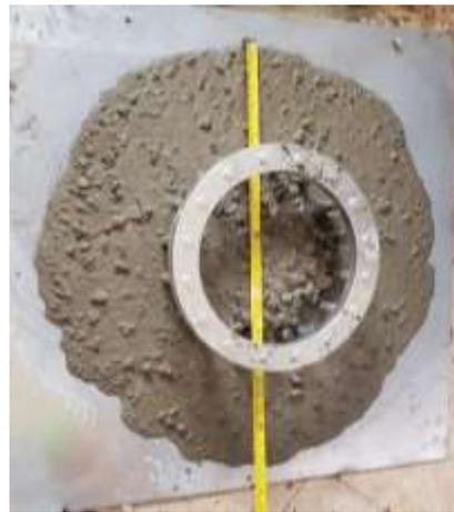
Foto 16. Ensayo de anillo J con D1
