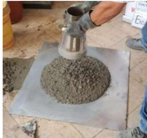
Foto 12. Ensayo de expansion de flujo con D1
