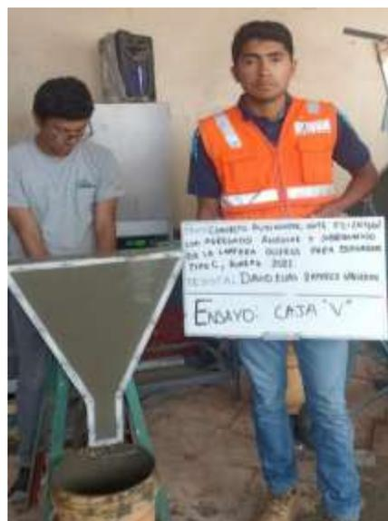
*Figura 14.* Ensayo de la caja L con D1      *Figura 15.* Ensayo del embudo en V con D1
