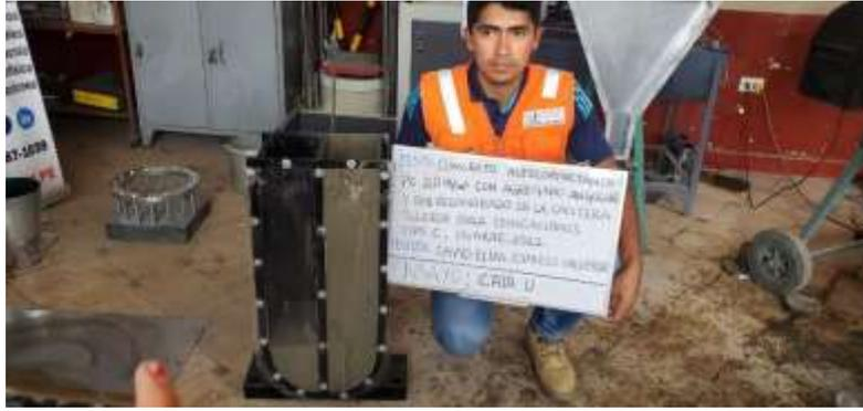
Figura 16. Ensayo de la caja U con D1
