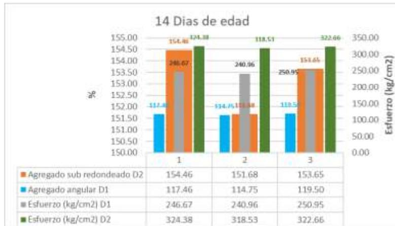
Figura 31. Resistencia a la compresión a los 14 días de edad del CAC con D1 vs D2.
