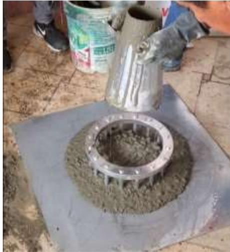
*Figura 21.* Ensayo de anillo J con D1
