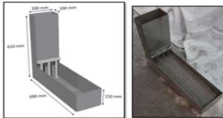
*Figura 2. Ensayo de la caja L*
