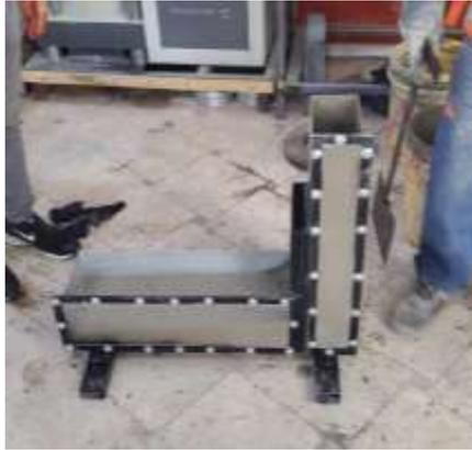
Foto 37. Ensayo de la caja L con D2
