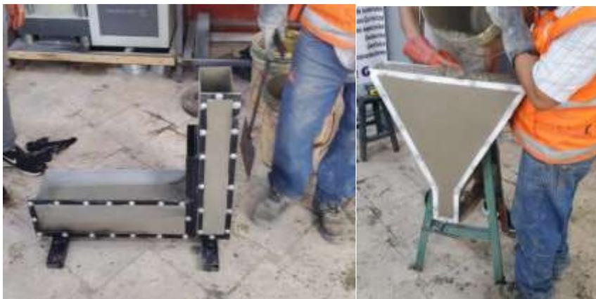
Figura 15. Ensayo de la caja L con D2
