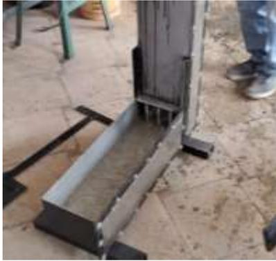
Foto 19. Ensayo de la caja L con D1
