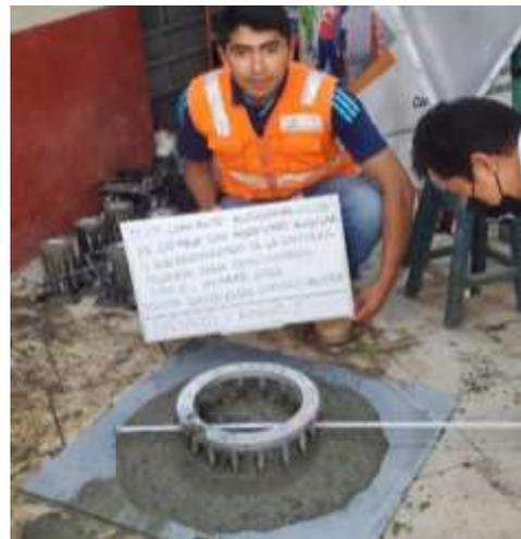
Foto 36. Ensayo de anillo J con D2
