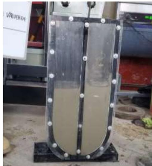
Foto 42. Ensayo de caja U con D2
