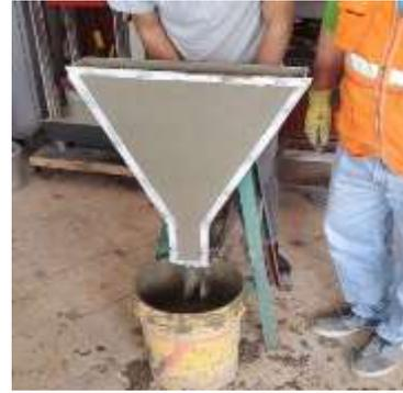
Foto 26. Ensayo del embudo V con D1
