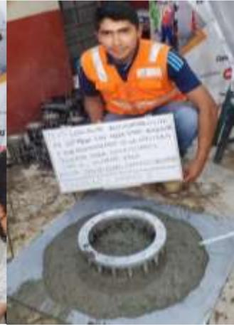
Figura 24. Ensayo de expansión de flujo con D2
