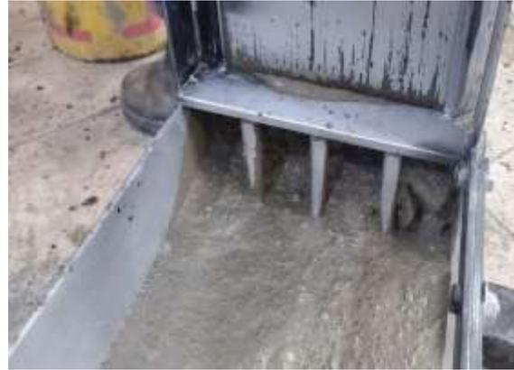
Foto 38. Ensayo de la caja L con D2
