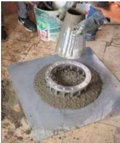
Foto 15. Ensayo de anillo J con D1
