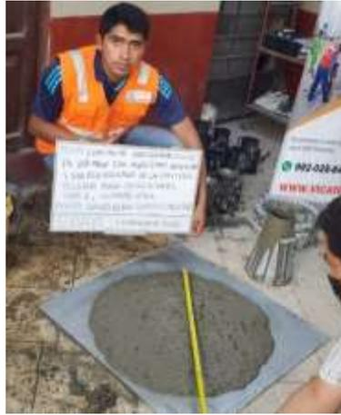
Figura 23. Ensayo de expansión de flujo con D2
