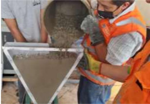
Foto 25. Ensayo del embudo V con D1
