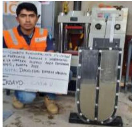
Foto 40. Ensayo de caja U con D2
