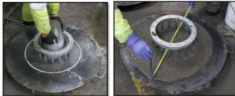
*Figura 3. Ensayo de los anillos J*
