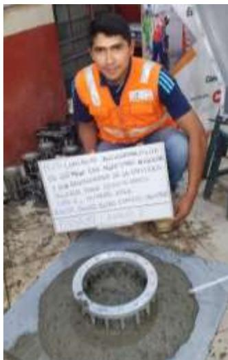
Foto 17. Ensayo de anillo J con D1
