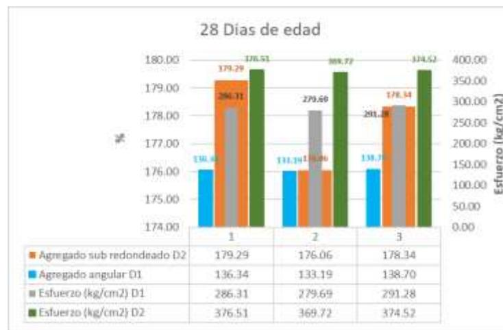
Figura 32. Resistencia a la compresión a los 28 días de edad del CAC con D1 vs D2.
