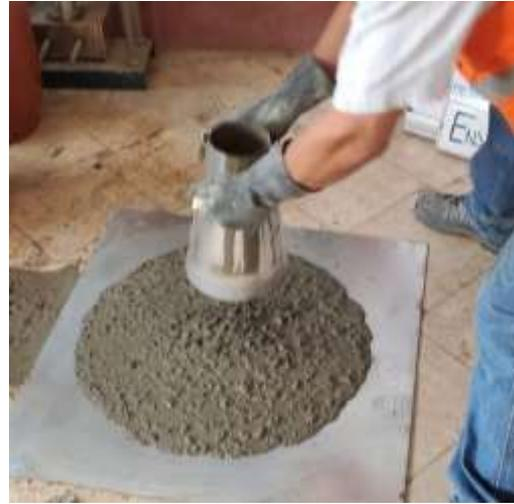
*Figura 22.* Ensayo de expansión de flujo con D1
