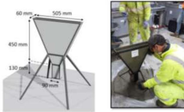
*Figura 5. Ensayo del embudo en V*
