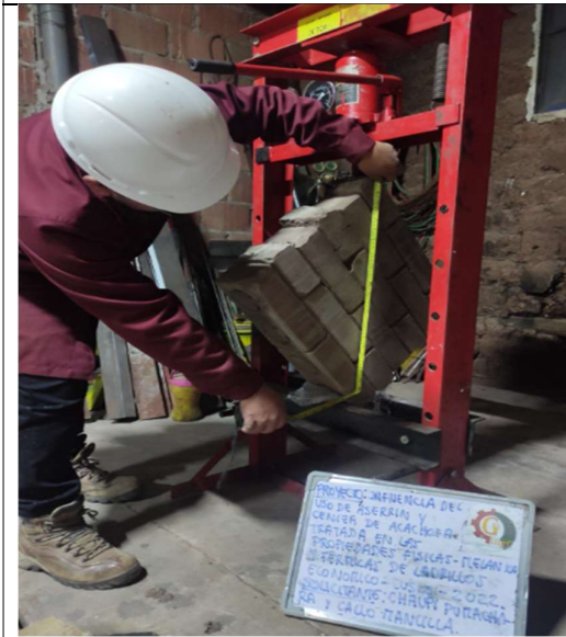
Fotografía 25: Ensayos de resistencia a compresión diagonal en muretes según NTP N° 399. 613.
