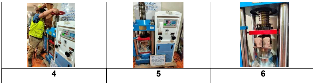
Figura 24 Procedimiento del ensayo de resistencia a la compresión en unidades.
