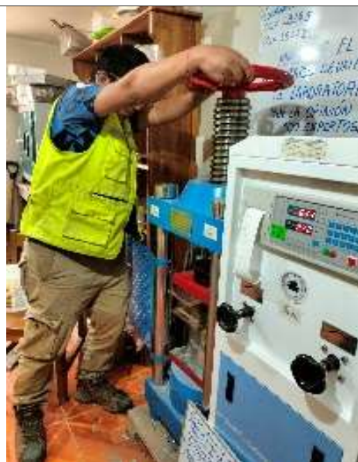
Fotografía 23: Ensayos de resistencia a compresión en unidades según NTP N° 399. 613.
