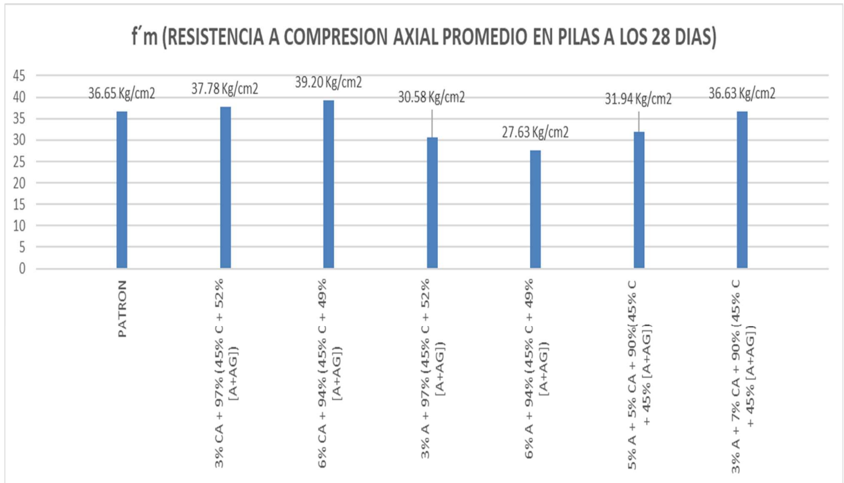
Figura 31 Resistencia promedio a la compresión axial en pilas a los 28 días.
