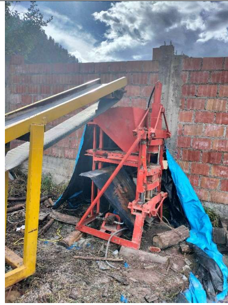
Fotografía 12: Acondicionamiento de la prensa manual para la elaboración de ladrillos ecológicos.
