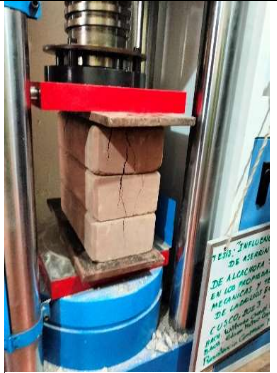
Fotografía 24: Ensayos de resistencia a compresión axial en pilas según NTP N° 399. 613.
