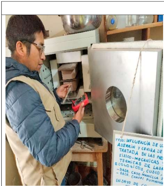
Fotografía 27: Ensayos de conductividad térmica según ASTM C177-13.
