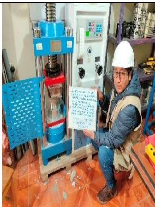
Fotografía 22: Ensayos de resistencia a compresión en unidades según NTP N° 399. 613.
