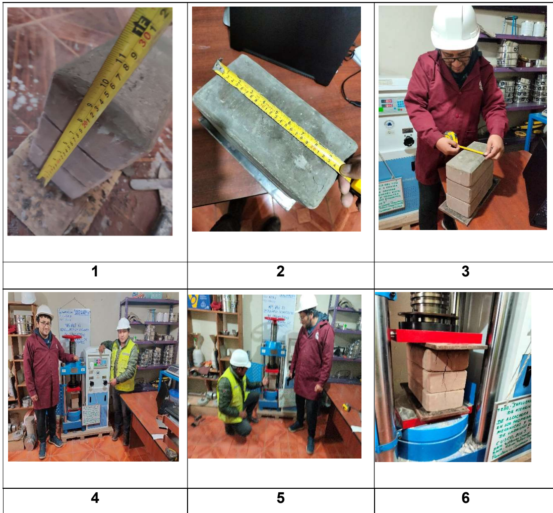
Figura 25 Procedimiento de ensayo de resistencia a la compresión axial de pilas.
