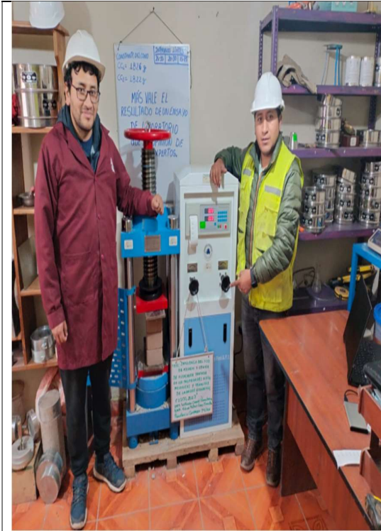
Fotografía 23: Ensayos de resistencia a compresión axial en pilas según NTP N° 399. 613.
