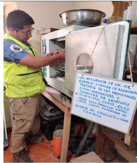
Fotografía 28: Ensayos de conductividad térmica según ASTM C177-13.
