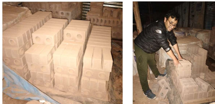
Figura 22 Muestreo de unidades de albañilería y rotulado.
