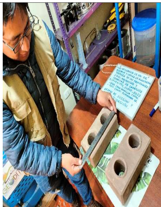
Fotografía 21: Ensayos de absorción según NTP N° 399. 613.
