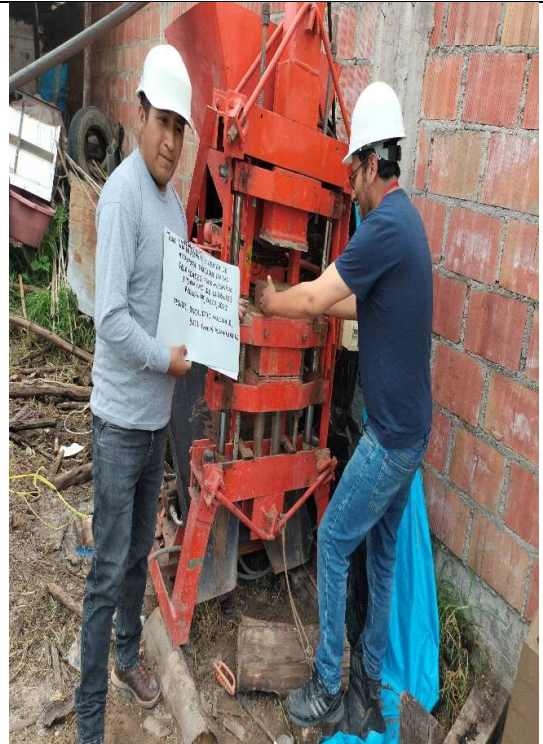
Fotografía 14: Elaboración de los ladrillos ecológicos con la prensa manual.
