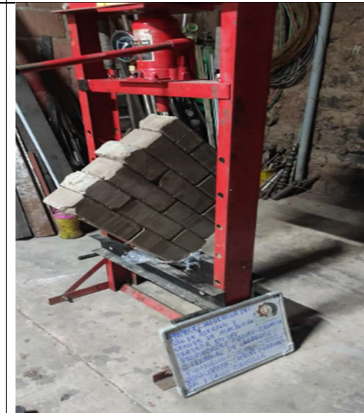
Fotografía 26: Ensayos de resistencia a compresión diagonal en muretes según NTP N° 399. 613.
