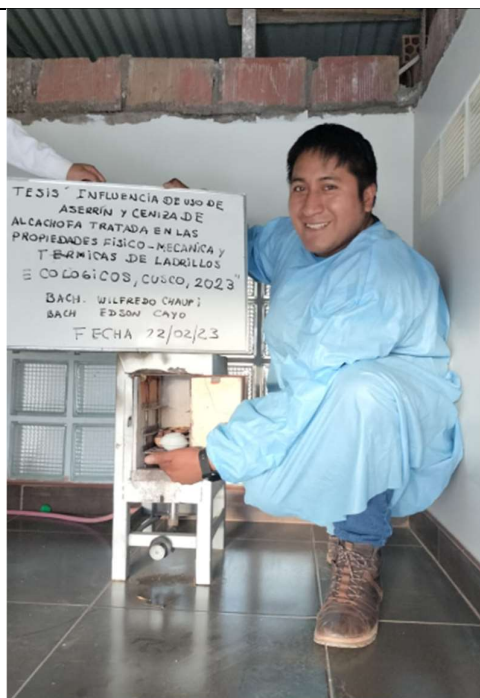
Fotografía 6: Incinerado de residuos secos de alcachofa en el Laboratorio MC QUIMICALAB.
