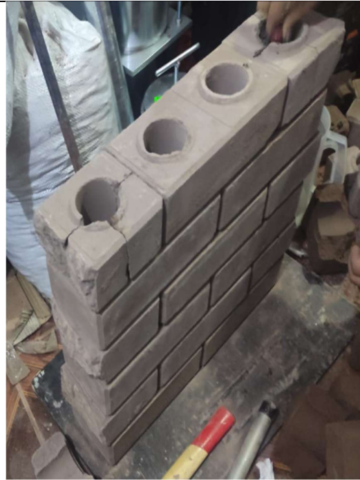
Fotografía 17: Elaboración de muretes de los ladrillos ecológicos a diferentes dosificaciones.
