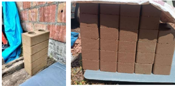
Figura 21 Almacenamiento de ladrillos ecológicos.
