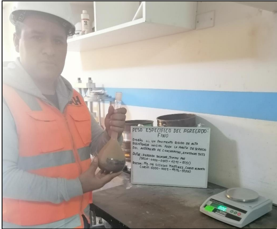
Imagen N°05: Peso específico del agregado fino
