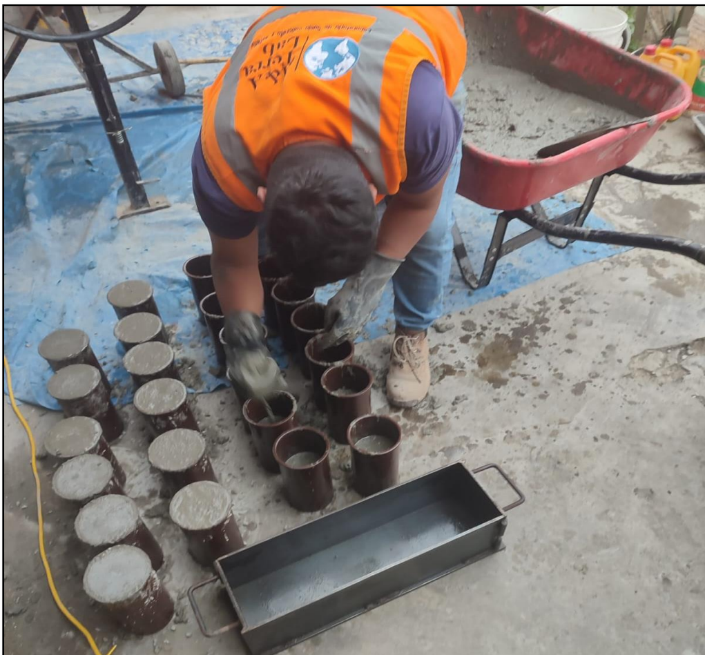
Imagen N° 11: Moldeo de probetas y viga
