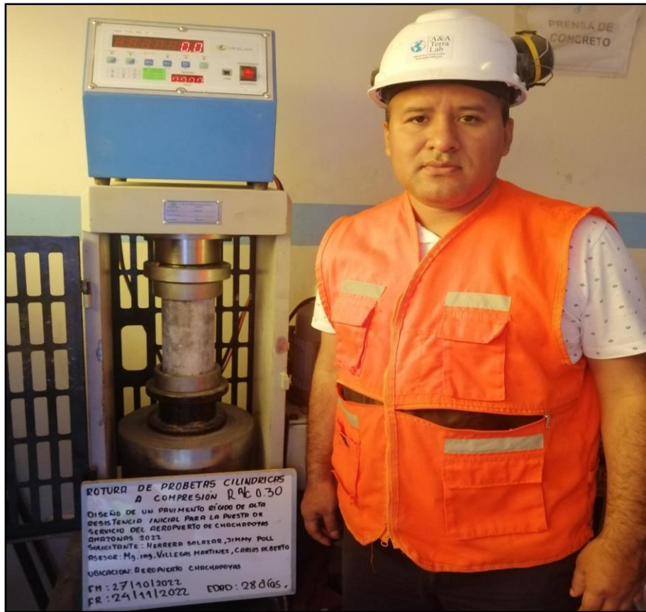
Imagen N°17: Ensayos a la Compresión a 28 días
