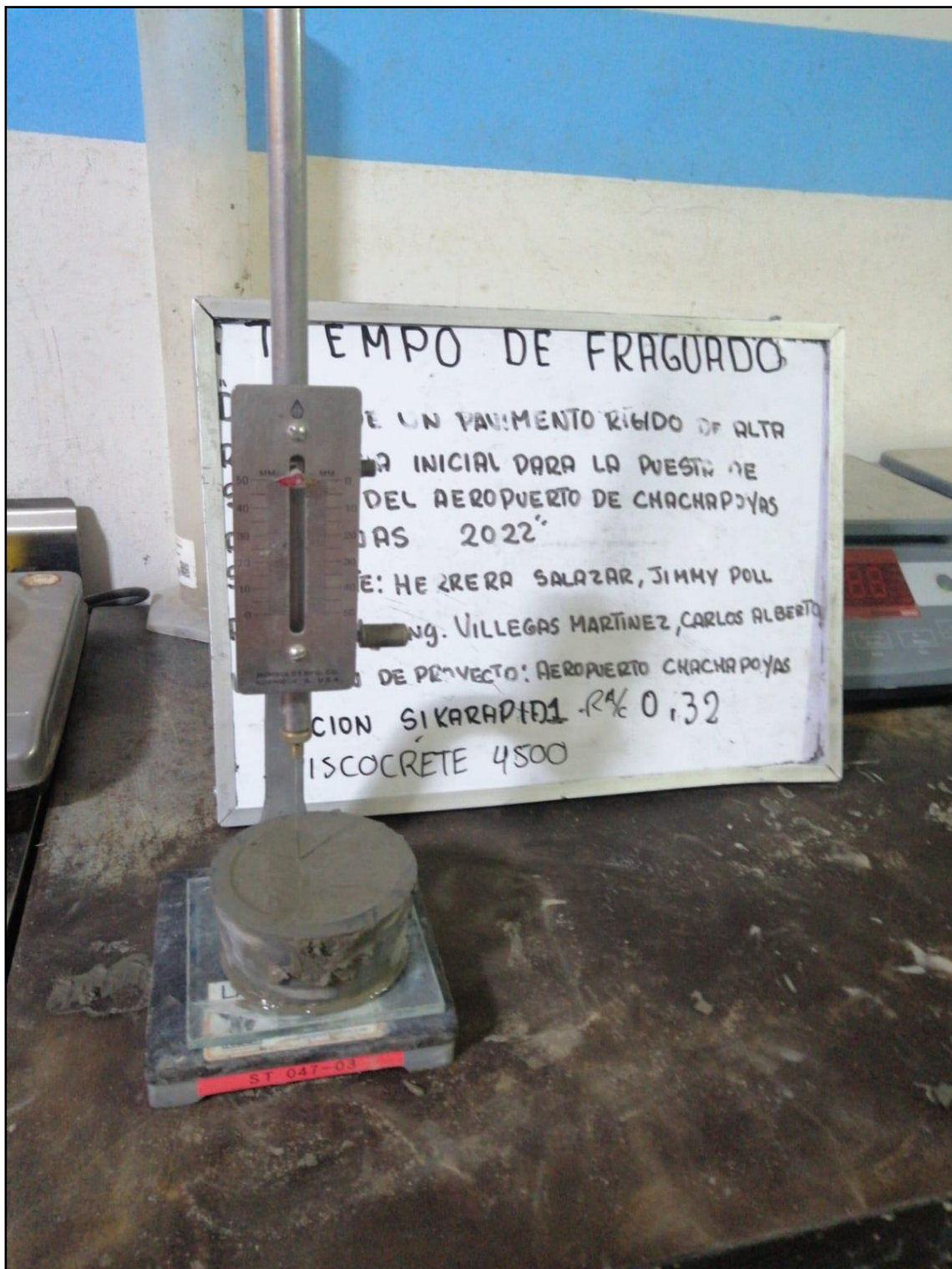
Imagen N°14: Tiempo de fraguado con aguja Vicat del diseño de concreto a/c =0.32 (2.2%SP + 1.2%AC)
