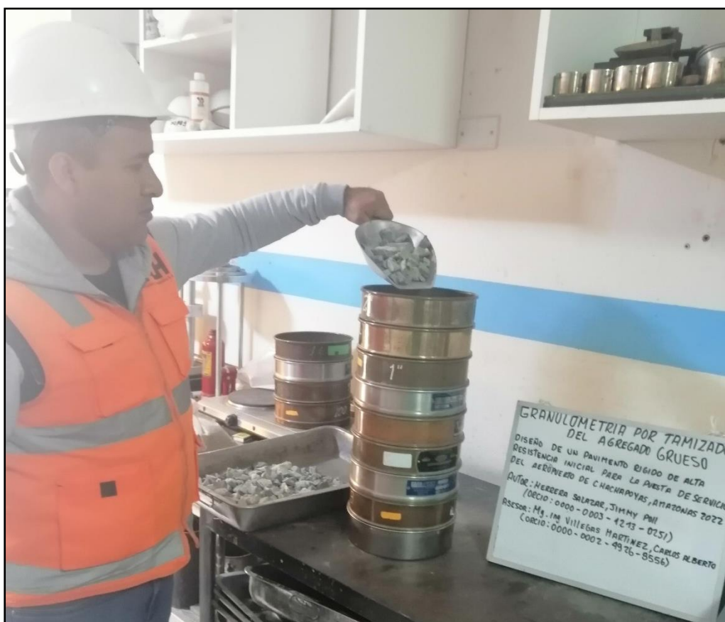
Imagen N°04: Granulometría por tamizado del agregado grueso
