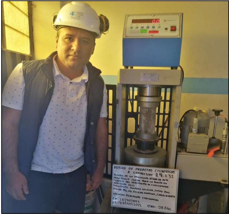
Imagen N°16: Ensayos a la Compresión a 28 días
