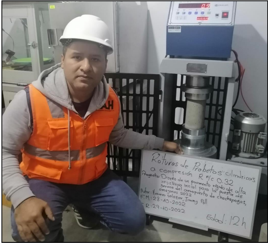
Imagen N°15: Ensayos a la Compresión a 12 horas
