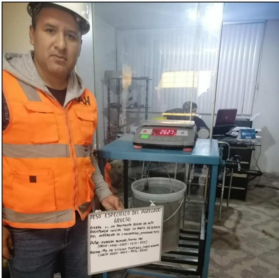
Imagen N°06: Peso específico del agregado grueso
