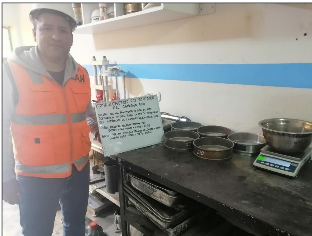
Imagen N°03: Granulometría por tamizado del agregado fino
