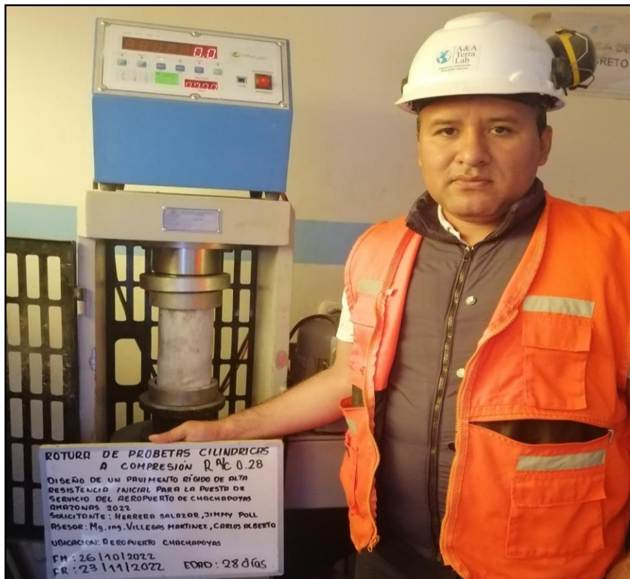
Imagen N°18: Ensayos a la Compresión a 28 días
