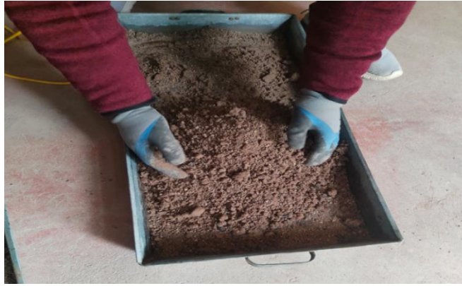
Figura 27: Ensayo Proctor Modificado adicionando mezcla asfáltica.
