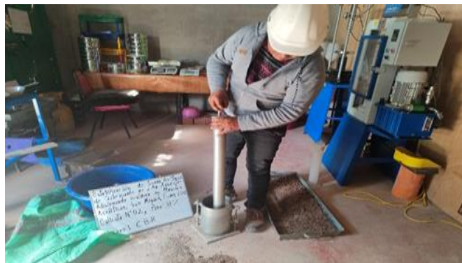
Figura 33: Prueba del CBR con adición de residuos de mezcla asfáltica.
