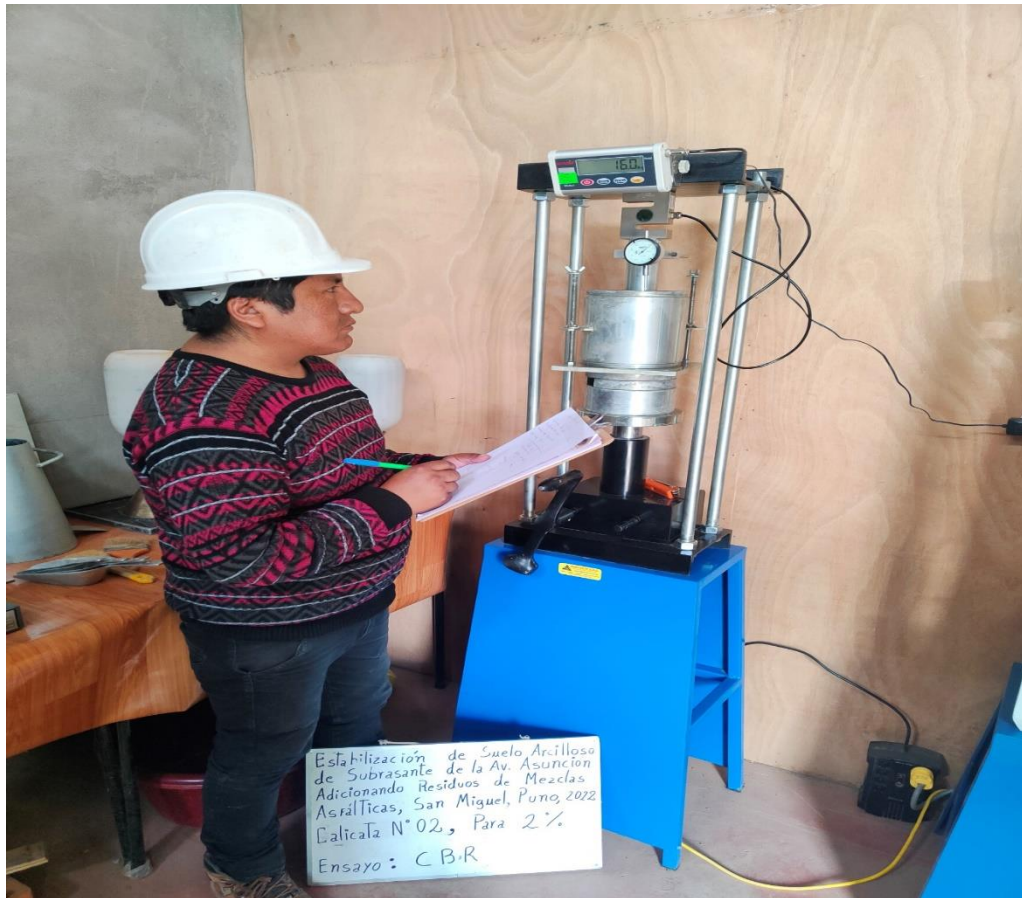
Imagen N° 06: Prueba de penetración para determinar el CBR.
