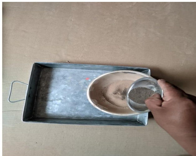
Figura 20: Incorporación de residuo de mezcla asfáltica al suelo natural.
