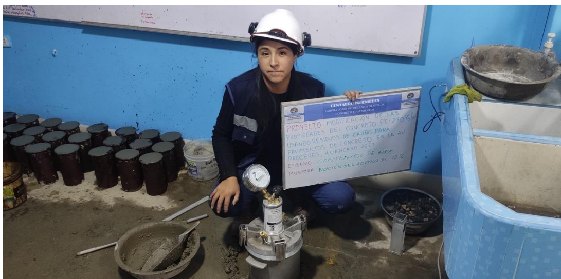
Figura 23. Medición de contenido de aire del concreto con residuo de chuño 12%
