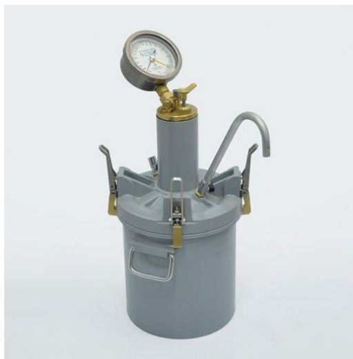
Figura 4. Medidor de contenido de aire – Manómetro. Fuente. Tomada de UTEST [35].
