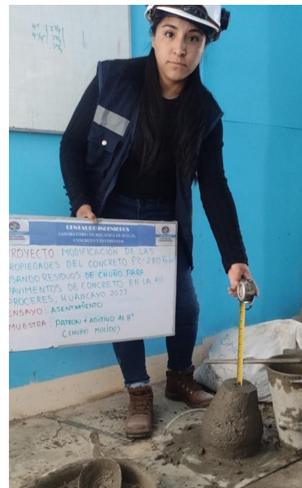
Foto N° 16: Ensayo de slump Fuente: Elaboración propia (2023).
