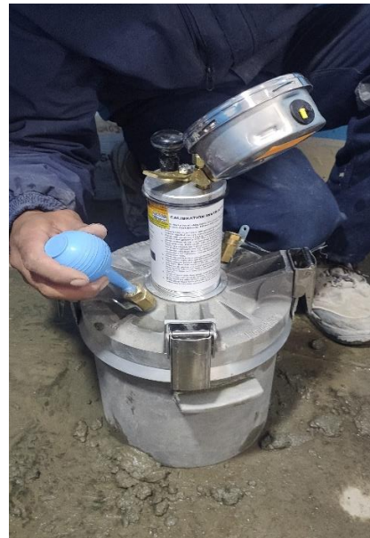
Foto N° 18: Incorporación de líquido para medir contenido de vacíos Fuente: Elaboración propia (2023).
