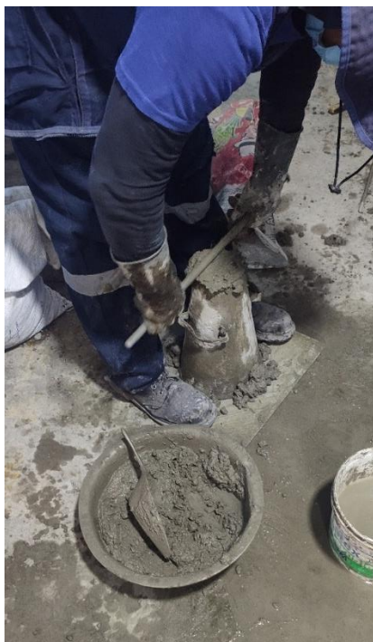
Foto N° 15: Ensayo de slump Fuente: Elaboración propia (2023).
