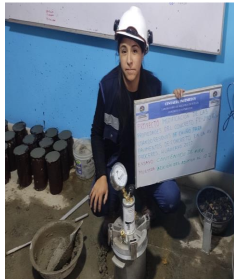
Foto N° 20: Elaboración del ensayo de contenido de aire Fuente: Elaboración propia (2023).
