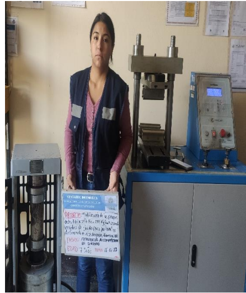
Foto N° 26: Rotura de la probeta a los 7 días Fuente: Elaboración propia (2023).
