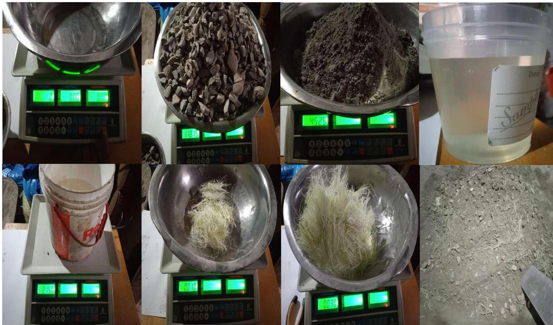
Anexo 3: nueva dosificación en función al agregado grueso, 01%,03% y 0.5%.
