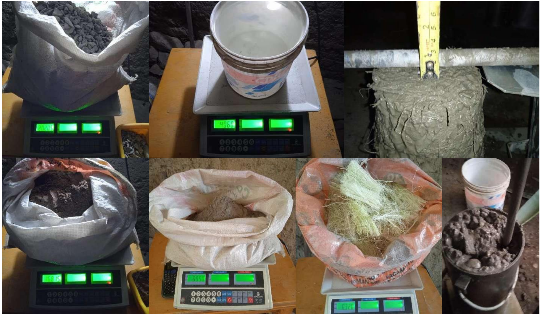
Anexo 3: segunda dosificación al 2% con respecto al agregado grueso.
