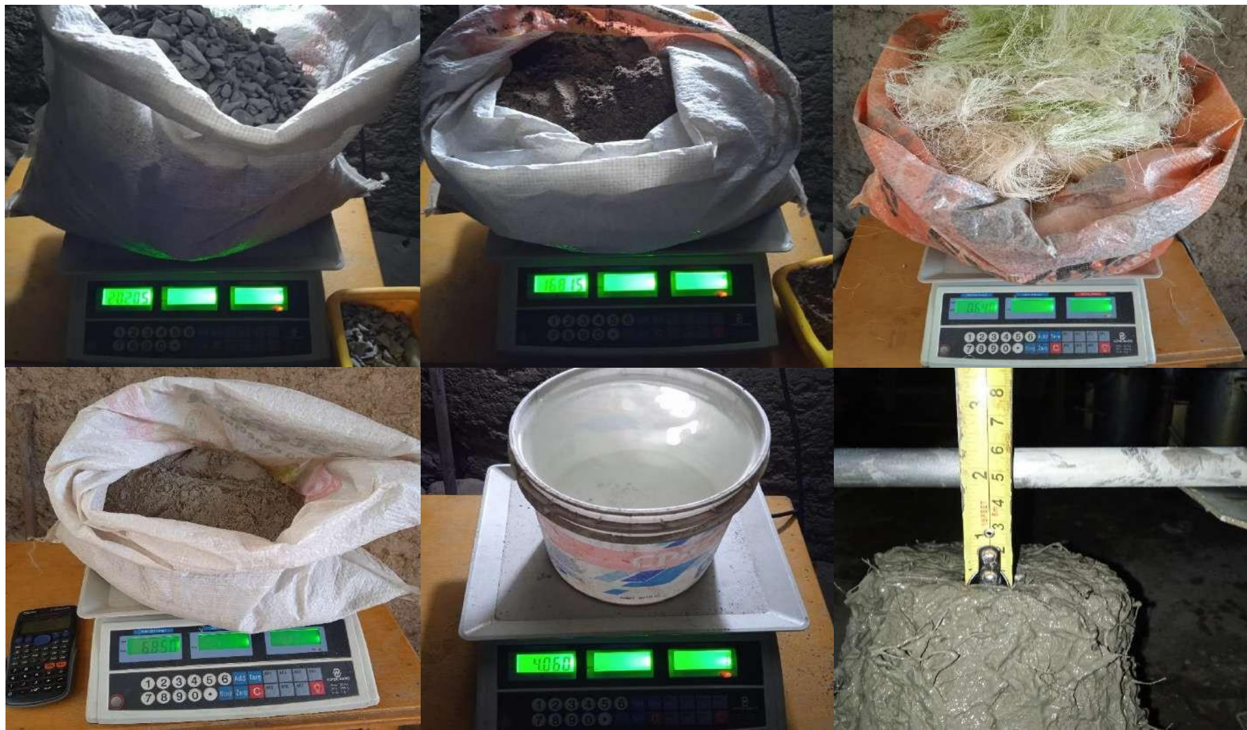
Anexo 3: tercera dosificación al 4% en función del agregado grueso
