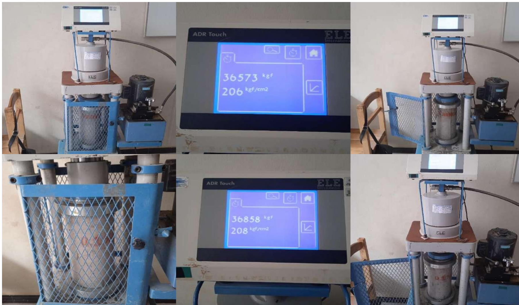
Anexo 3: ensayo de compresión de las probetas a los 7 días, la muestra patrón y el 01% de fibra de maguey.
