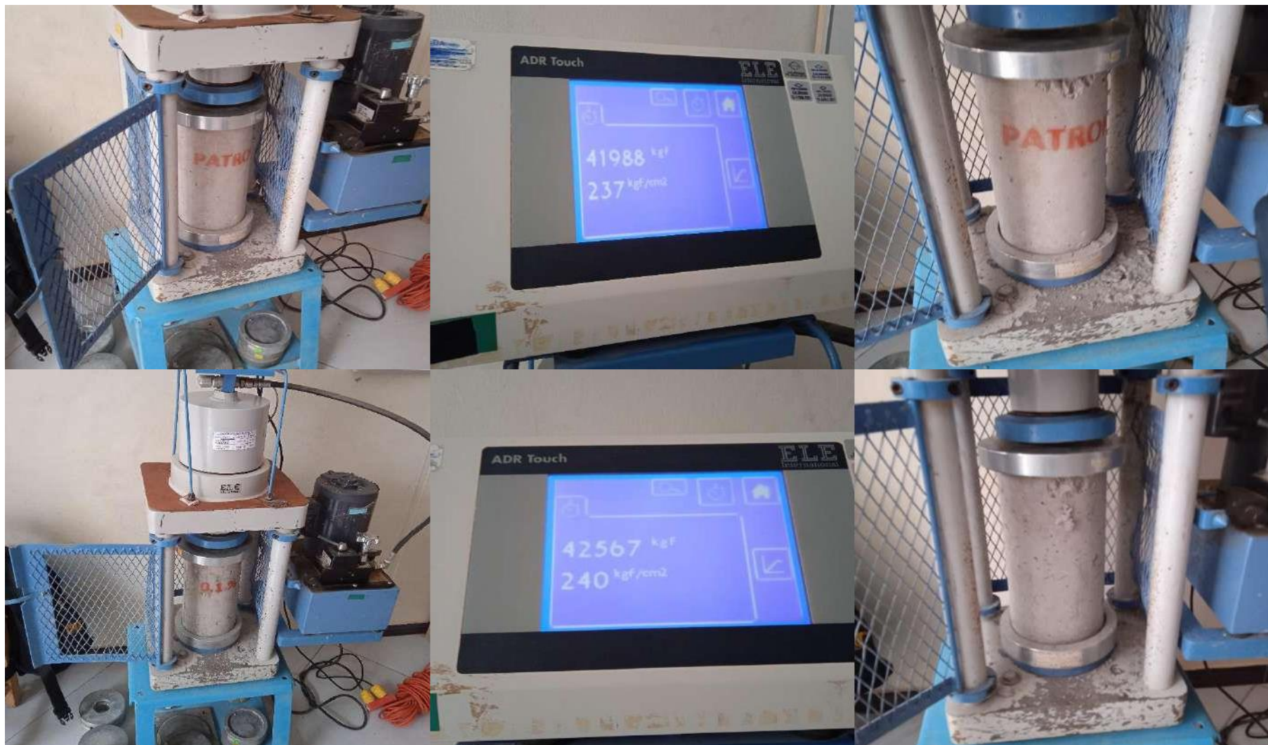
Anexo 3: ensayo de rotura a las probetas a los 14 días, muestra patrón y 0.1% de fibra de maguey.
