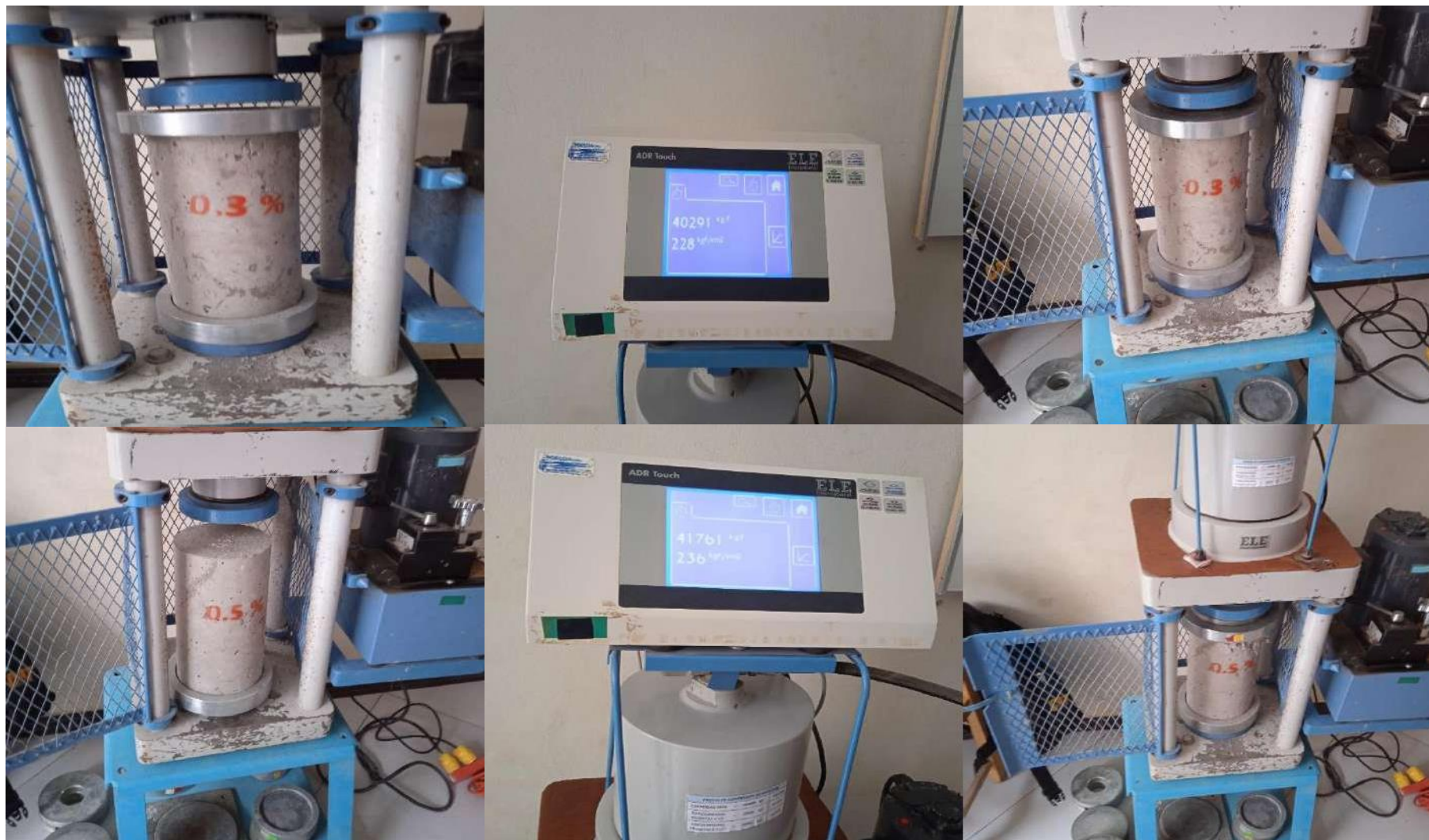
Anexo 3: ensayo de rotura de probetas a los 14 días, 0.3% y 0.5% de fibra de maguey
