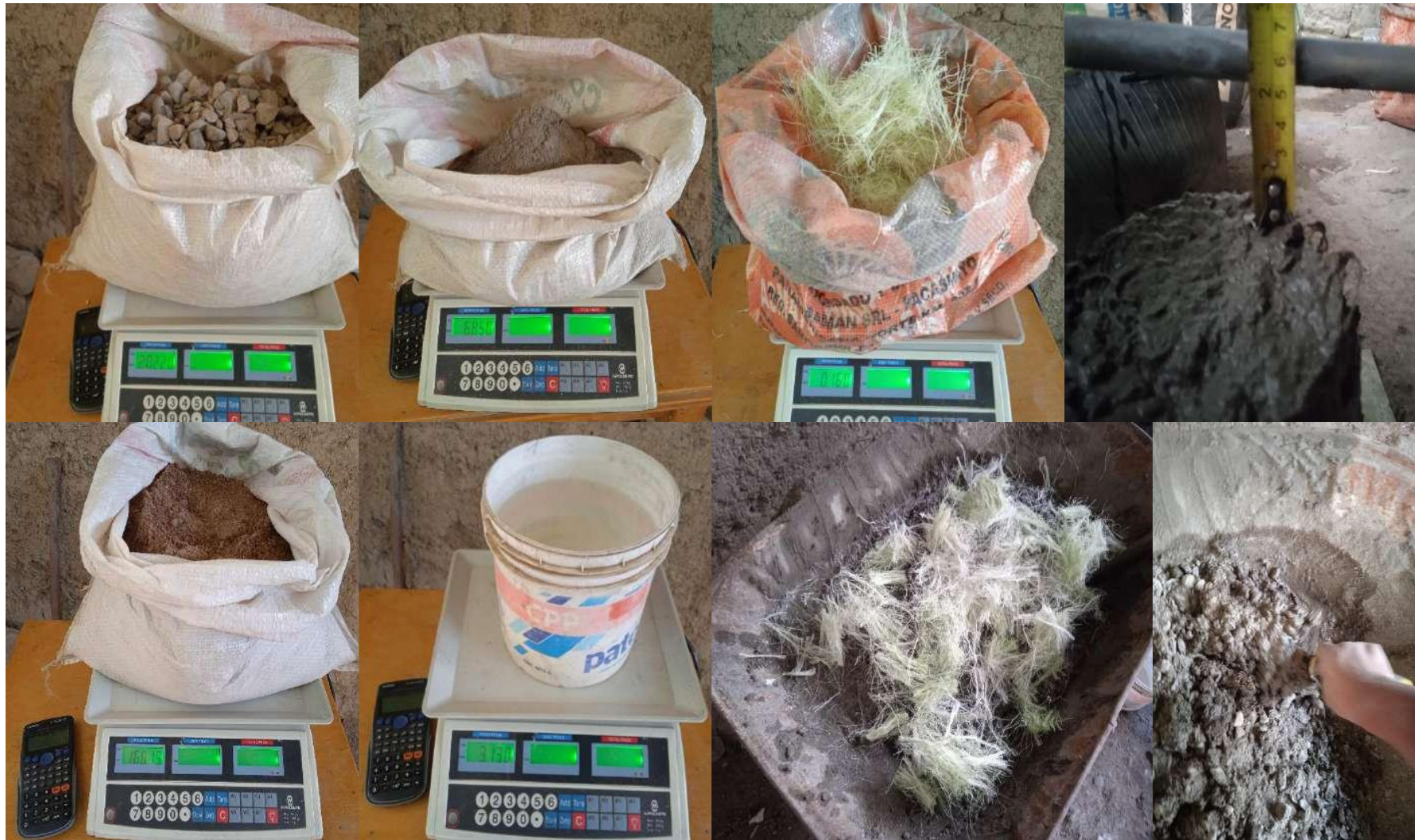
anexo 3: primera dosificación al 1% de fibra de maguey con respecto al agregado grueso
