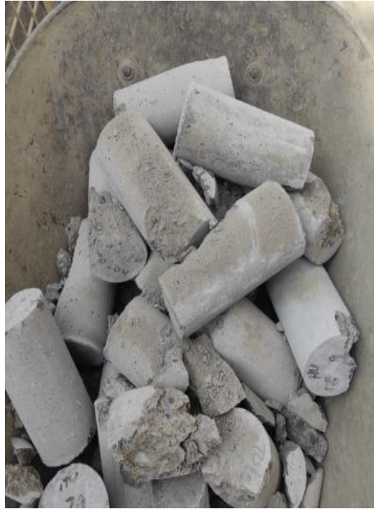
Probetas después del ensayo de compresión
