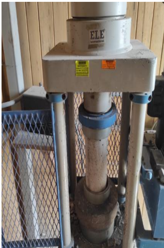
Proceso del ensayo de rotura de probetas 2
