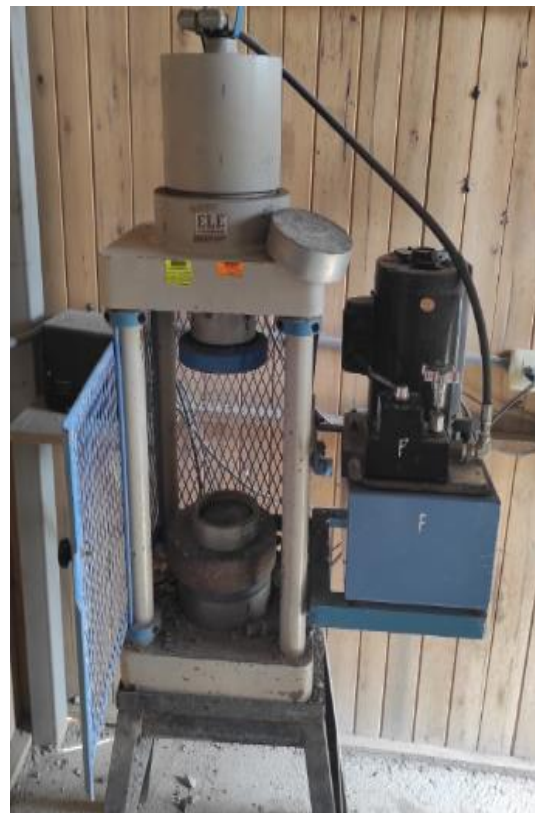
Proceso del ensayo de rotura de probetas 3
