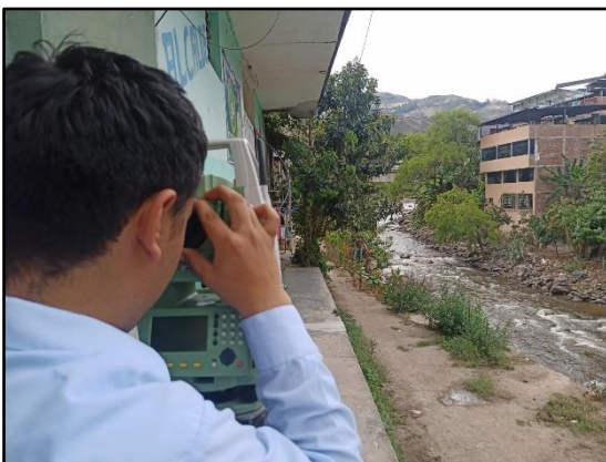
IMAGEN N 05: Se evidencia la estación total en un punto fijo para levantamiento topográfico.
