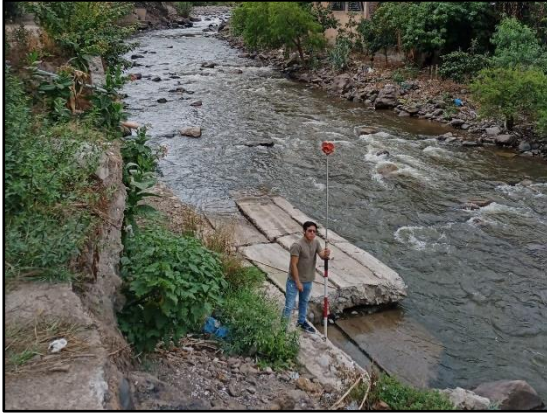
IMAGEN N 01: Se observan la toma de puntos topográficos con estación total en pasaje el triunfo.
