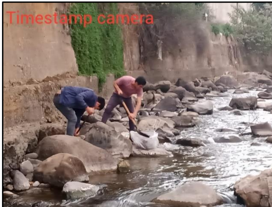
IMAGEN N 01: Se observa la extracción de muestra del suelo del cauce para conocer los parámetros del suelo con fines de socavación.
