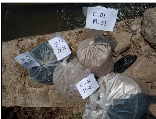
IMAGEN N 04: Se evidencian las muestras (04), que serán llevadas al laboratorio de mecánica de suelos para la obtención de los parámetros del suelo.
