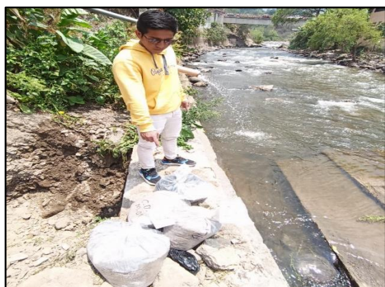
IMAGEN N 05: Se observan las muestras en bolsas plastificadas de polietileno para conservar su humedad del suelo.
