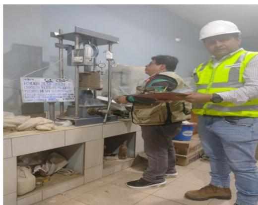
Figura N°46: Procedimiento de CBR, de la calicata C-1.
