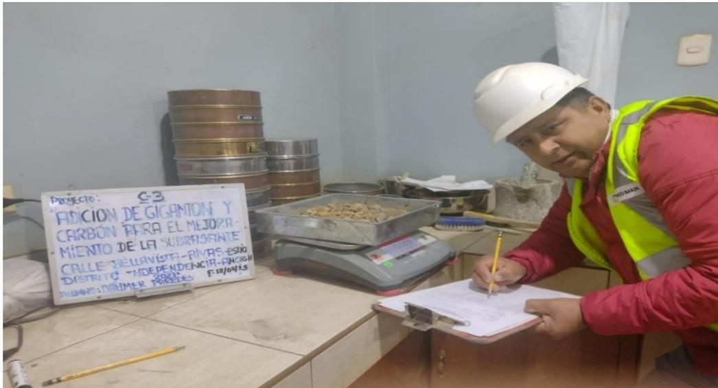
Figura N°34: Procedimiento de análisis granulométrico de Calicata C-3.
