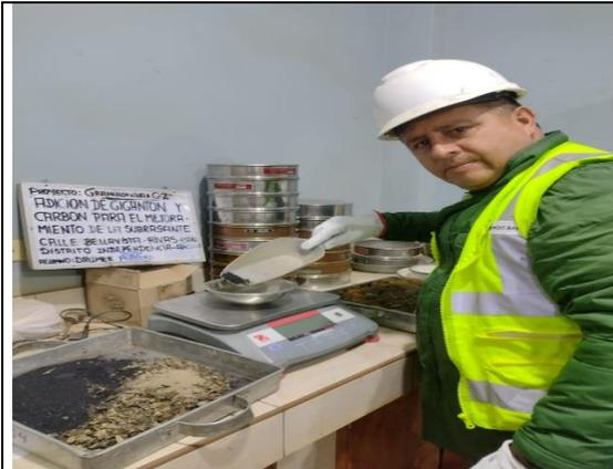
Una vez lavado la muestra se procede a pesar la muestra para realizar los ensayos de limites de consistencia, tamizando con el tamiz N° 40 y obtener 100 gr de material para el LL Y 20 g para el LP.
