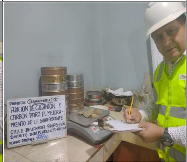
Obtención del material según las medidas de los tamices, donde cada material tiene su peso indicado para poder realizar la curva granulométrica y así identificar según la norma ASHHTO Y SUCS.
