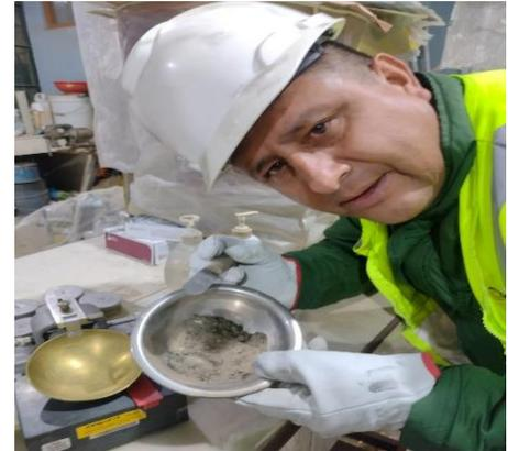
Aquí se presenta la porción de muestra obtenida para realizar el ensayo, se añade polvo de gigantón y carbón.
