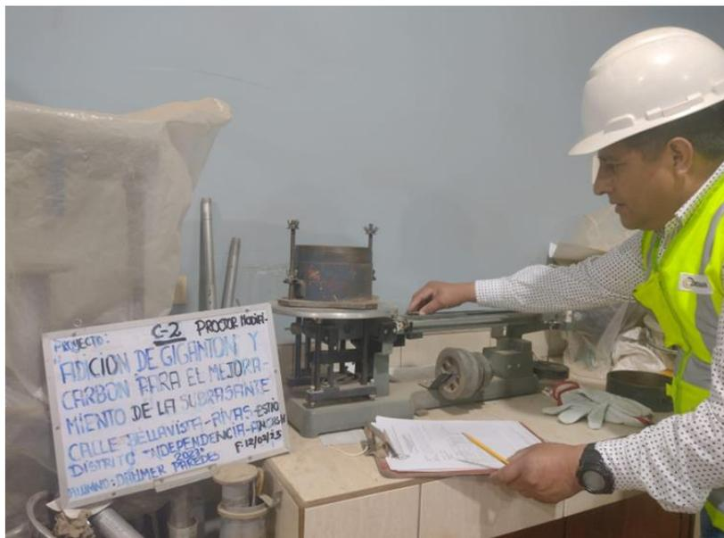
Figura N°44: Proctor modificado de la C-2, para obtener la MDS, OCH.
