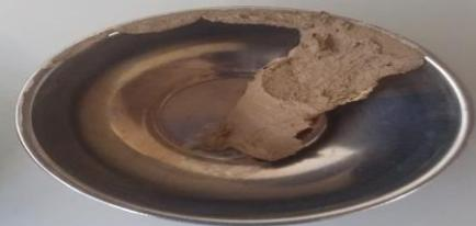
Se obtiene en totalidad 3 muestras del límite líquido, donde se llevó a un horno por 12 horas, para obtener los resultados.
