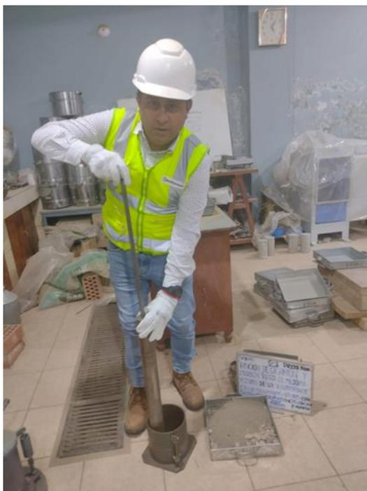
Figura N°42: Procedimiento de Proctor Modificado C-1 para la obtencion de MDS y OCH.
