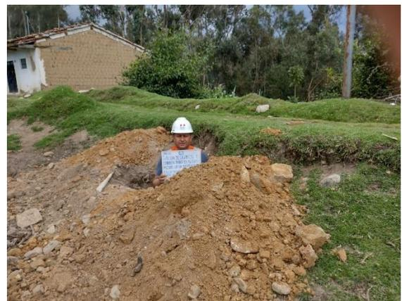
Figura 22, 23: Procedimiento de extracción de muestras de la Calicata C-3.
