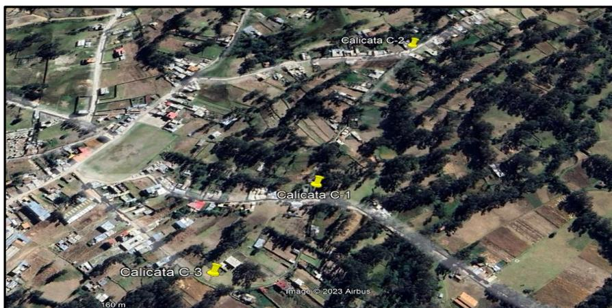
Figura 19. Puntos de localización de las calicatas C-1, C-2, C-3.
