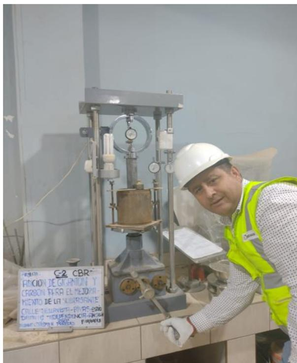
Figura N°48: Procedimiento CBR C-2, con sus respectivas dosificaciones.
