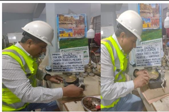
Una vez que se tiene la cantidad requerida de la muestra, se tiene que agregar liquido de manera controlada, la finalidad es buscar una cantidad para que pueda cumplir en el ensayo de Casagrande y hallar el límite líquido. En total se realiza 3 muestras: 15-25 g; 20-30; 25-35. (golpes). LL de la calicata C-1, con sus dosificaciones.
