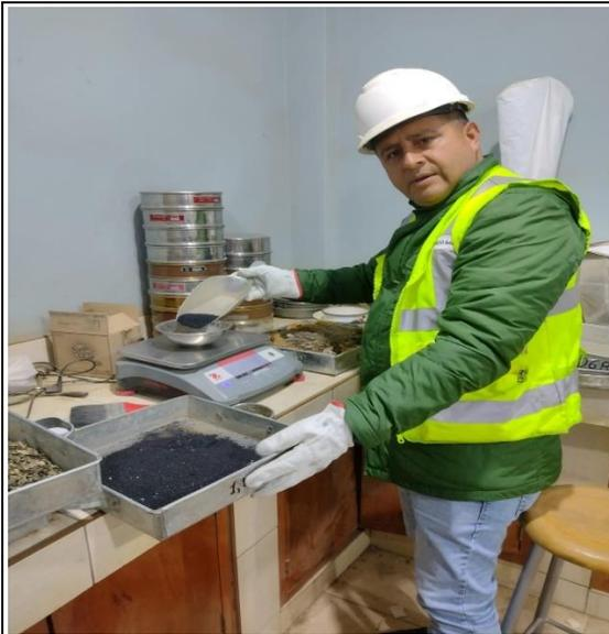
Al realizar el ensayo granulométrico, lo primero se realizó el tamizado del material arcilloso en las mallas que es desde la medida de 3" hasta la malla N°200, la serie de Taylor, con la adición porcentual de gigantón y carbón.
