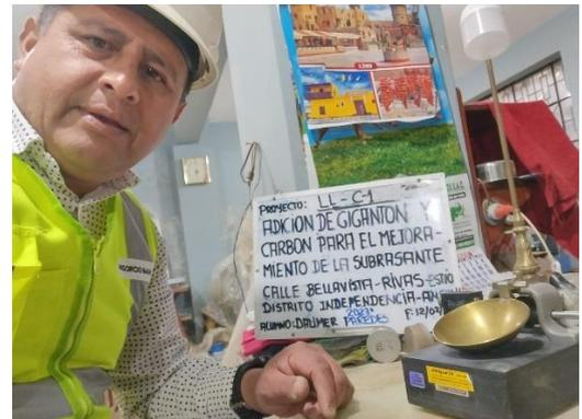
Nombre del proyecto y equipo de ensayo de Limites de consistencia calibrado
