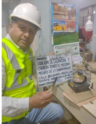
Se procede a realizar el ensayo de Limite Liquido en la copa de Casa Grande, para ello se toma un porcentaje de muestra con el uso de una espátula se conforma el suelo y luego se procede a girar la manija de la copa de casa grande, produciendo golpes hasta que las paredes del surco se unan, el numero de golpes esta comprendido entre 15 y 35, se toma una muestra de 10 a 15 gr del surco donde se cerro para verificar su límite liquido C-2.
