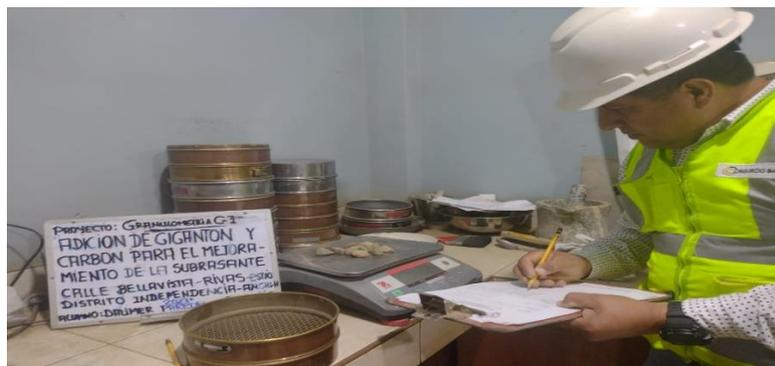
Figura 24: Procedimiento de análisis granulométrico de la Calicata C-1.
