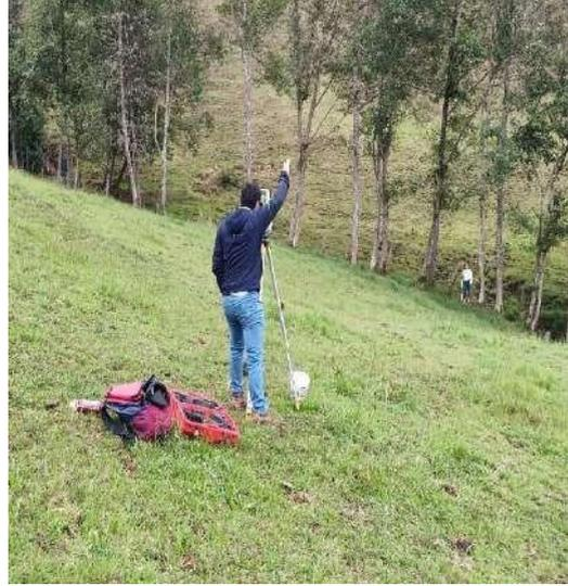
**FOTOGRAFÍA N° 06:** Toma de puntos topográficos del trazo preliminar de la línea de conducción
