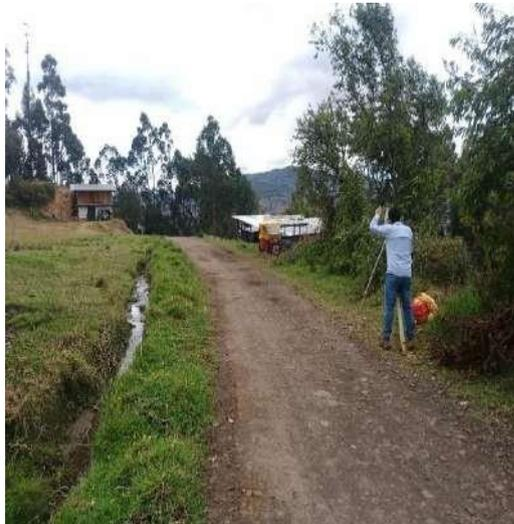
**FOTOGRAFÍA N° 07:** Toma de puntos topográficos en las viviendas referenciales
