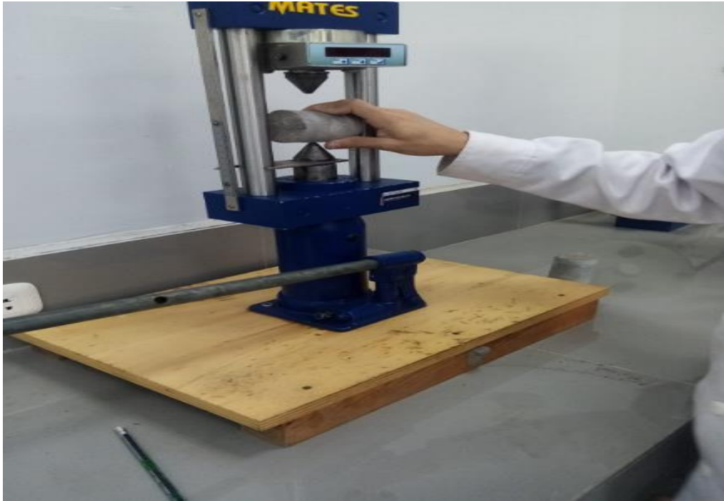
Figura 16: Colocación del testigo en el equipo de ensayo
