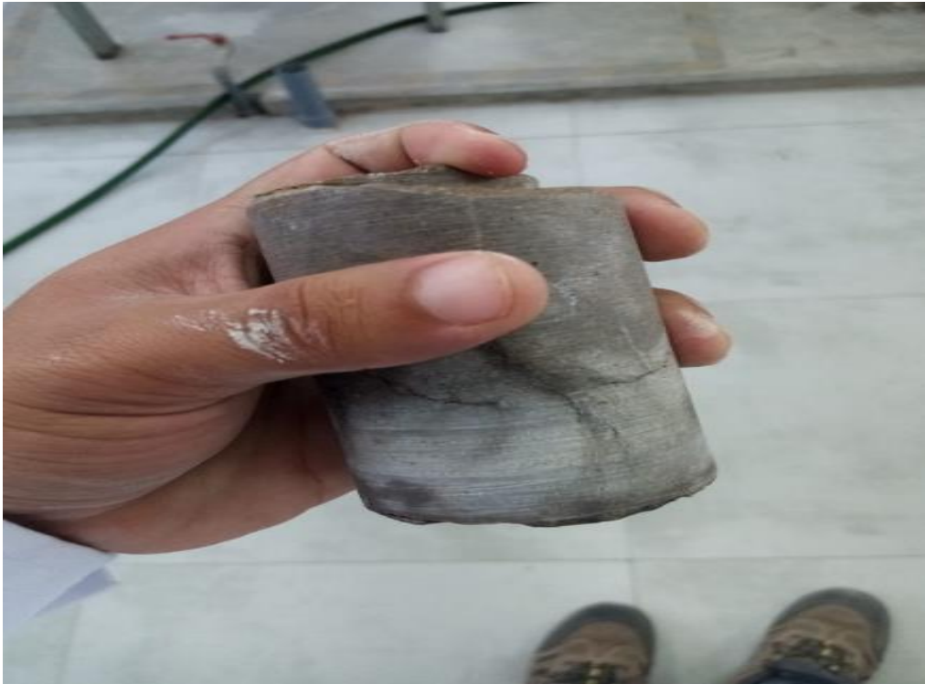
Figura 14: Testigo para la compresión simple
