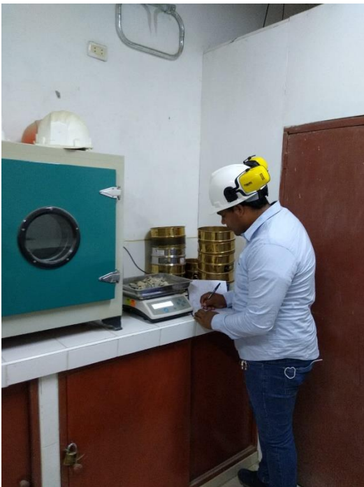
Ensayo de granulometría de los agregados
