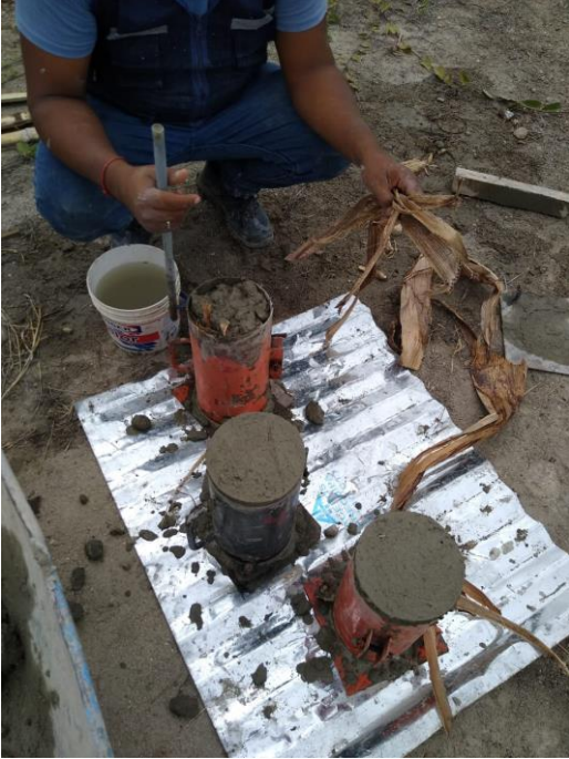
Llenado de probetas agregando la fibra de tallo de plátano
