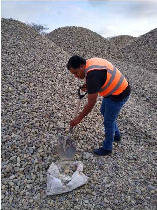
Extracción del agregado grueso y fino en cantera San Jacinto
