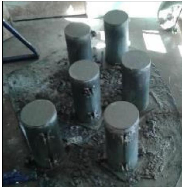
*Imagen 8: Probetas con Concreto de Agregado Chancado*
