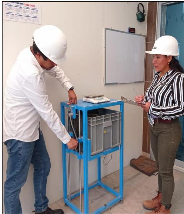
*Imagen 6: Peso del Agregado Grueso saturado*
