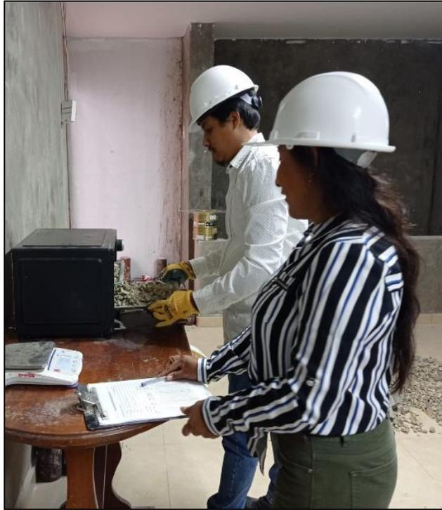
*Imagen 7: Secado al horno de la tara en estado húmedo*
