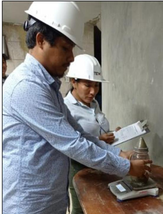
*Imagen 4: Peso de Agregado Fino Sumergido en Agua de un Picnómetro*
