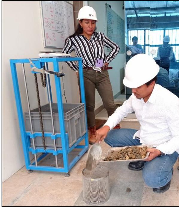
*Imagen 5: Peso del Agregado Grueso saturado*
