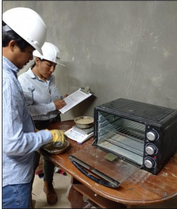
*Imagen 3: Peso de la Tara del agregado fino seco*
