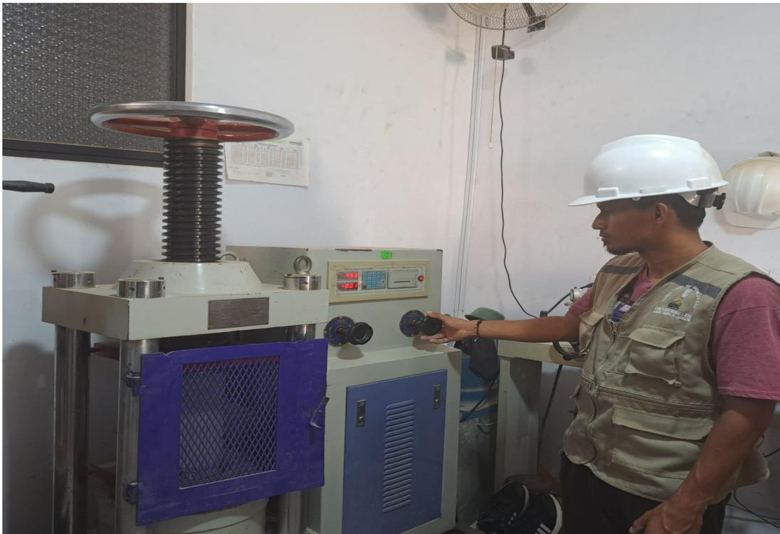
**Anexo 8.13:** Ensayo de roturas de boquetes de concreto 14 días
