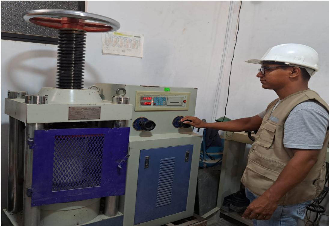
**Anexo 8.14:** Ensayo de roturas de boquetes de concreto 28 días
