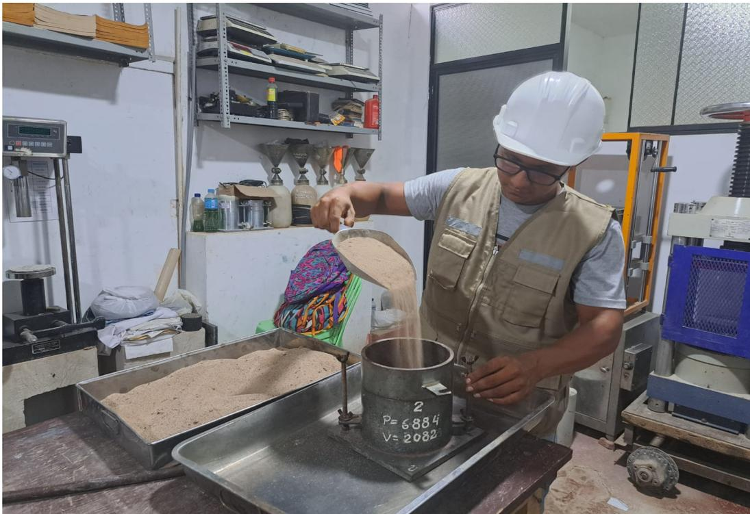
**Anexo 8.7: Ensayo de los agregados – Peso unitario compactado**
