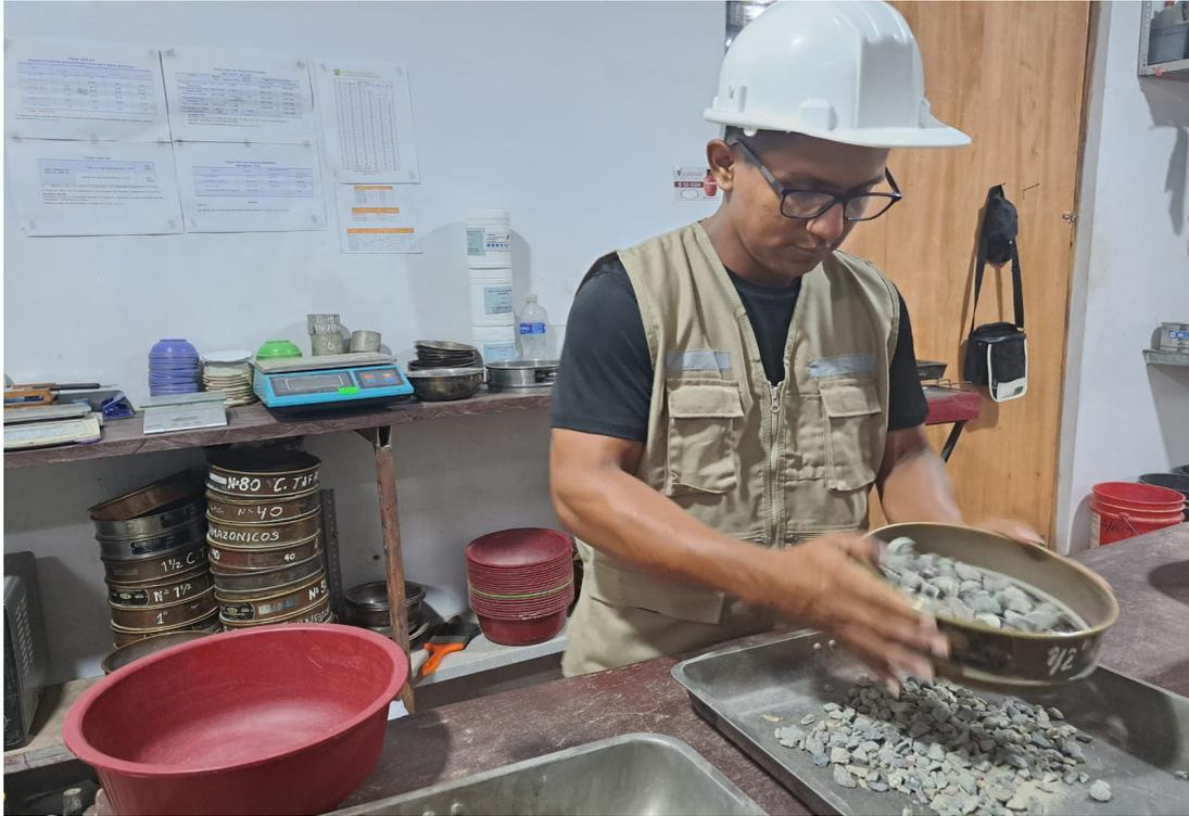
**Anexo 8.6: Ensayo de los agregados – Peso unitario suelto**
