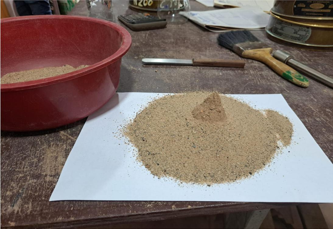
**Anexo 8.9:** Ensayo de los agregados – Peso específico
