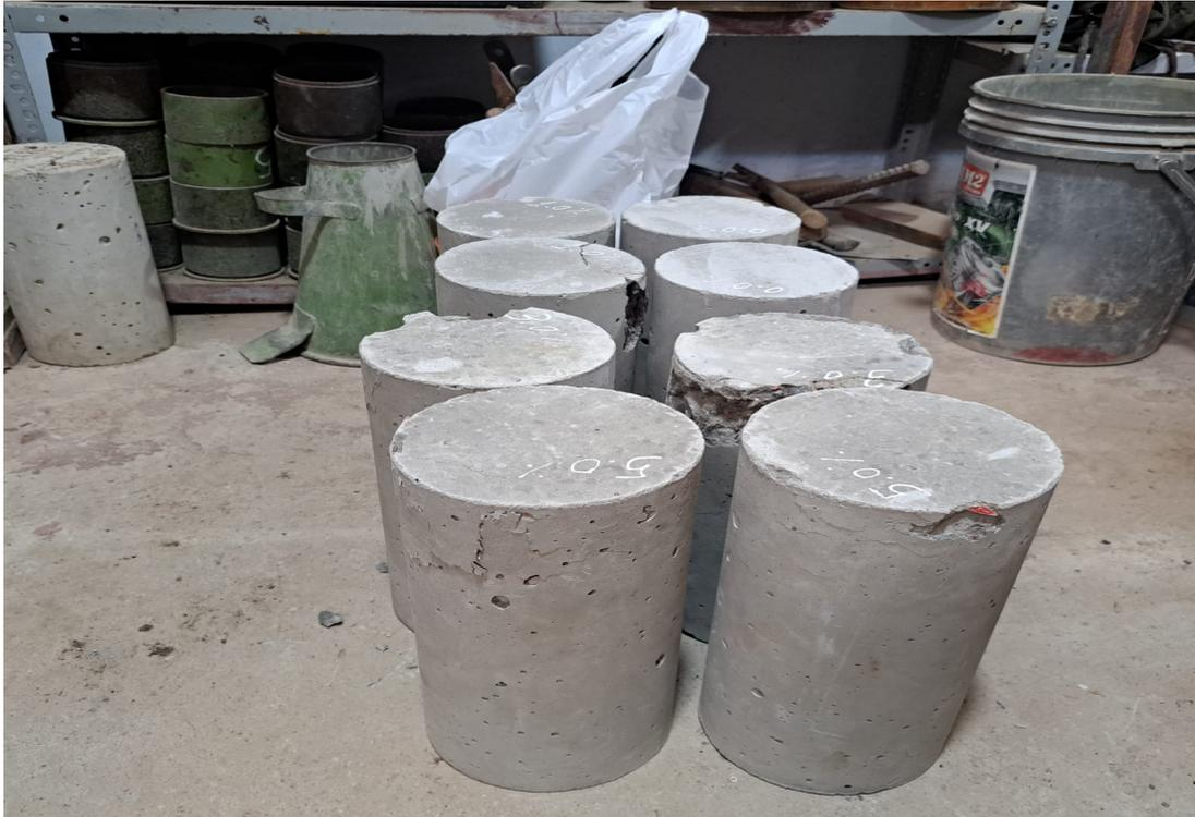
**Anexo 8.12:** Ensayo de roturas de boquetes de concreto 7 días
