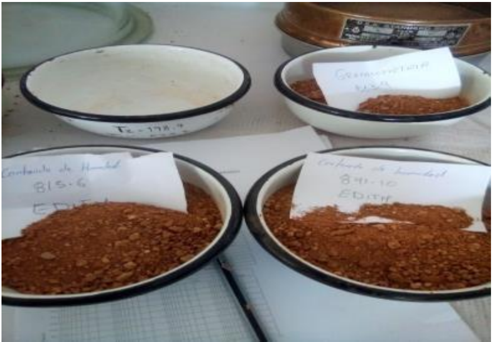
Figura 5: Muestra para el ensayo de análisis granulométrico y contenido de humedad
