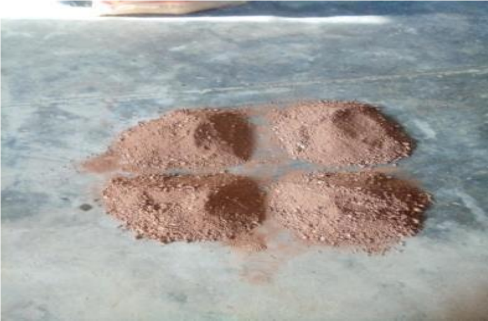
Figura 4: Cuarteo de la muestra
