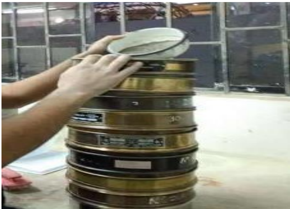
Figura 7: Tamizado de material seco
