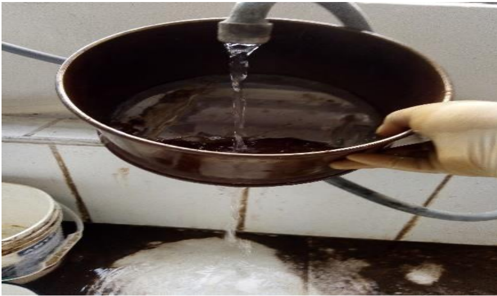
Figura 6: Lavado de la muestra para granulometría
