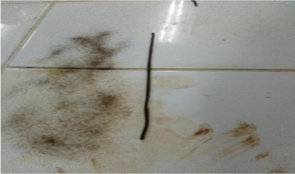
Figura 11: Barra de acero para ensayo de limite plástico
