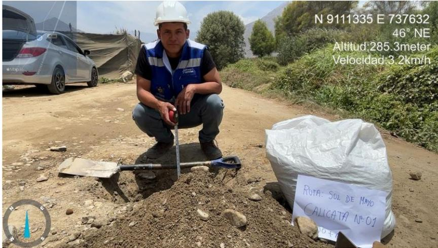
**DESCRIPCIÓN** : Se extrajo el material necesario de la subrasante en la ruta, para los análisis requeridos en los ensayos de laboratorio; calicata N°1.
