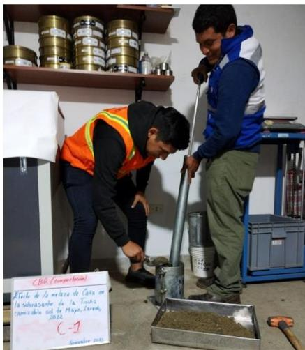
**DESCRIPCIÓN** : Se realizó el ensayo de CBR (compactación) con la finalidad de medir la capacidad portante del suelo en la subrasante de la trocha carrozable Sol de Mayo.
