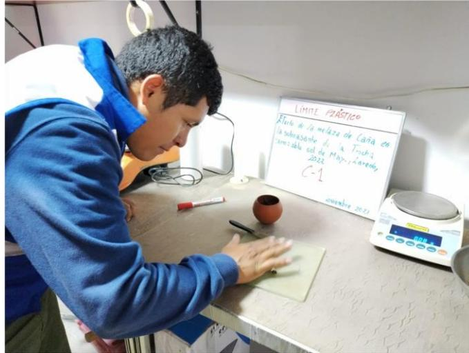
**DESCRIPCIÓN** : Se realizó el ensayo de límite líquido con la finalidad de analizar el porcentaje de humedad en la subrasante de la trocha carrozable Sol de Mayo.
