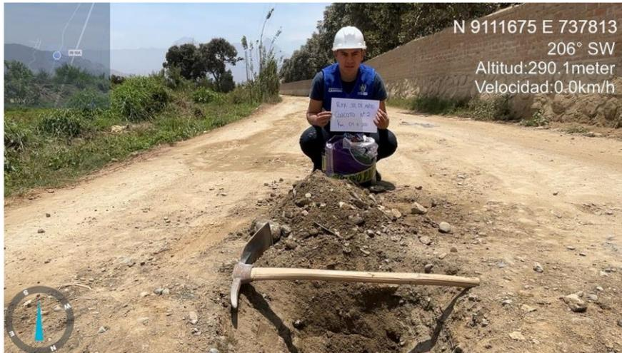
**DESCRIPCIÓN** : Se extrajo el material necesario de la subrasante en la ruta, para los análisis requeridos en los ensayos de laboratorio; calicata N°2.
