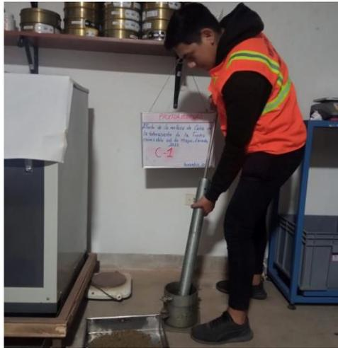
**DESCRIPCIÓN** : Se realizó el ensayo de Proctor modificado con la finalidad de analizar el porcentaje de humedad óptima y la máxima densidad seca en la subrasante de la trocha carrozable Sol de Mayo.
