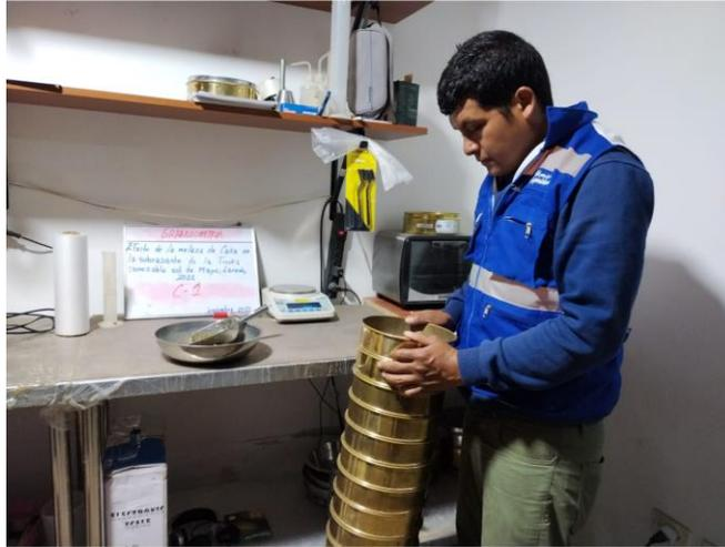
**DESCRIPCIÓN** : Se realizó el ensayo de granulometría con la finalidad de analizar el tipo de suelo en la subrasante de la trocha carrozable Sol de Mayo.
