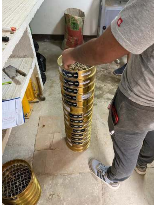
Ensayo de Granulometría por Tamizado
