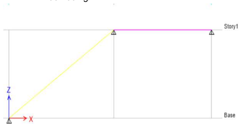
Figura 35: Modelamiento de escalera.
