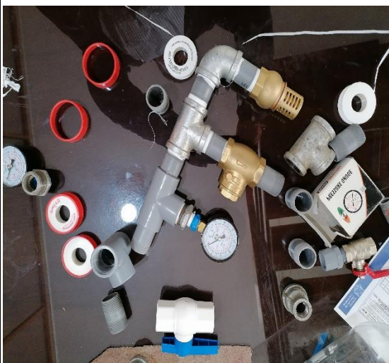
Imagen 4. Se observa parte del ensamblaje de la bomba de ariete.
