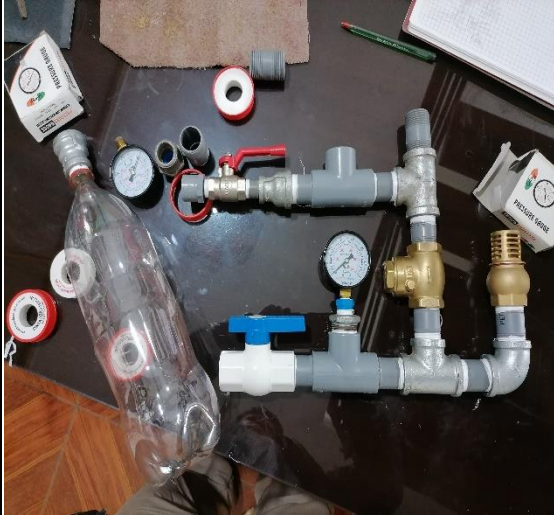
Imagen 1. Ensamblado de las válvulas y llaves de entrada y salida.
