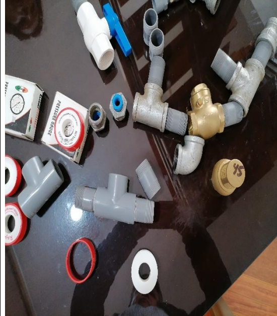
Imagen 2. válvula de compuerta, tés, niples, cinta teflón.
