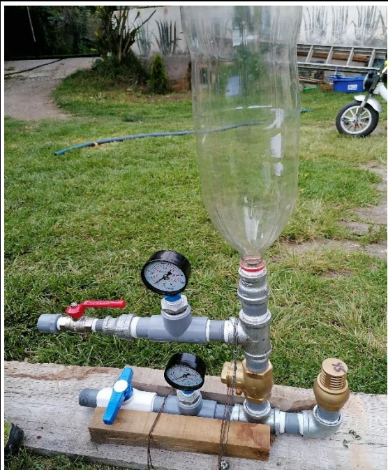
Imagen 4. Base y disposición de la bomba de ariete.
