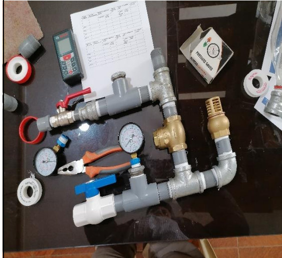
Imagen 2. Ensamblado de la bomba de ariete.
