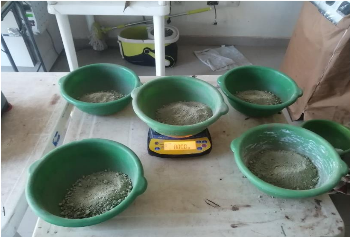
FIGURA 21 Preparación de muestras de suelo seco
