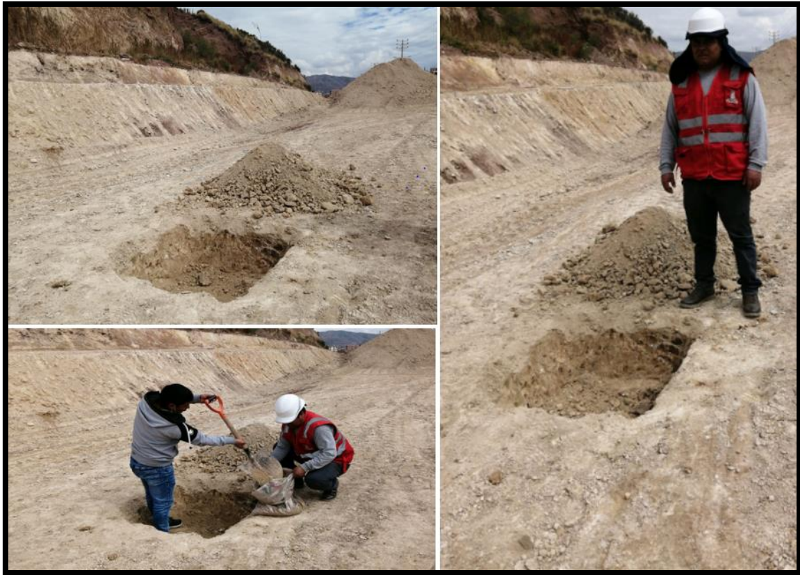
FIGURA 12 Calicata y obtención de muestra en Situ
