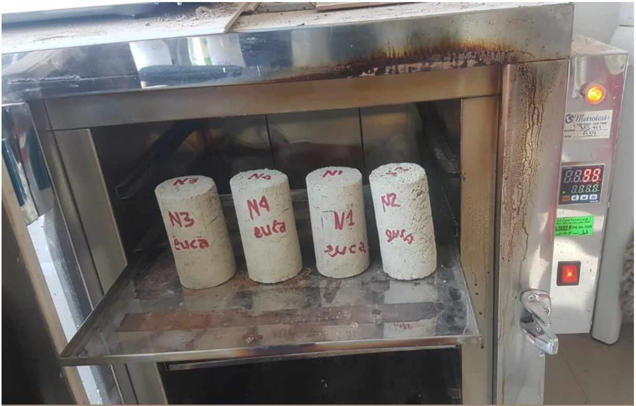
FIGURA 27 Probetas compactadas en el Horno
