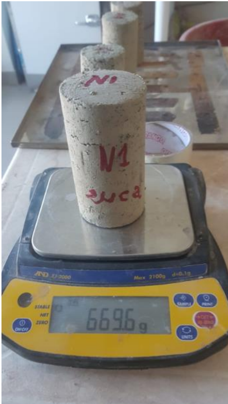
FIGURA 28 Peso de la probeta 01 compactada
