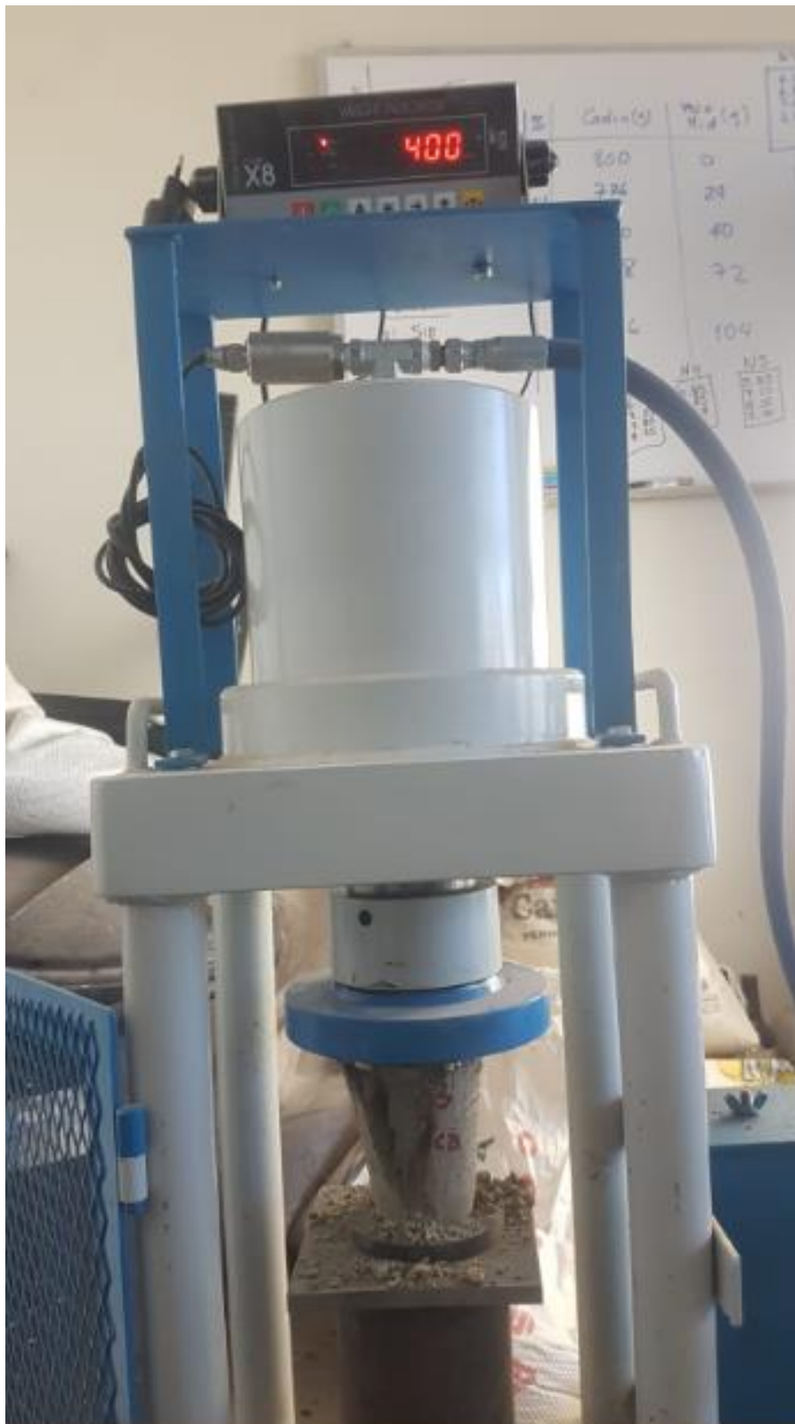
FIGURA 34 resistencia a la compresión de la probeta con 4% de tanino
