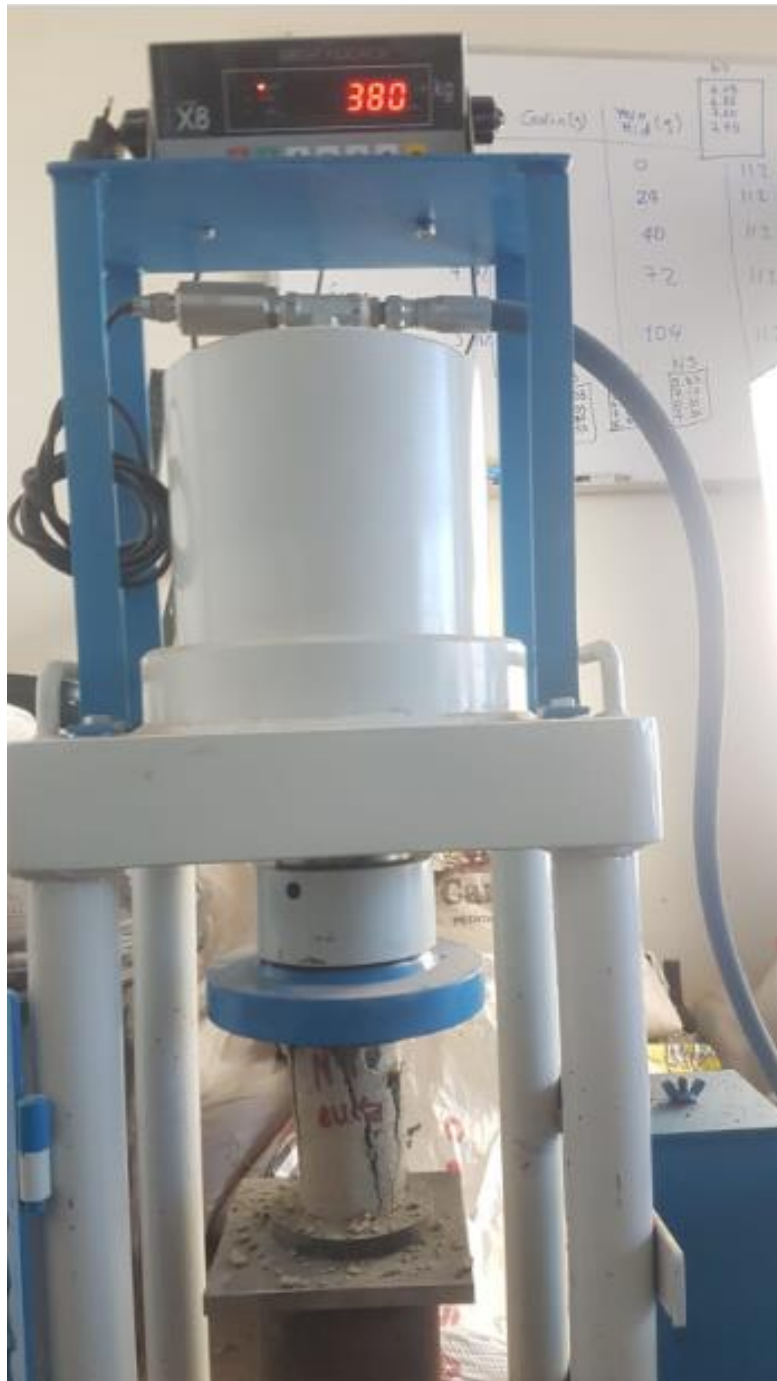
FIGURA 35 resistencia a la compresión de la probeta sin contenido de Tanino
