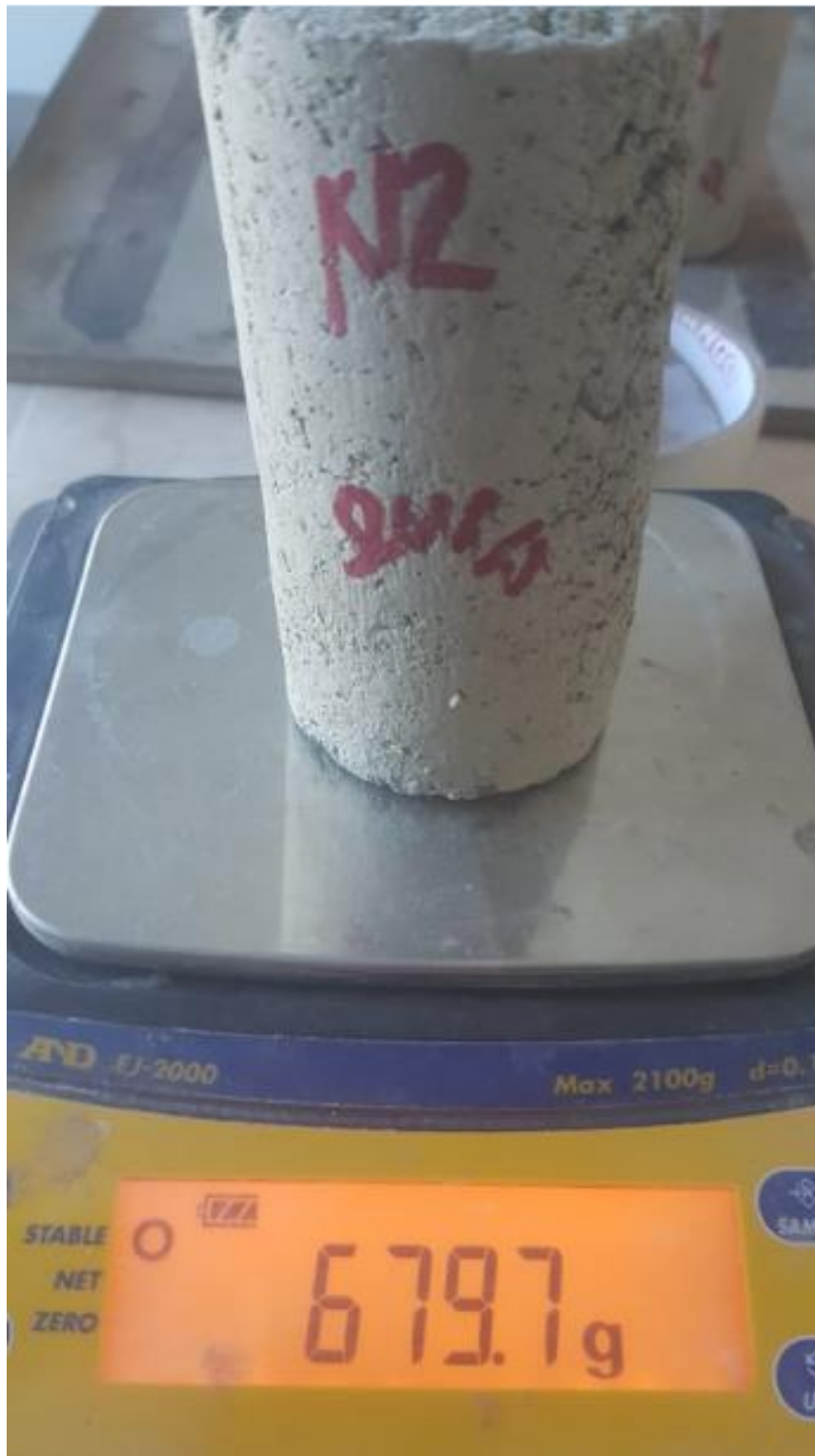
FIGURA 29 Peso de la probeta 02 compactada
