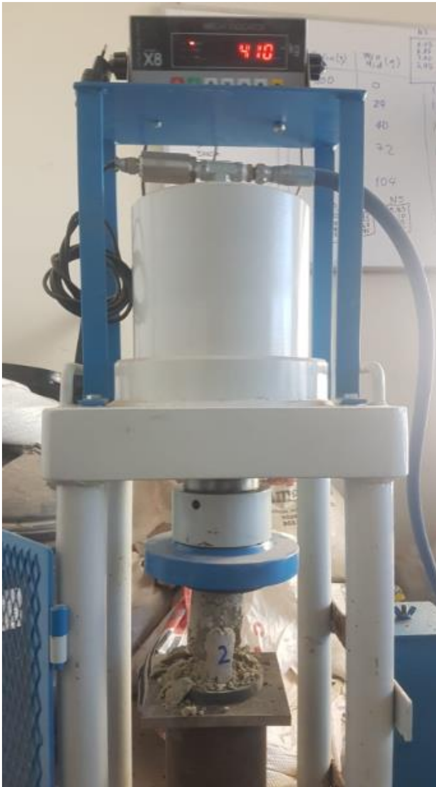
FIGURA 33 resistencia a la compresión de la probeta con 8% de tanino
