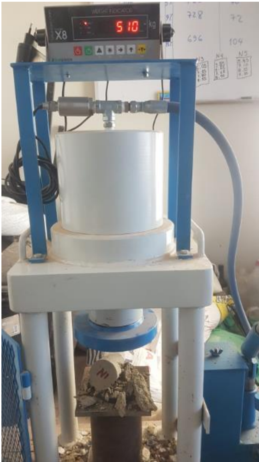
FIGURA 32 Resistencia a la compresión de la probeta con 16% de Tanino
