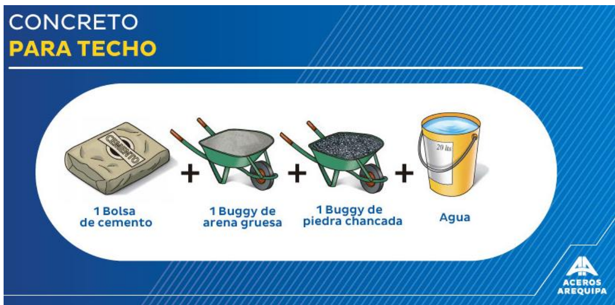
Figura 19: Dosificación del concreto para techo
