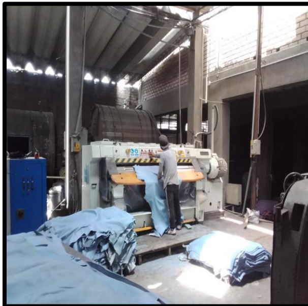
ANEXO 17 Personal sin EPP en máquina de vapor
