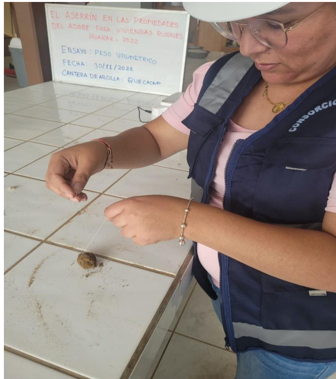
Figura 9. Ensayo de peso volumétrico 2.
