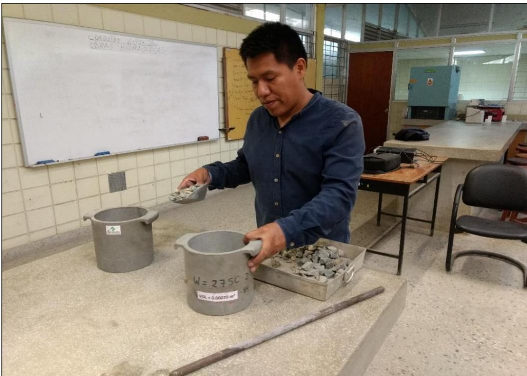
Figura 42. Prueba del peso volumétrico del agregado fino.
