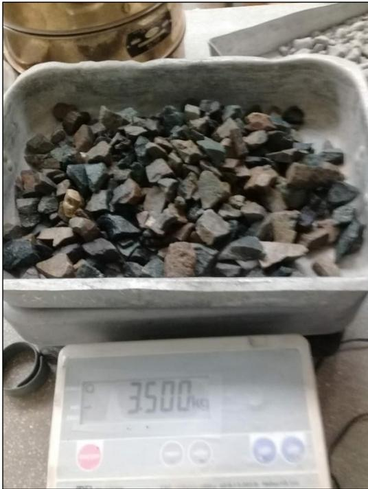
Figura 40. Superficie seca de la muestra.
