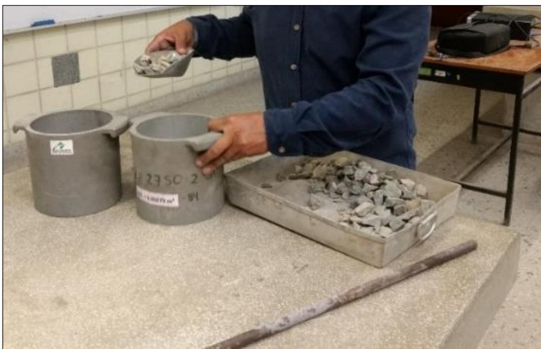
*Figura 19.* Elaboración de la determinación del peso unitario del agregado.
