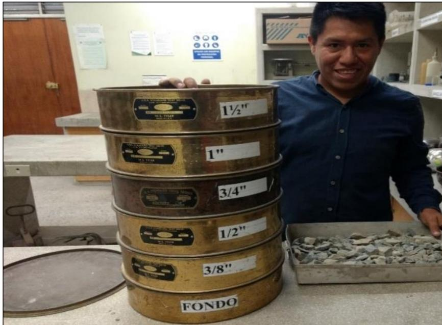
Figura 17. Tamizado para el agregado grueso.
