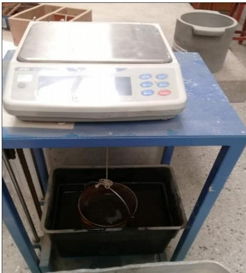
*Figura 18.* El % de absorción y Peso específico del agregado grueso.
