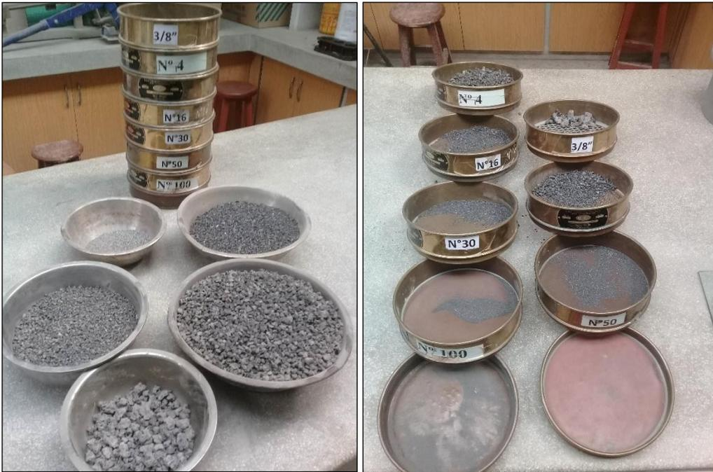
Figura 36. Prueba granulométrica de la escoria de acero.
