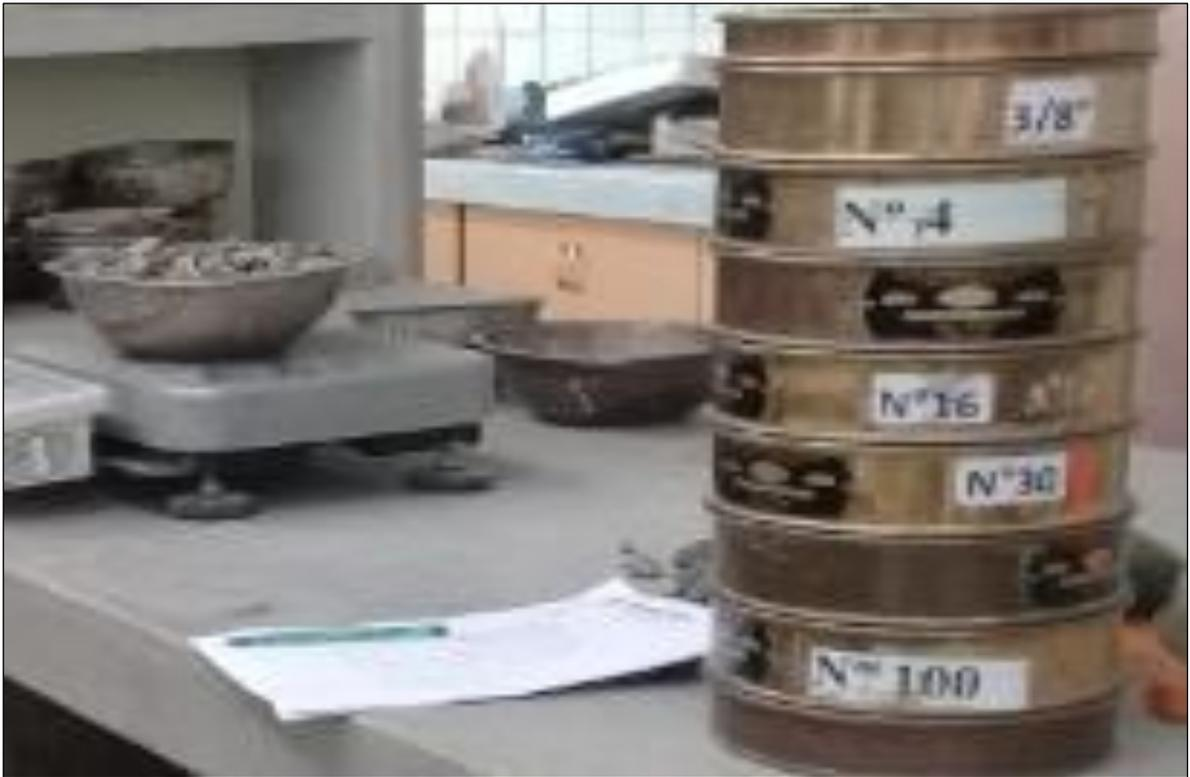
*Figura 15. Tamizado del agregado fino.*
