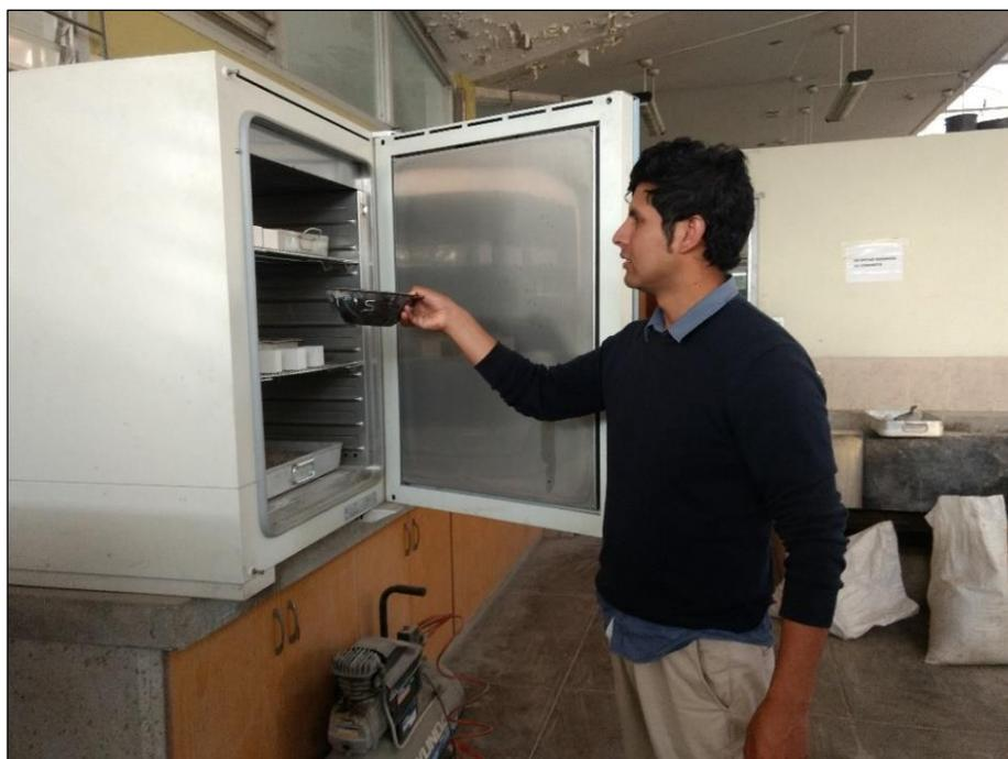
*Figura 43.* Prueba del contenido de humedad - retirando la muestra de horno.
