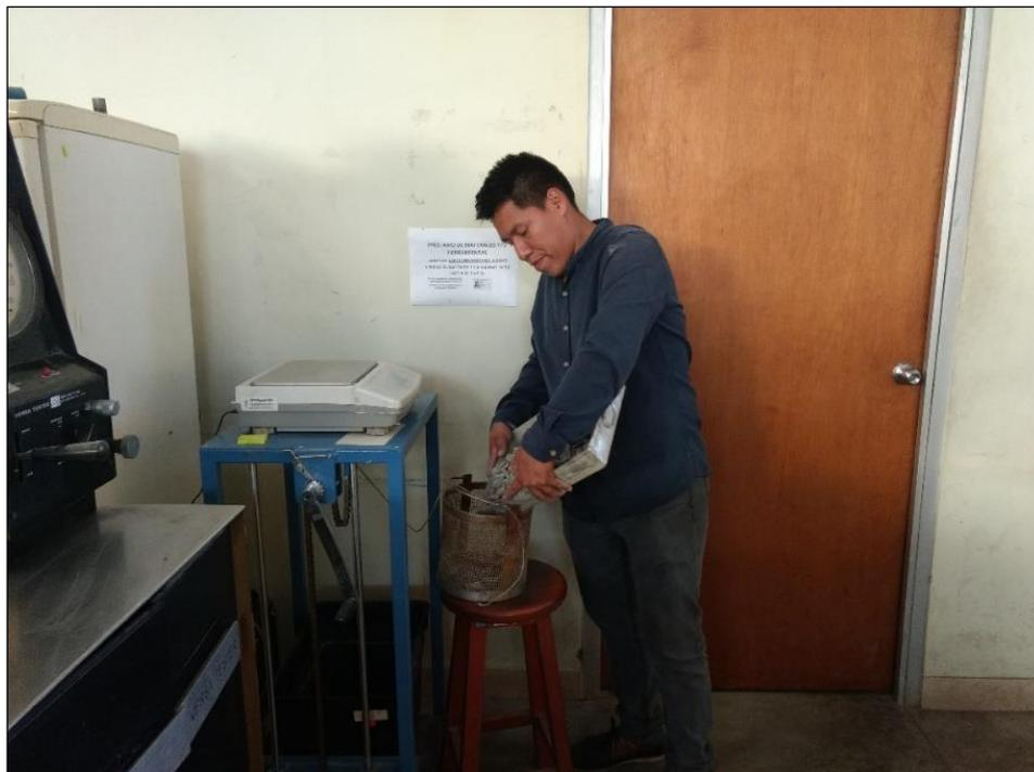
*Figura 39.* Determinando el peso de la muestra en el agua.
