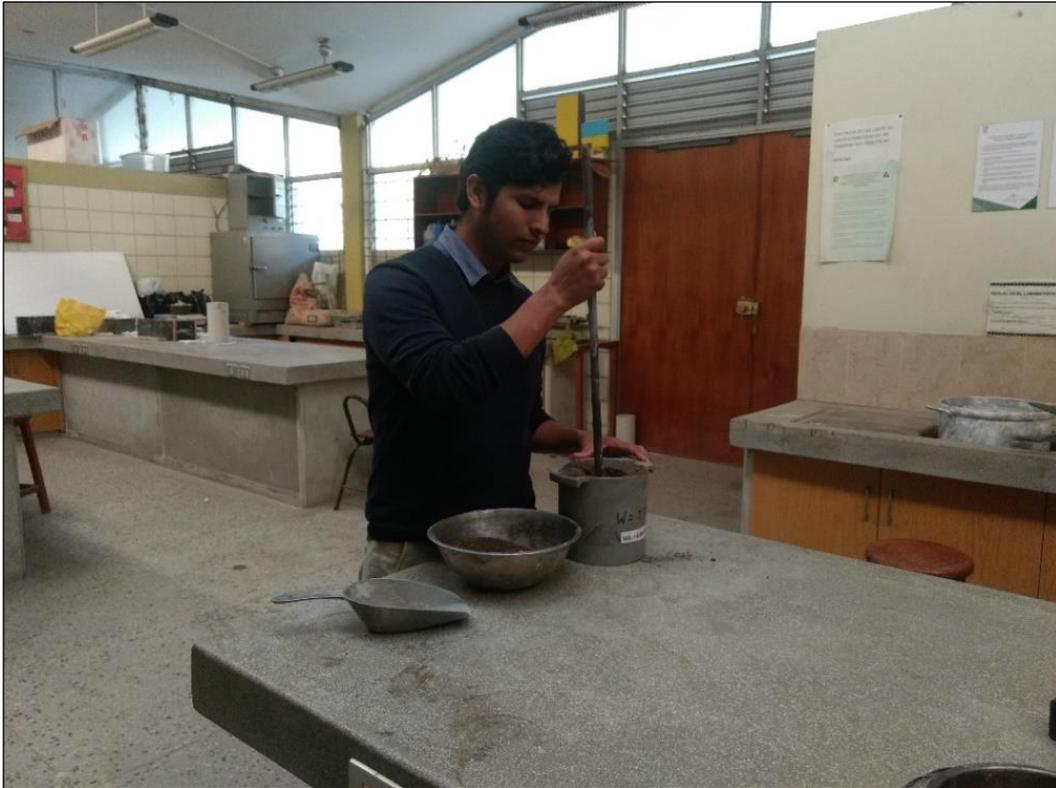
Figura 41. Prueba del peso volumétrico del agregado fino.
