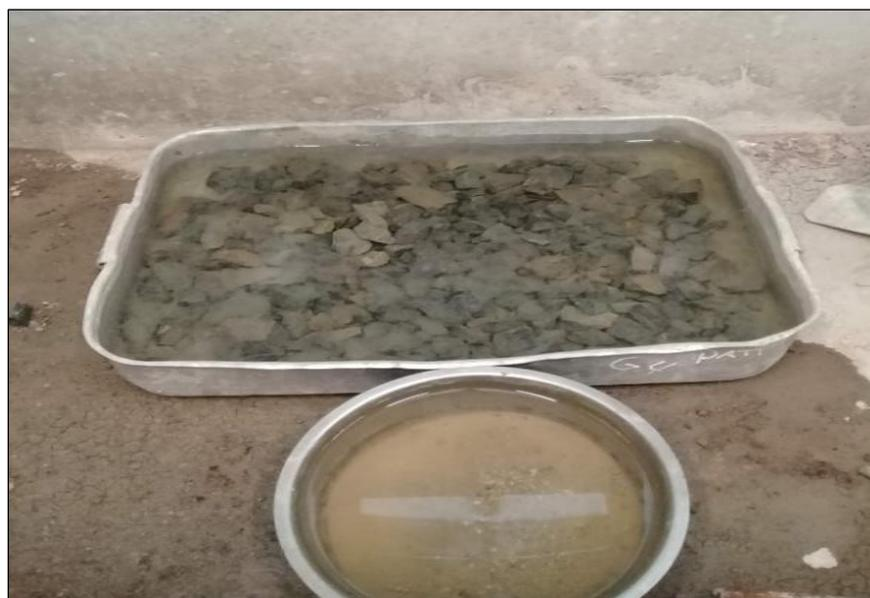
*Figura 37. Saturación del agregado por 24 horas.*
