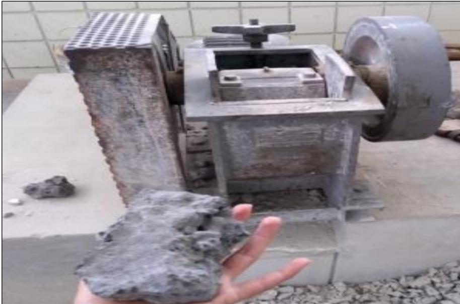
*Figura 23.* Triturado de la escoria para la obtención de agregados finos.
