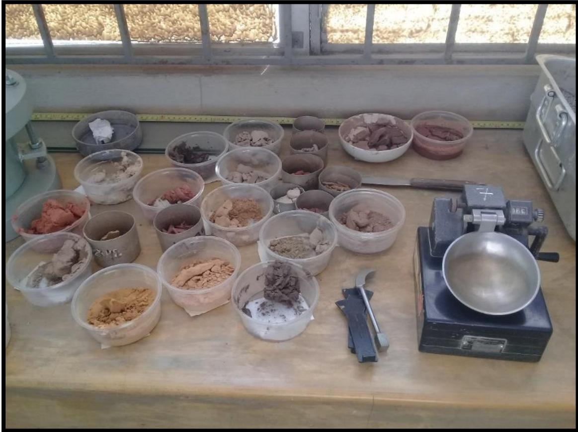
Prueba para determinar el índice P. y Limite L.
